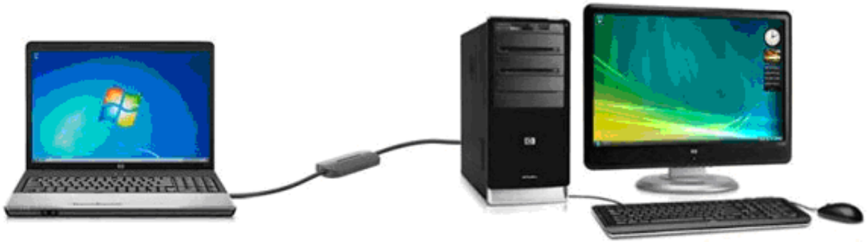
Рис.8. Непосредственное соединение ноутбука с Windows 7 и настольного ПК с Windows XP сетевым перекрёстным Ethernet кабелем (crossover cable) по схеме «точка-точка» для создания LAN (локальной вычислительной сети), точнее рабочей группы.
