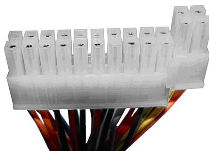
Рис.5. 24-контактный ATX-разъём, у которого последние 4 контакта могут быть съёмными, для обеспечения совместимости с 20-контактным гнездом на системной плате
