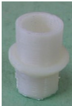
Рис. 43. Напечатанная деталь держатель для пера плоттера Rolland DXY.
