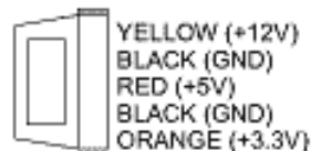
Рис.9. Разъем питания SATA устройств
