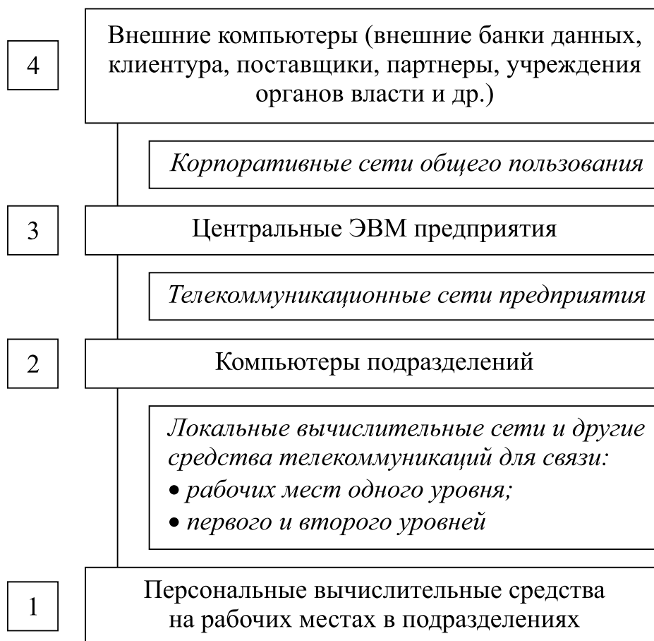
Рис. 7.1 – Типовое распределение вычислительных средств и сетей по уровням
