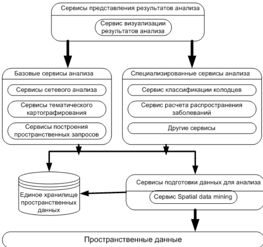
Рис. 4.13. Сервис-ориентированная архитектура блока анализа веб-ориентированной ГИС
