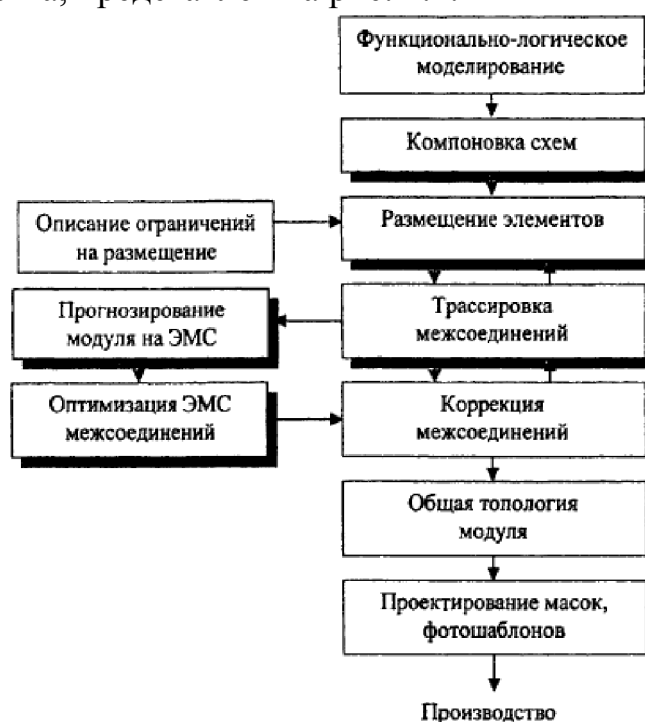
Рисунок 1.2 – Процесс проектирования электронного средства с учетом ЭМС
