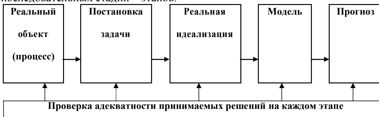
Рисунок 1.1 – Структура алгоритма моделирования ЭМС ТС
