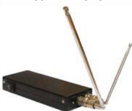
Рис. 6.11. Генератор шума SEL SP-21 «Баррикада»
