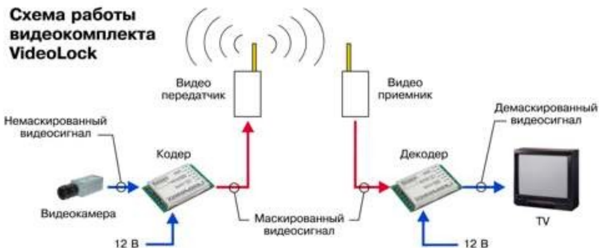
Рис. 3.30. Схема включения комплекса в состав системы видеонаблюдения
