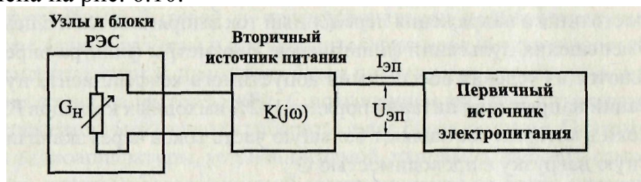
Рис. 6.10. Модель цепи электропитания
