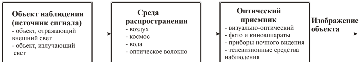
Рис. 3.1. Структура оптического канала утечки информации
