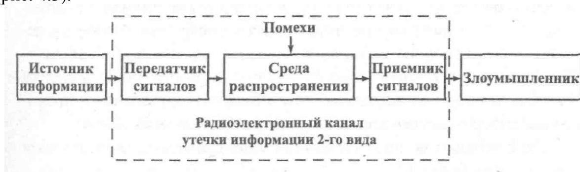
Рис. 4.3. Радиоэлектронный канал утечки 2-го вида
