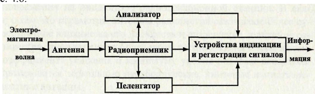
Рис. 4.6. Комплекс средств перехвата радиосигналов
