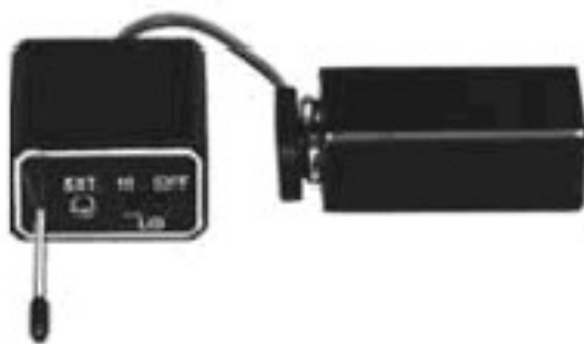
а) Акустическая радиозакладка с FM-модуляцией РК-805-SS с источником питания
