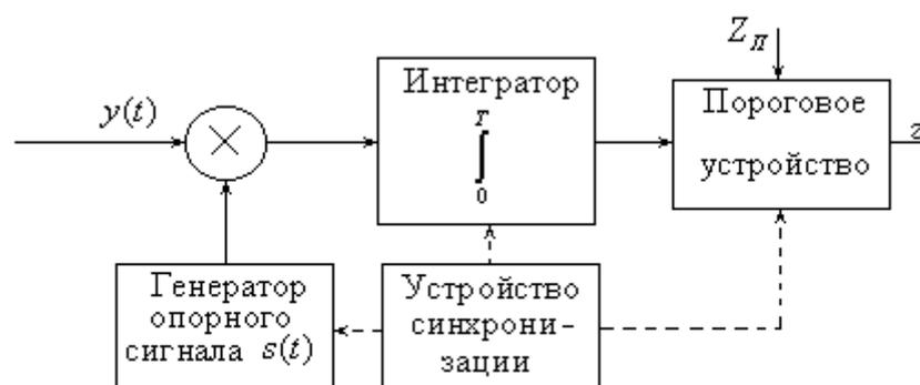
Рис. 1. Приемник – обнаружитель корреляционного типа
