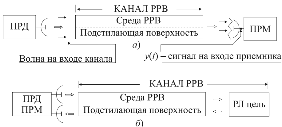
Рис. 2.1 — Структура типичных радиоканалов: а) для РТС передачи информации; б) для измерительных РТС. ПРД — передатчик; ПРМ — приемник
