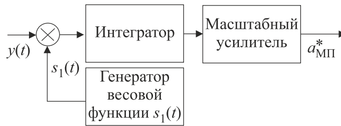
Рис. 4.6 – Структура оптимального измерителя амплитуды полностью известного радиоимпульса
