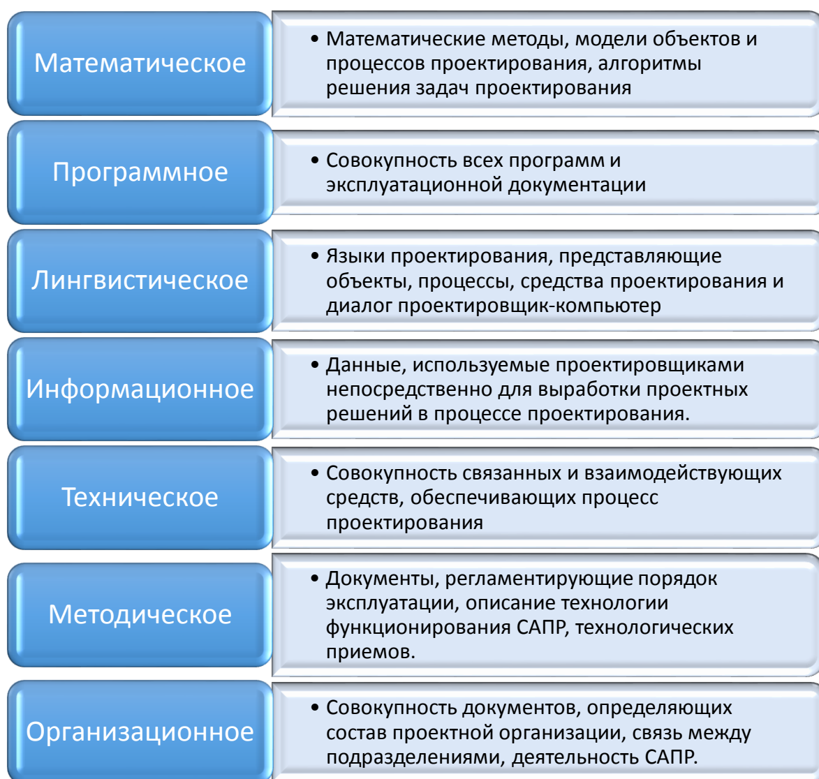
Рис. 3.2 - Типовые подсистемы (обеспечения) САПР
