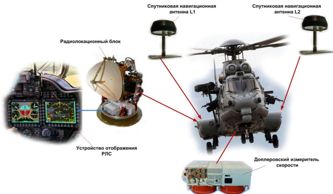
Рис. 2.3 – Подсистемы комплекса радиолокационной разведки наземных и воздушных целей «АБАК-РЛС1М для ВВС Казахстана» [59]
