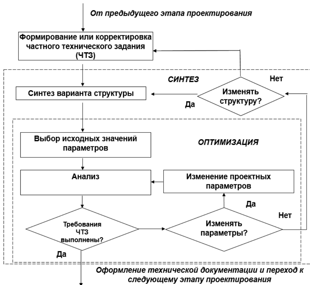
Рис. 2.2 - Схема типового алгоритма проектирования
