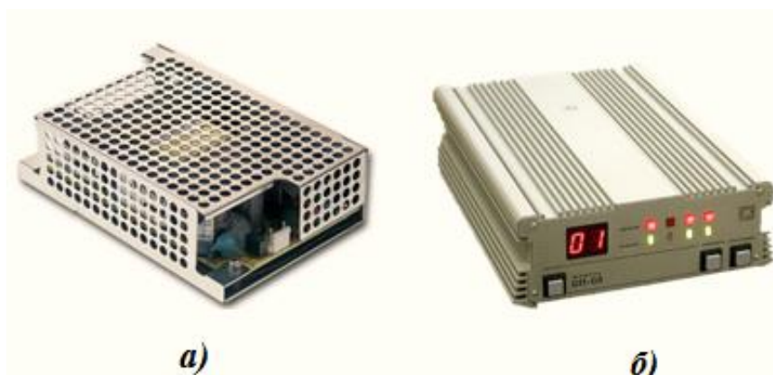
Рис. 2.8 - Виды корпусов РЭС с интенсивным тепловыделением: а) - с перфорацией стенок; б) - с оребрением стенок
