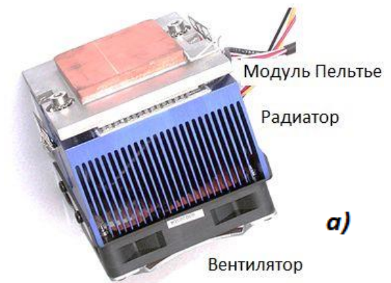
Рис. 2.11 - Устройство и внешний вид термоэлектрических модулей (элементов Пельтье), которые позволяют получить разность температур до 74–76 К
