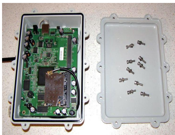
Рис. 2.13 - Для исключения проникновения внутрь влаги между половинками герметичного алюминиевого корпуса установлена резиновая прокладка.
