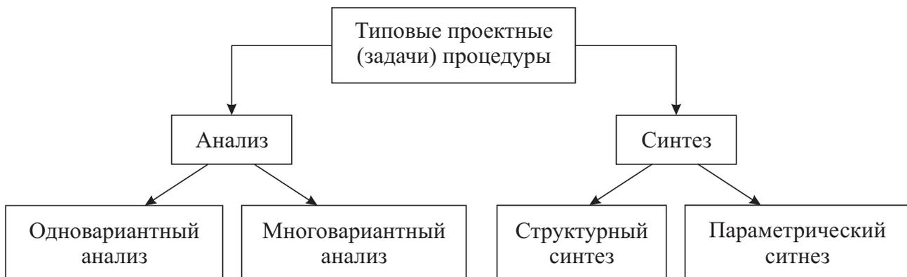
Рис. 3.1 – Классификация типовых проектных процедур
