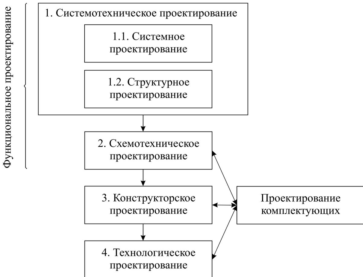
Рис. 1.6 – Этапы проектирования РЭС (блок-схема)
