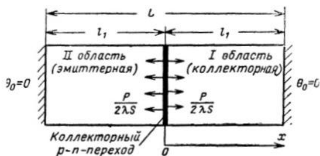
Рисунок. 2. Симметричная теплофизическая модель сплавного транзистора (по Мартенсону)
