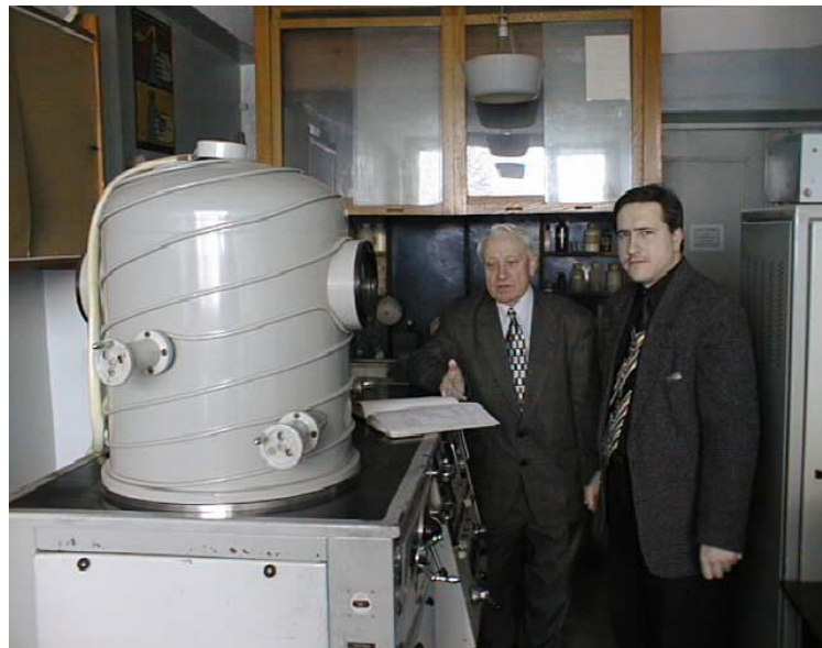
б) напылительная установка УВН-2М1
