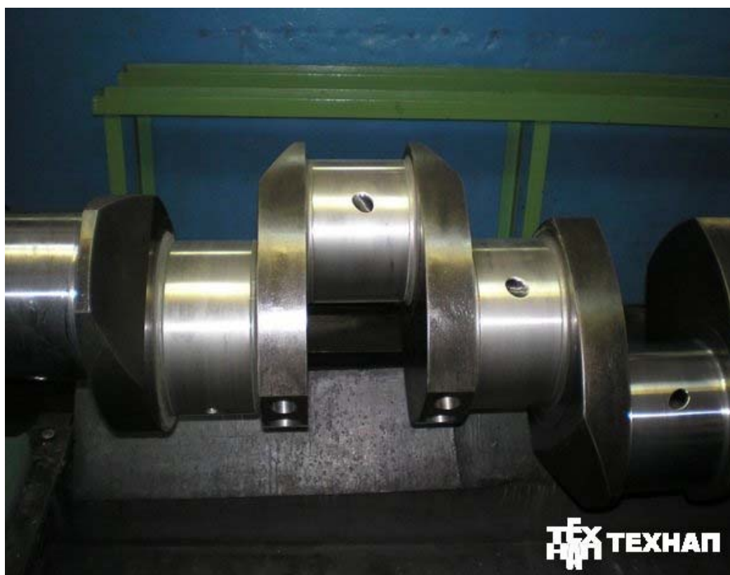
Рис.4.17. Газотермическое напыление. Покрытие после мехобработки.
