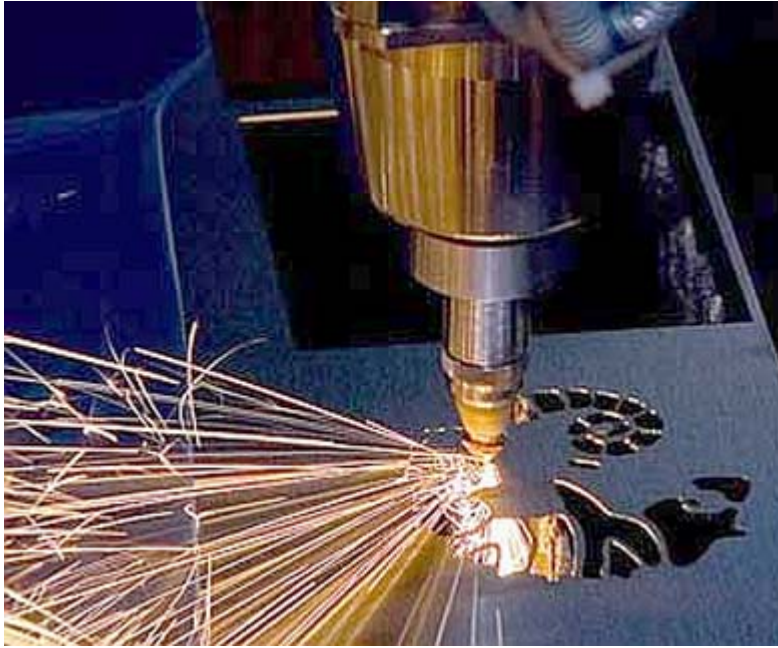
Рис.4.12. Высокотехнологичная обработка металлов: лазерная резка.
