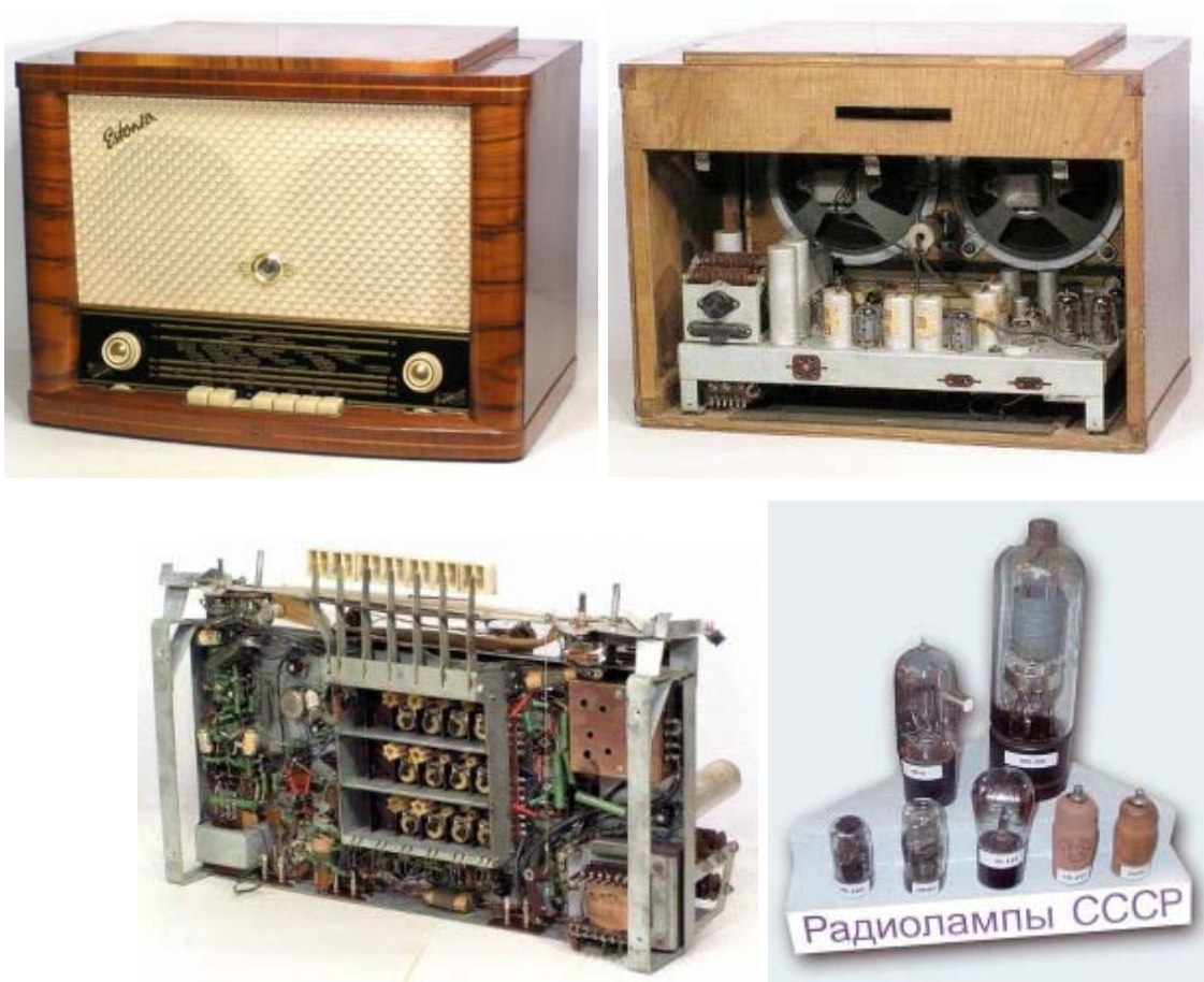
Рис.6.1. Пример аппаратуры I этапа. Ламповая радиола «Эстония», пример шасси из дюралюминия и навесного монтажа радиоэлементов. Отечественные электронные лампы различного назначения: внешний вид и размеры.
