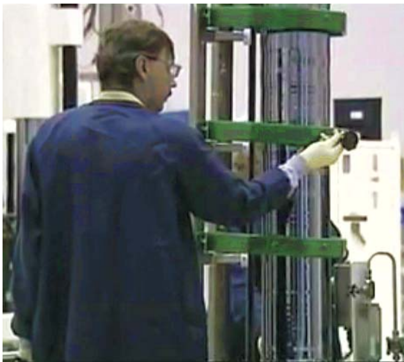
Рис.6.8. Метод Чохральского, спуск и извлечение выращенного кристалла
