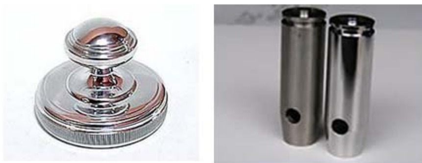
Рис. 4.10. Примеры электрохимического полирования стальных деталей.
