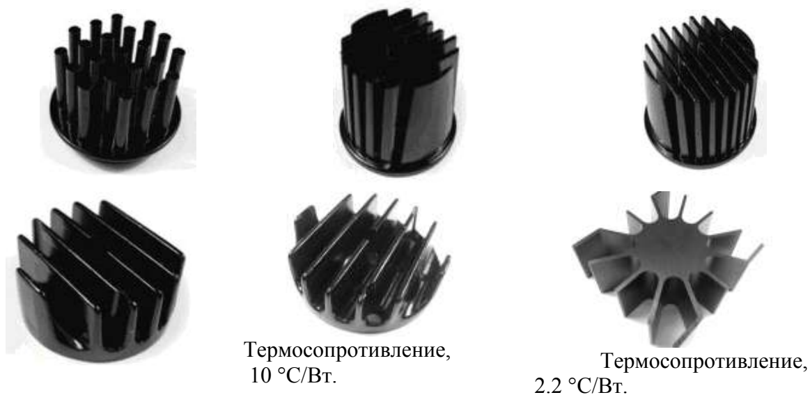
Рисунок 1– Специализированные радиаторы для мощных светодиодов компании LUSTROUS Corp. (Тайвань)
