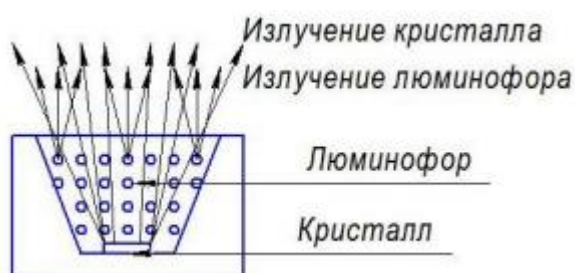
Рисунок 1. Процесс формирования излучения СД с кристаллом синего свечения и люминофором
