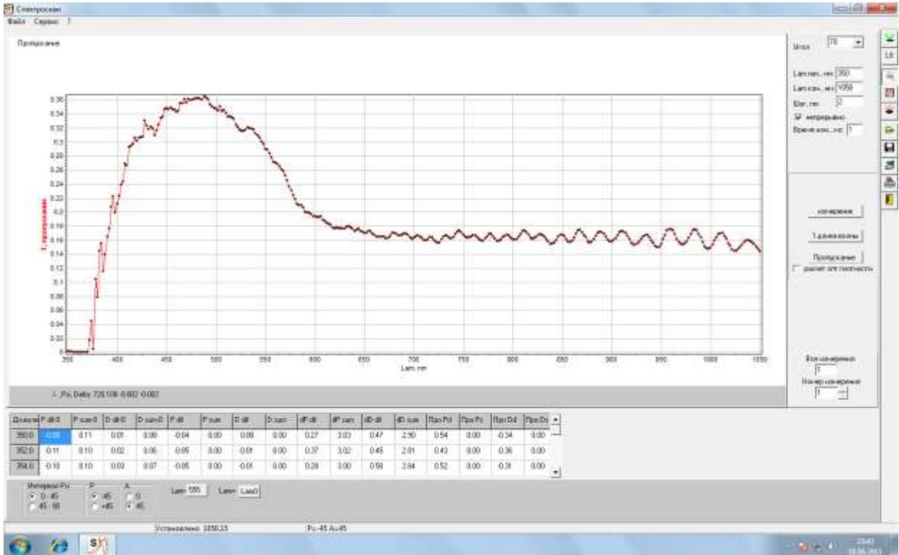
Рисунок 1.26 - Спектр отражения исходной гетероструктуры на GaN (толщина сапфировой подложки 400 мкм)
