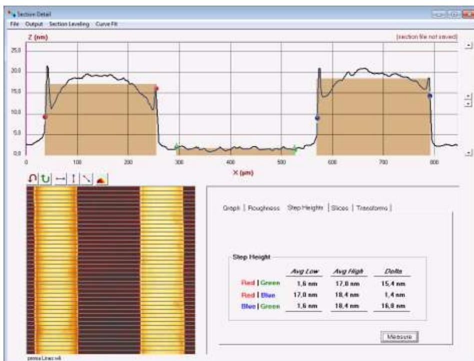
Рис. 3.11. Профилограмма пленок (линии), полученных печатью раствором PMMA
