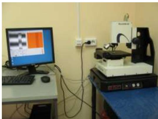
Рис.3.3. Профилометр KLA-Tencor MicroXAM 100
