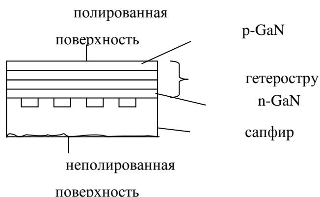
Рисунок 1.25 – Схематическое изображение гетероструктуры
