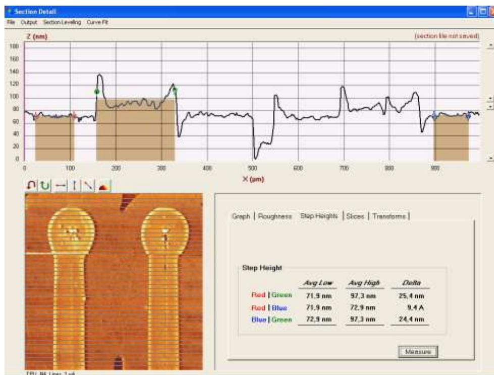
Рис. 3.10. Профилограмма пленок одиночных линий PF8 (модифицированный раствор)
