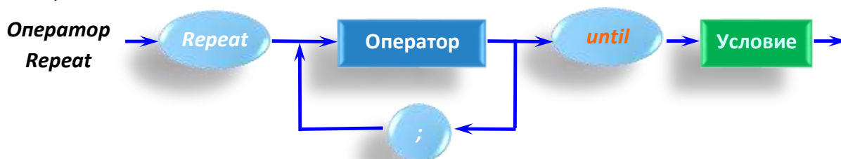
Рис. 5.12 - Синтаксическая диаграмма оператора цикла Repeat
