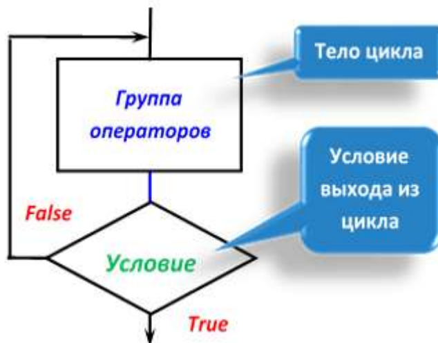
Рис. 5.13 - Цикл с послеусловием «До выполнения условия»
