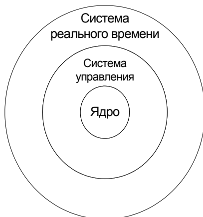
Рис. 3.9. Типичное строение ОСРВ
