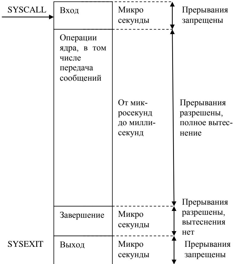
Рис. 6.2. Механизм вытеснения в ОС QNX
