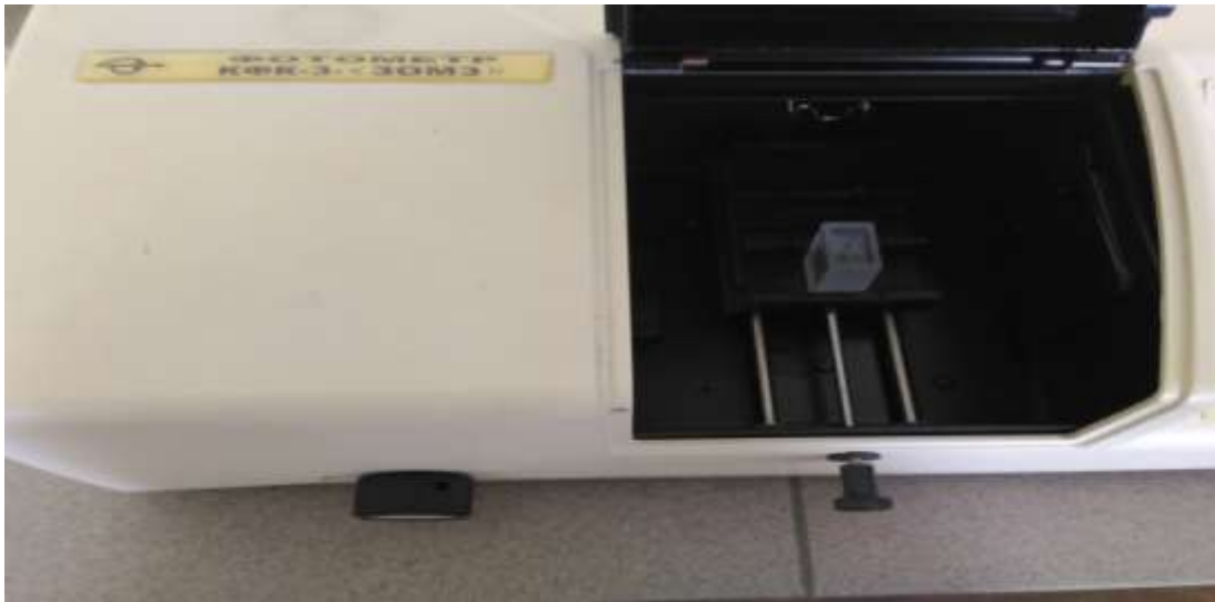
Рисунок 4 - Фотоколориметр КФК-3-"30МЗ" с установленным для измерения образцом
