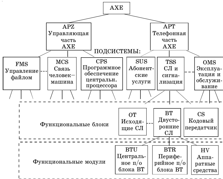
Рис. 6.35 — Структура системы АХЕ-10
