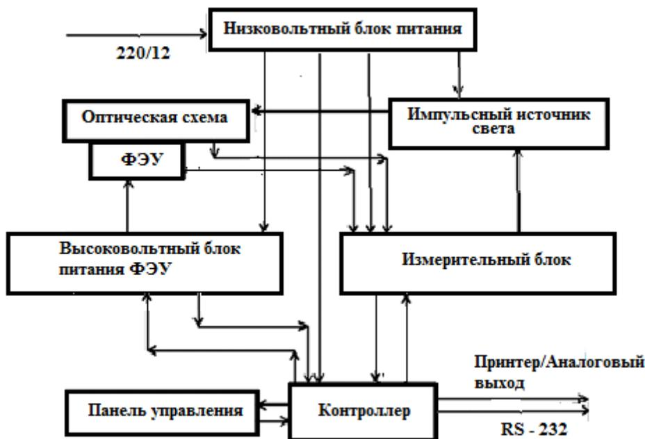
Рисунок 5.7 - Структурная схема анализатора Флюорат-02-2М
