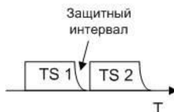
Рисунок 2.2 – Защитные интервалы в цикле TDMA
