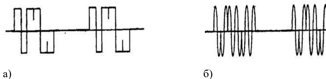
Рисунок 3 — Кодированные сигналы на основе видеоимпульсов (а) и однопериодных радиоимпульсов (б)
