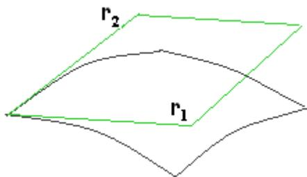
$r_1$  направлен по касательной в сечении, параллельном оси  $Ox$ , то есть тангенс угла наклона для него это  $f'_x(x, y)$ . Тогда его координаты:  $(\Delta x, 0, \Delta x \cdot f'_x) = \Delta x(1, 0, f'_x)$ . Аналогично вектор  $r_2$  расположен в сечении вдоль оси  $Oy$ , его координаты  $(0, \Delta y, \Delta y \cdot f'_y)$ , если вынести дельта, то это  $\Delta y(0, 1, f'_y)$ . Площадь параллелограмма вычисляется с
