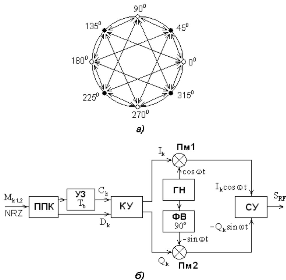
Рис. 22. Фазовая диаграмма  $\pi/4$  DQPSK-радиосигнала (а);
