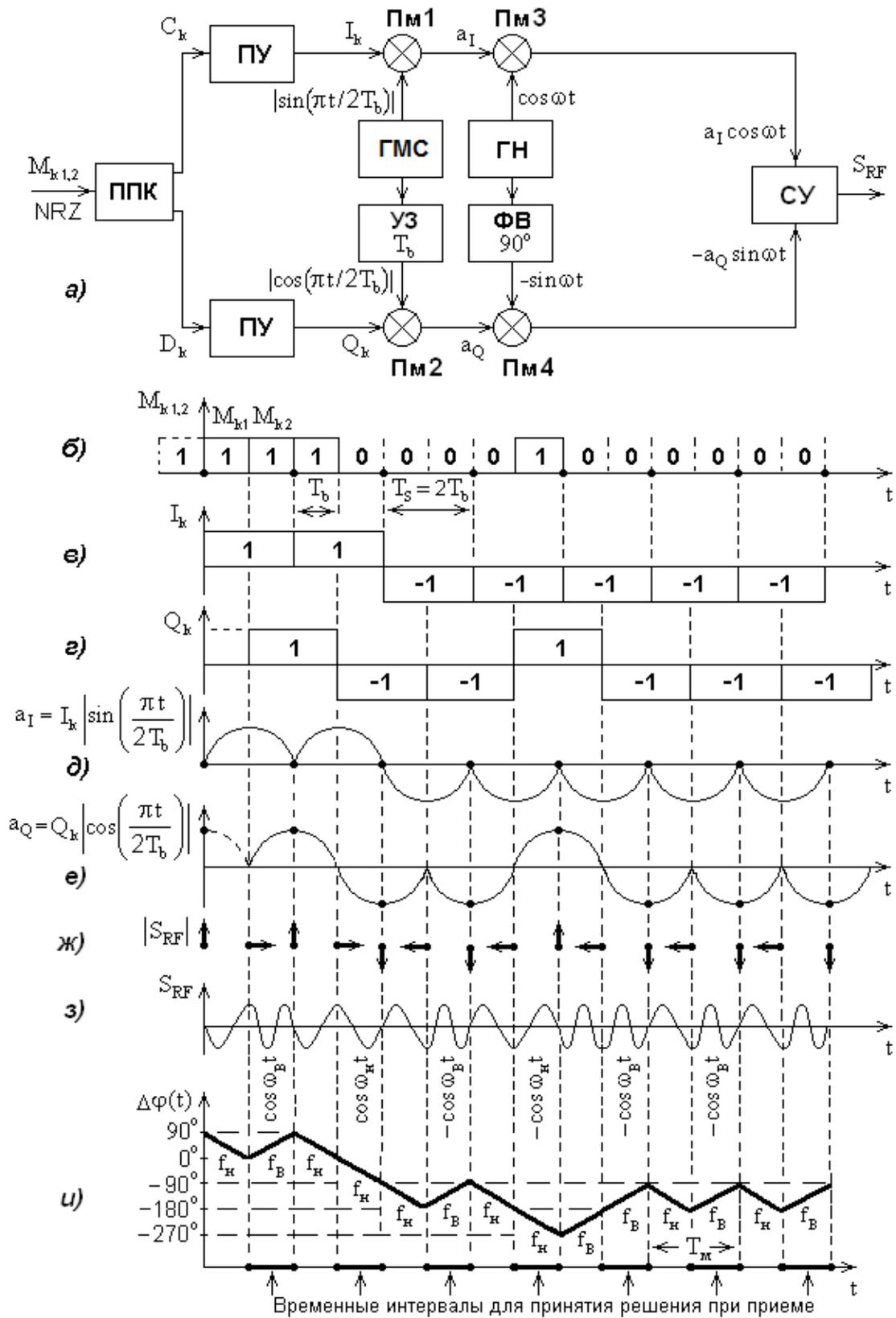
Рис. 24. Структурная схема MSK-модулятора (а);
