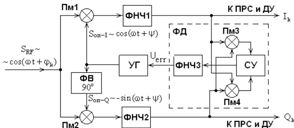
Рис. 20. Структурная схема Костаса для демодуляции DQPSK-радиосигнала
