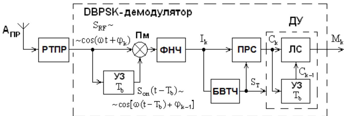
Рис. 10. Структурная схема некогерентного автокорреляционного DBPSK-демодулятора (некогерентного демодулятора с задержкой высокочастотного сигнала)
