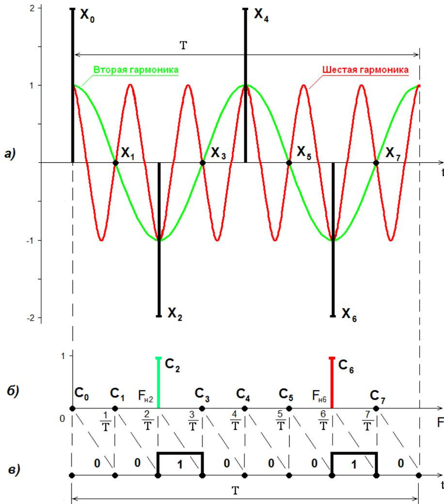
Рис. 37. Дискретный сигнал на временном интервале  $T$  и соответствующие ему гармонические колебания (а); представление дискретного сигнала в частотной области (б); символическая последовательность  $(0\ 0\ 1\ 0\ 0\ 0\ 1\ 0)$  на временном интервале  $T$  (в), дающая при обратном преобразовании Фурье дискретные отсчеты  $X_0, \dots, X_7$
