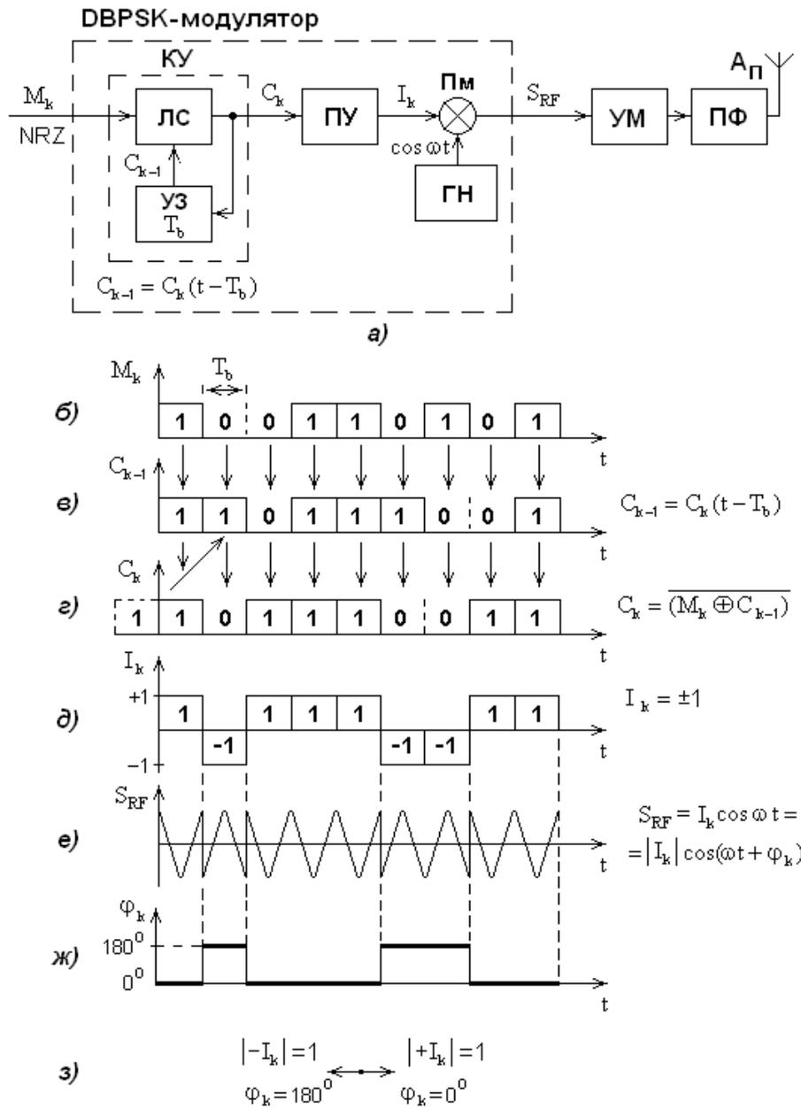
Рис. 1. Структурная схема DBPSK-передатчика (а); цифровые потоки  $M_k$  (б),  $C_{k-1}$  (в),  $C_k$  (г),  $I_k$  (д); DBPSK-радиосигнал  $S_{RF}$  (е); фаза  $\varphi_k$  колебания несущей частоты на выходе DBPSK-модулятора (ж); сигнальное созвездие, т.е. возможные положения вектора DBPSK-радиосигнала (з)
