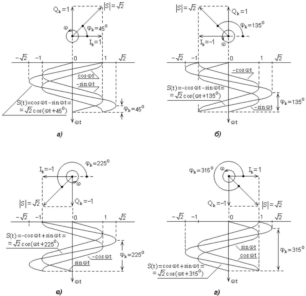
Рис. 14. Векторные диаграммы и осциллограммы, поясняющие образование QPSK-радиосигнала  $S(t)$  при  $\varphi_k = 45^\circ$  (а),  $\varphi_k = 135^\circ$  (б),  $\varphi_k = 225^\circ$  (в),  $\varphi_k = 315^\circ$  (г)
