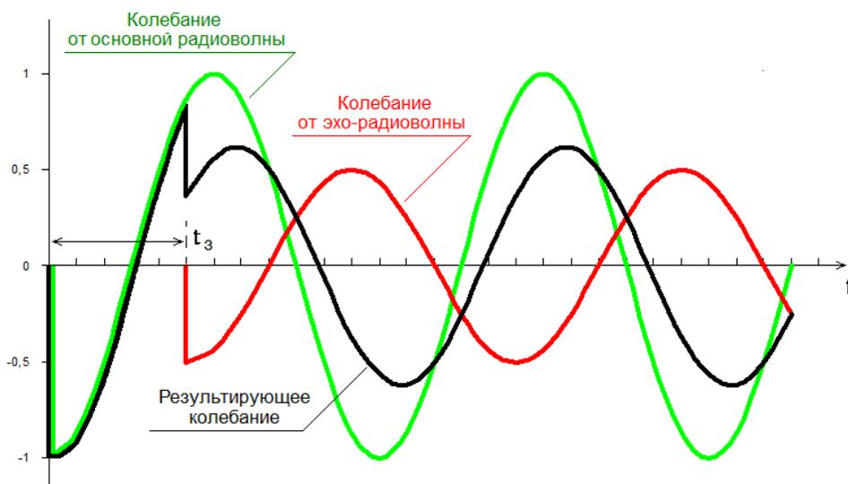
Рис. 33. Осциллограммы колебаний ВЧ на входе приемника:
