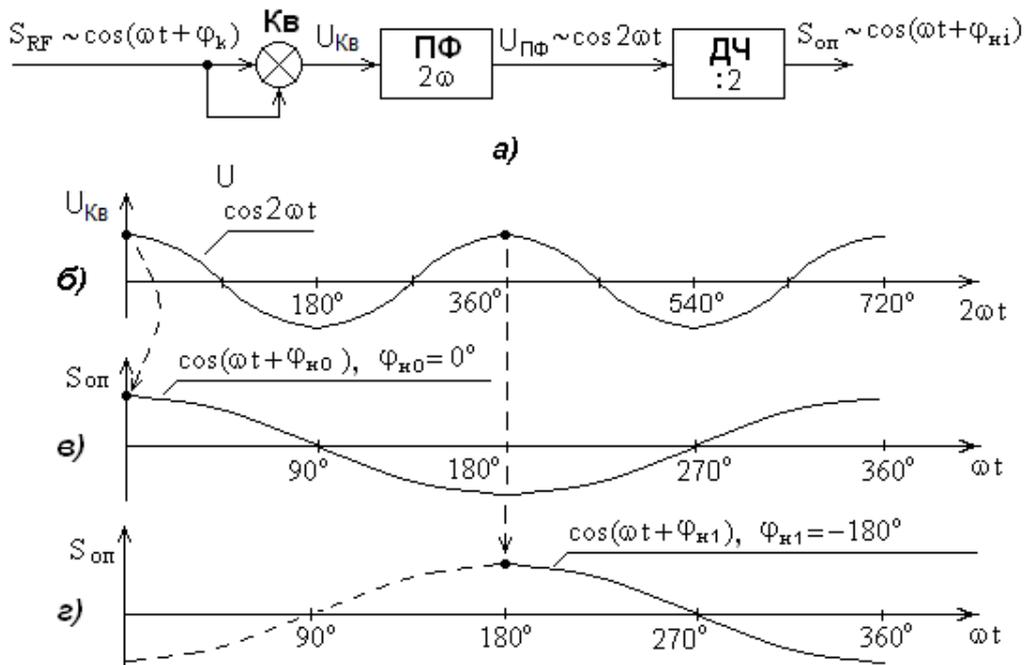
Рис. 6. Структурная схема БВНЧ (а);
