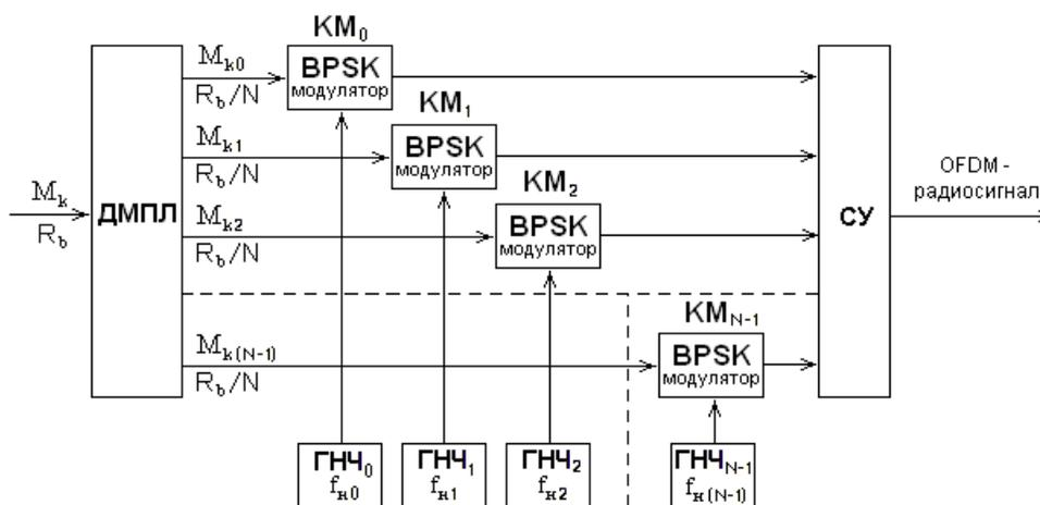
Рис. 28. Структурная схема OFDM-формирователя, иллюстрирующая принцип получения OFDM-радиосигнала
