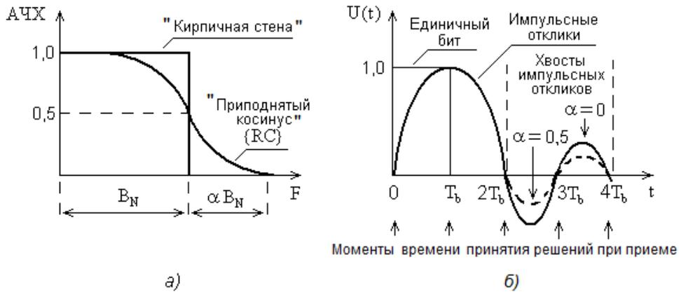
Рис. 4. Прямоугольная АЧХ фильтра Найквиста и АЧХ в виде «приподнятого косинуса» (а); формы импульсных откликов канала связи на единичный бит при использовании фильтра Найквиста ( $\alpha = 0$ ) и фильтра с АЧХ в виде «приподнятого косинуса» при  $\alpha = 0,5$  (б)
