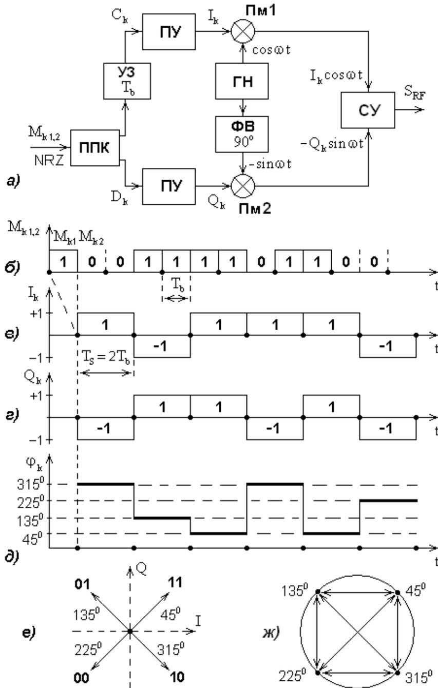
Рис. 13. Структурная схема QPSK-модулятора (а);
