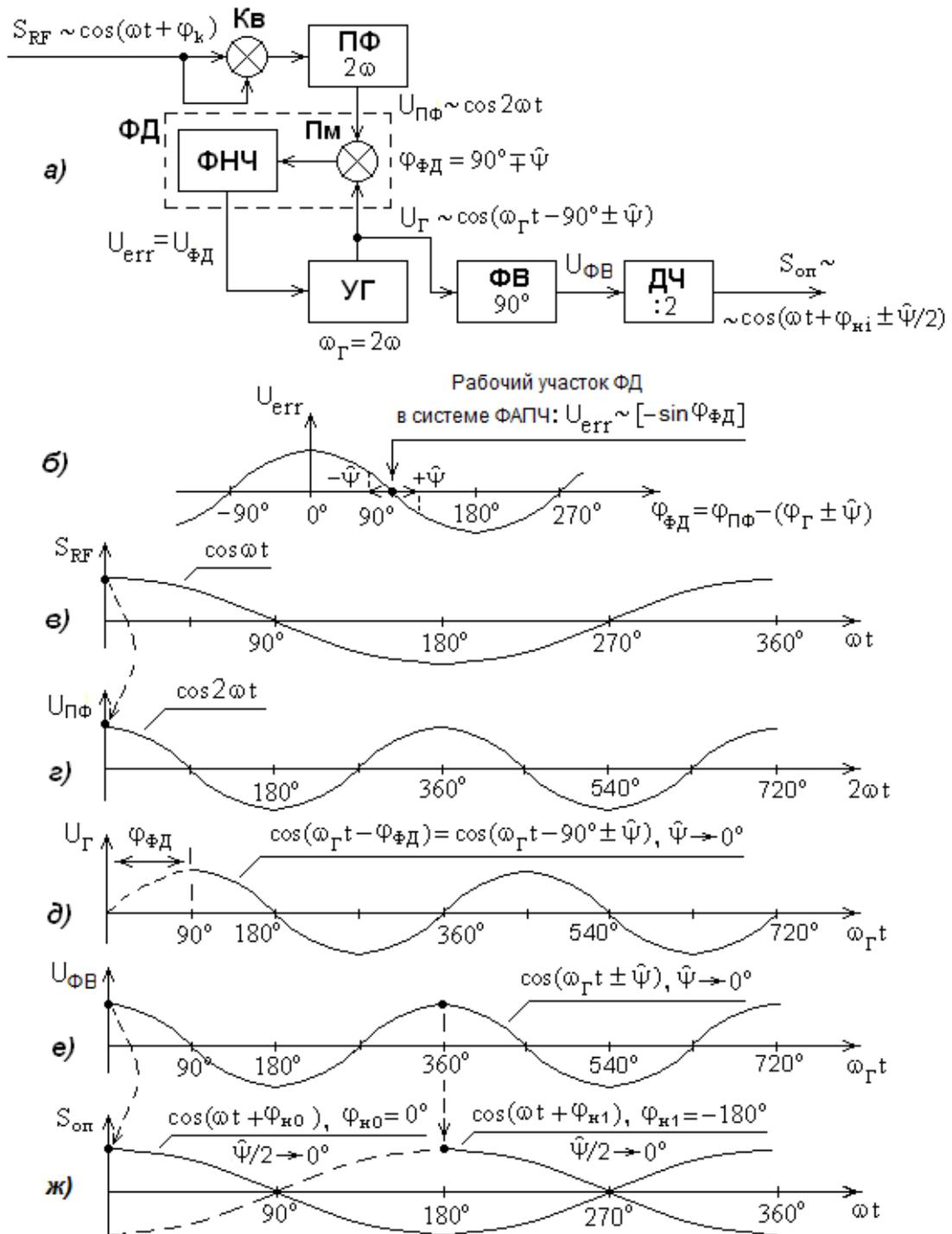
Рис. 7. Структурная схема БВНЧ с УГ (а);
