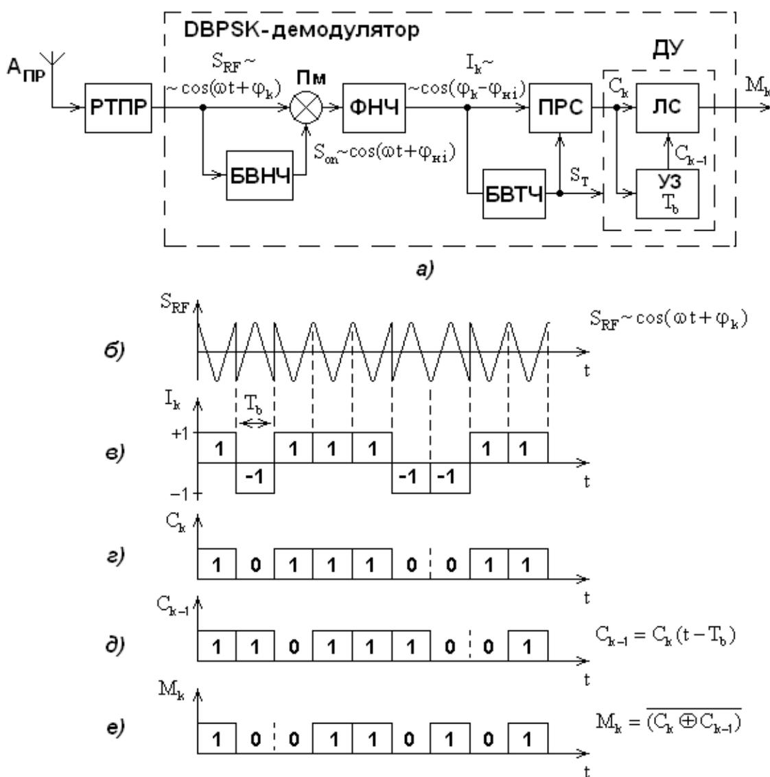
Рис. 5. Структурная схема DBPSK-приемника при когерентной демодуляции (а); принятый радиосигнал  $S_{\text{RF}}$  (б); цифровые потоки  $I_k$  (в),  $C_k$  (г),  $C_{k-1}$  (д),  $M_k$  (е) при  $\varphi_{\text{н0}} = 0^\circ$
