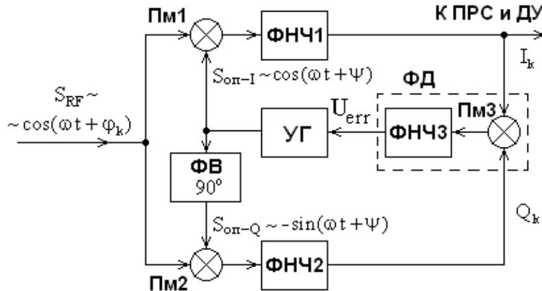
Рис. 8. Структурная схема Костаса для демодуляции DBPSK-радиосигнала
