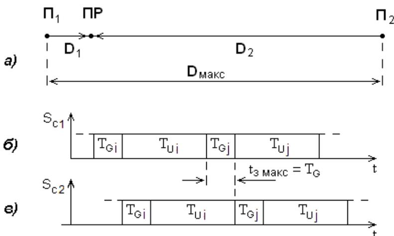
Рис. 34. Два одночастотных синхронных передатчика ( $\Pi_1$  и  $\Pi_2$ ) на расстоянии  $D$  друг от друга (а); сигнал  $S_{c1}$  в ПР от передатчика  $\Pi_1$  (б); сигнал  $S_{c2}$  в ПР от соседнего передатчика  $\Pi_2$  с максимально возможной задержкой  $t_{3\text{ макс}} = T_G$  относительно сигнала  $S_{c1}$  (в)
