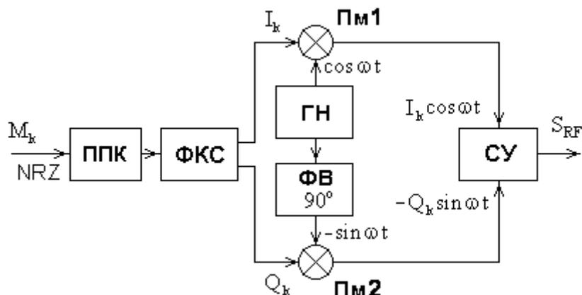
Рис. 26. Структурная схема QAM-модулятора.
