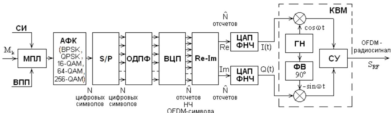
Рис. 35. Структурная схема формирователя OFDM-радиосигнала с блоком ОДФФ.
