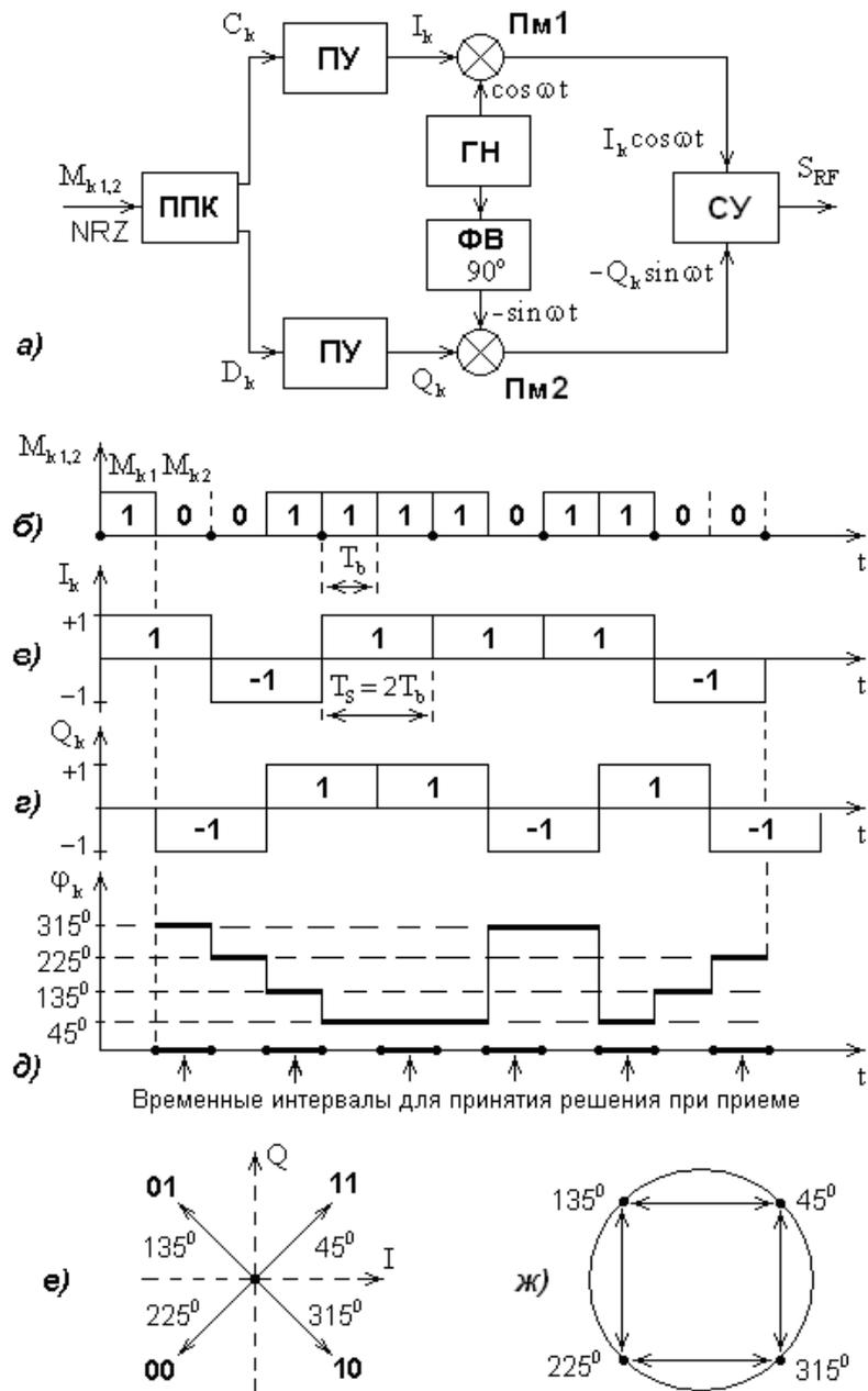
Рис. 15. Структурная схема OQPSK-модулятора (а); цифровой поток  $M_{k,1,2}$  (б); знакопеременные последовательности  $I_k$  (в) и  $Q_k$  (г); значение фазы напряжения несущей частоты на выходе QPSK-модулятора (д); сигнальное созвездие OQPSK-радиосигнала в зависимости от структуры дибита (е); фазовая диаграмма OQPSK-радиосигнала (ж)
