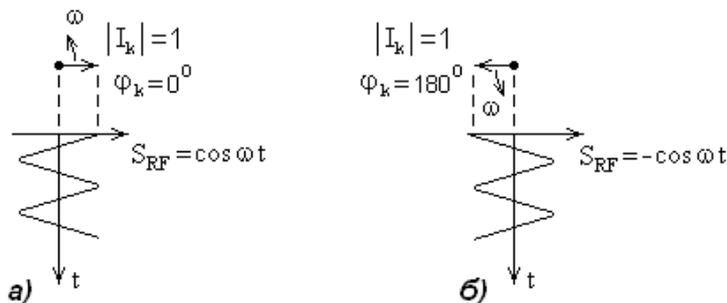
Рис. 2. Вектор  $I_k$ , вращающийся с частотой  $\omega$  и характеризующий радиосигнал  $S_{RF}$  при  $\varphi_k=0^\circ$  (а) и при  $\varphi_k=180^\circ$  (б)
