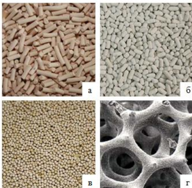
Рис. 20. а, б, в – синтетические цеолиты; г – пористая структура цеолита под микроскопом.
