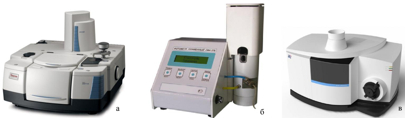
Рис. 8. а) атомно-эмиссионный спектрометр с индуктивно связанной плазмой; б) пламенный фотометр; в) ИК-Фурье спектрометр.
