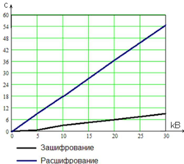
Зависимости размера файла от времени его шифрования \ расшифрования при проведении эксперимента на Athlon 2600+
