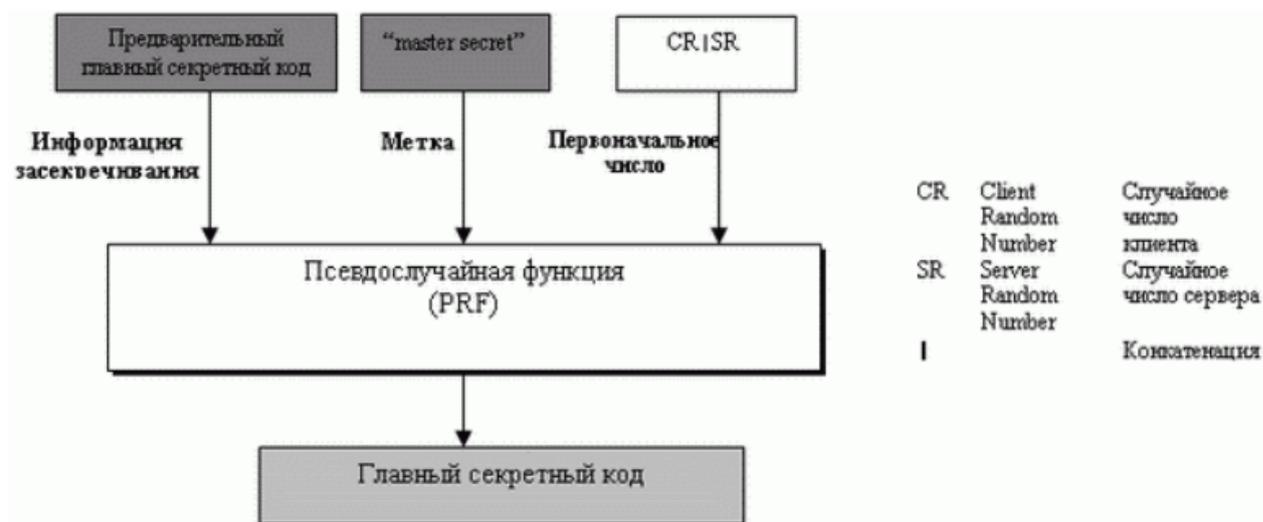
Рис. 9.13. Генерация главного секретного ключа
