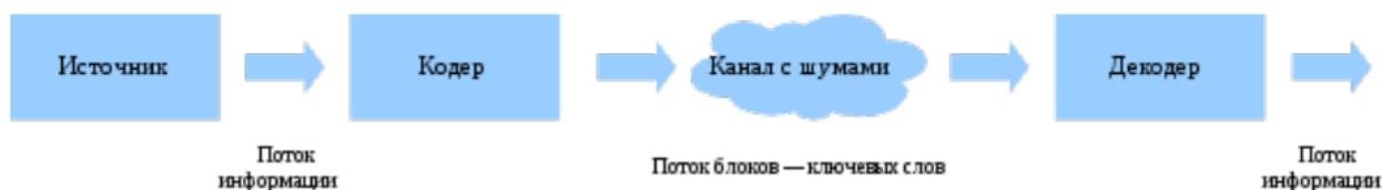
Рис. 3.119. Упрощенная схема передачи информации по каналу связи.
