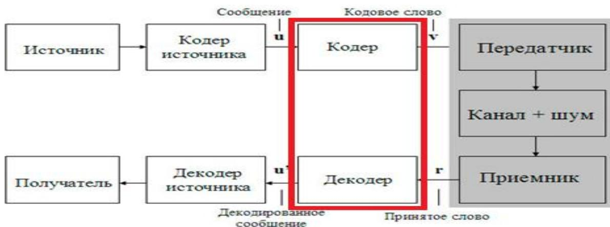
Рис. 3.1. Структурная схема системы передачи дискретной информации
