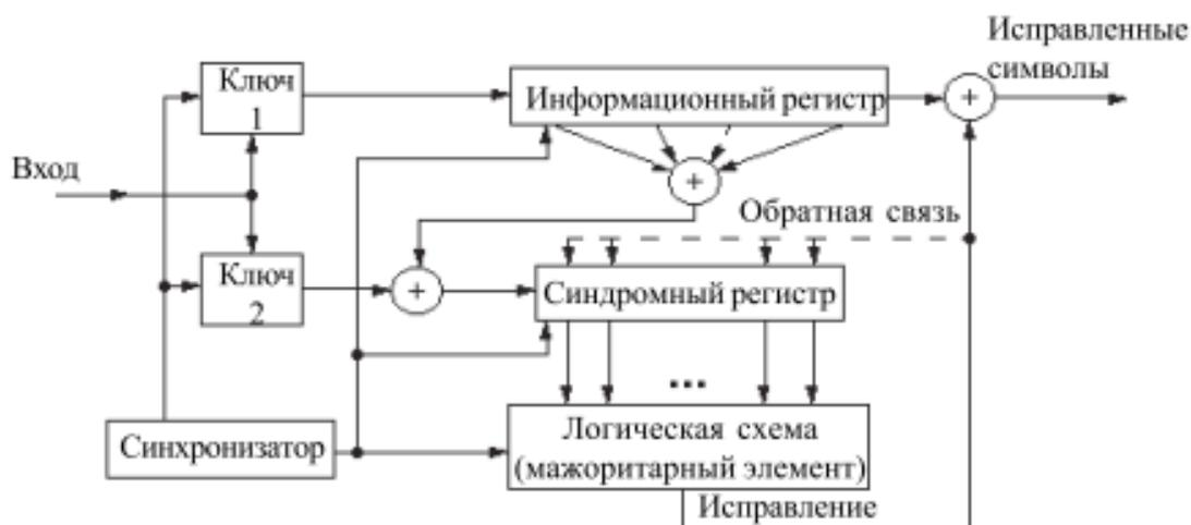
Рис. 3.70. Общая схема декодера для сверточного кода
