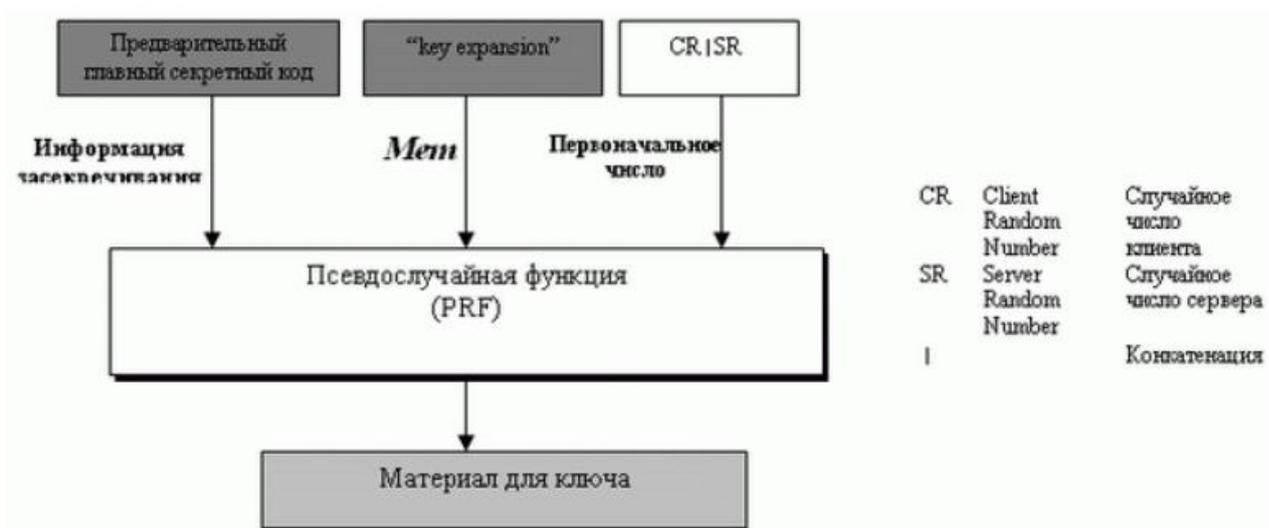
Рис. 9.14. Генерация материала для ключа
