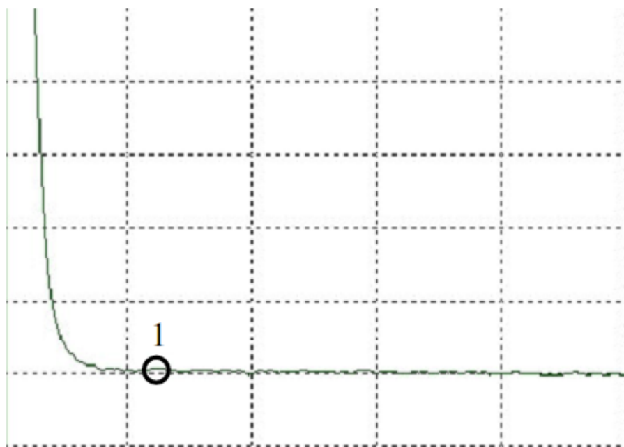
Рис. 4.48. Мертвая зона на ближнем конце
