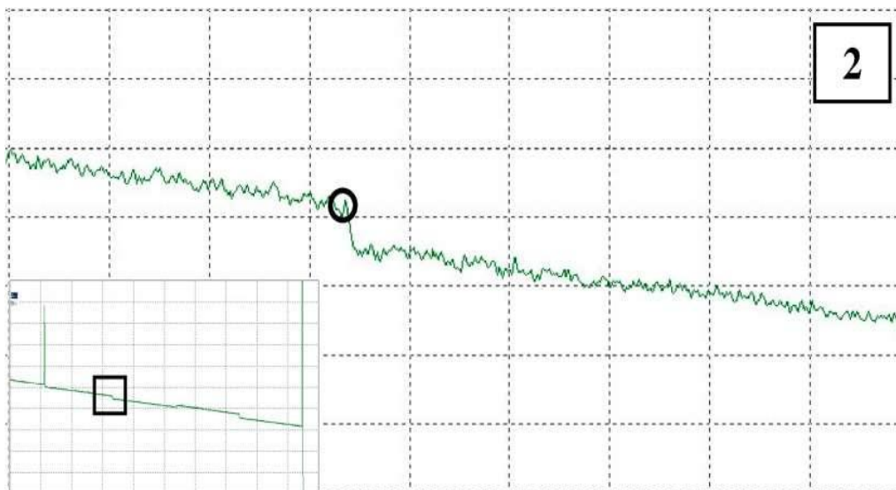
Рис. 4.21. Неоднородность с отражением (механический соединитель)
