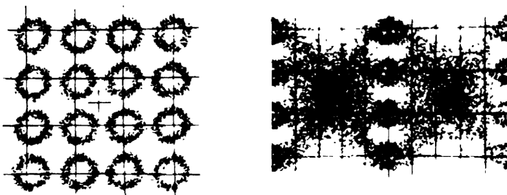
Рис. 2.17. Измерение шумов на фоне интерферирующего одночастотного сигнала
