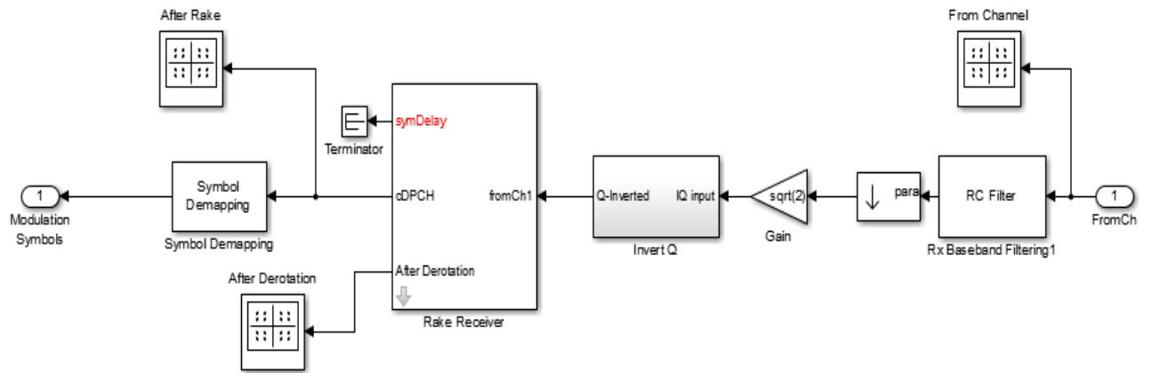
Рис. 7.21. Модель приемника
