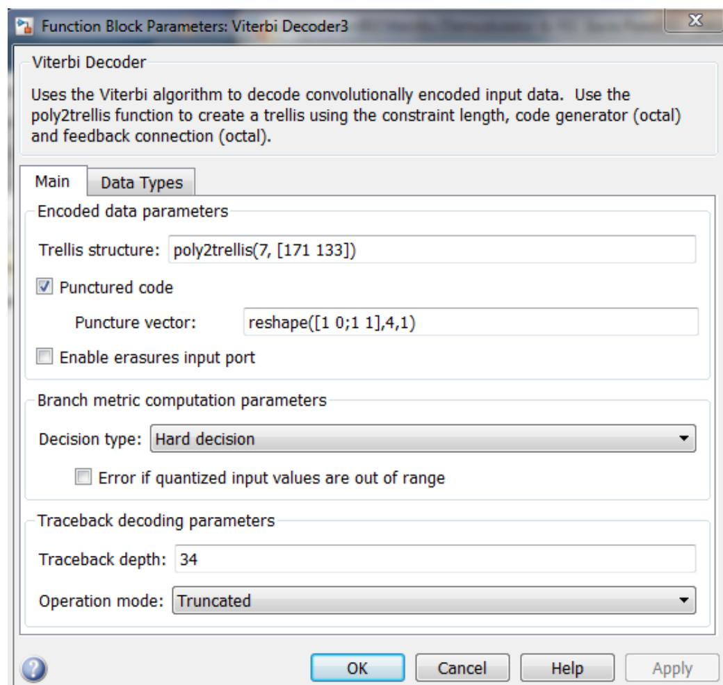
Рисунок 7.101 – Состав блока декодера Виттерби «Viterbi Decoder 16QAM 1/2»
