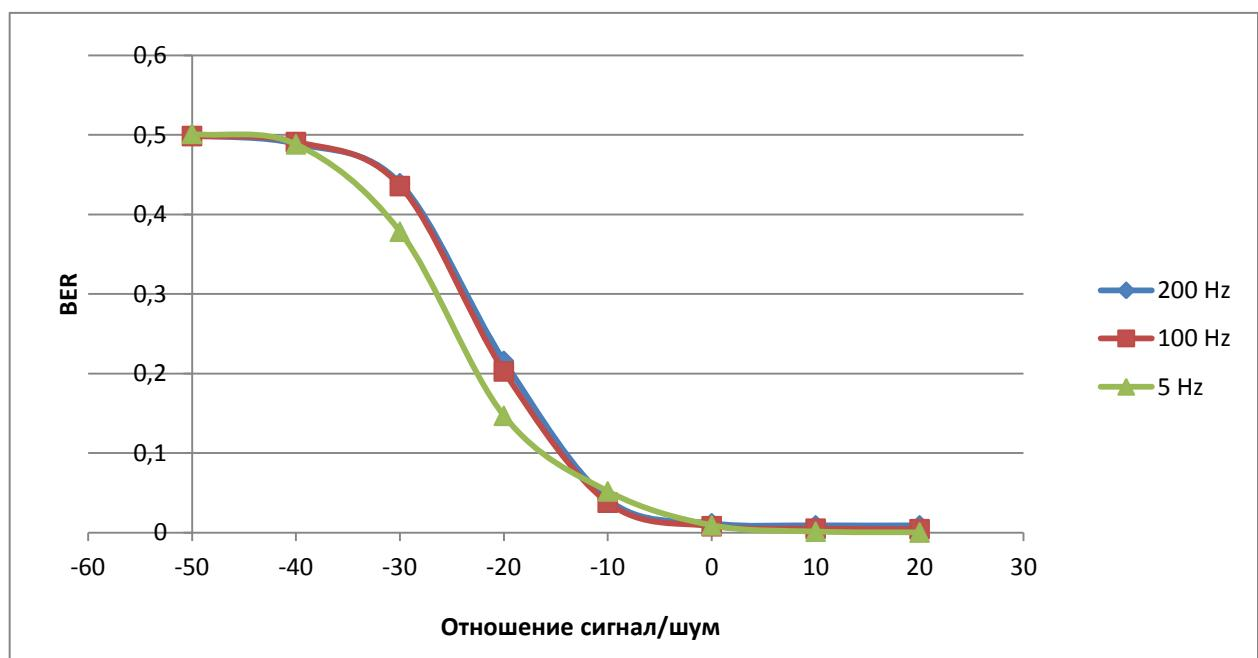
Рис. 7.15. Зависимость BER от отношения сигнал/шум при доплеровском сдвиге
