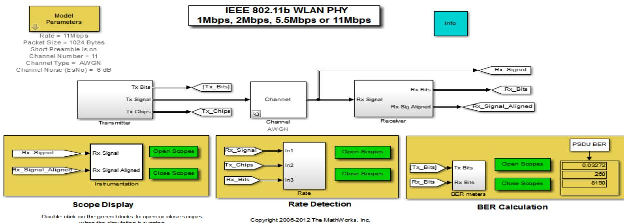
Рис. 7.65. Схема сети IEEE 802.11b MATLAB
