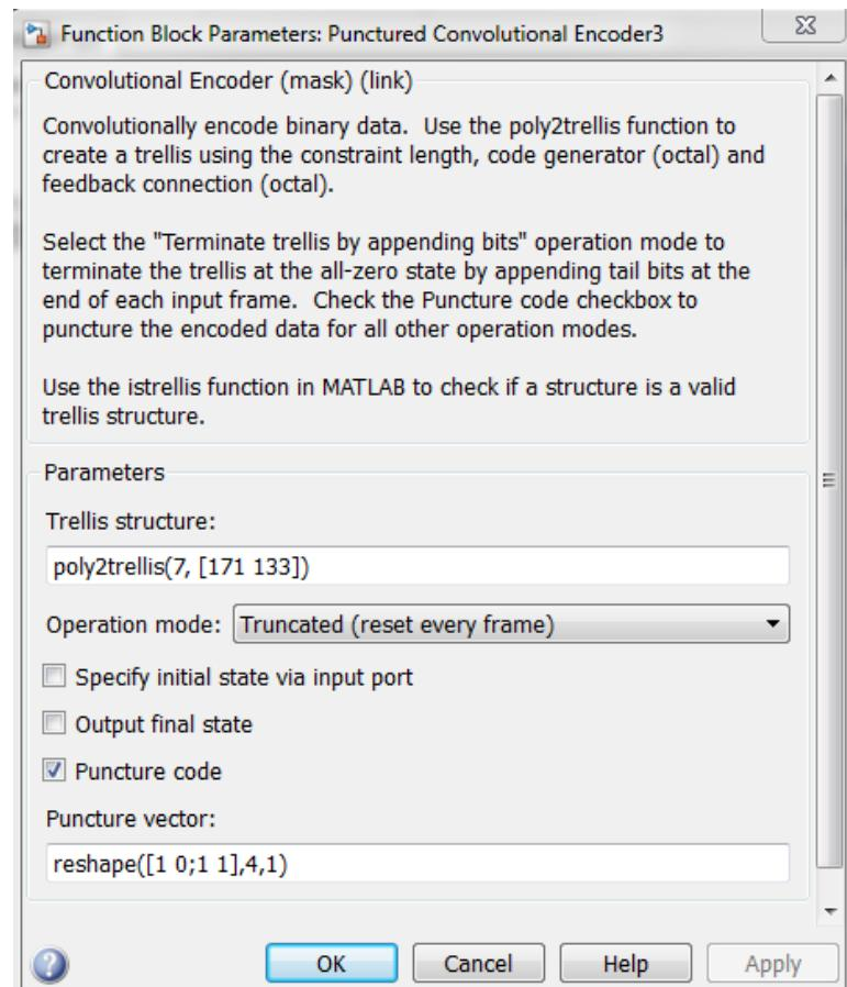
Рисунок 7.88 – Состав блока сверточного кодера«Convolutinal Encoder 16QAM 1/2»
