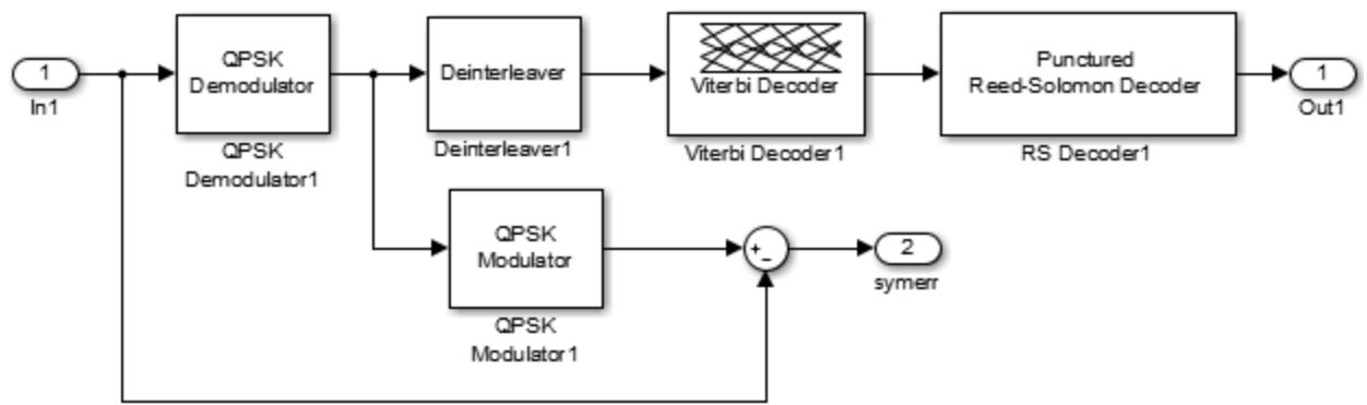
Рисунок 7.93 – Состав блока демодулятора «QPSK 1/2»
