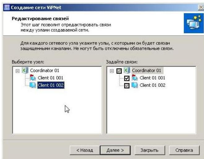
Рис. 6.76. Редактирование связей между узлами сети ViPNet
