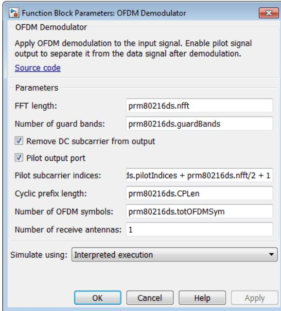
Рисунок 7.105 – Параметры системы, изменяемые в блоке «OFDM Demodulator»
