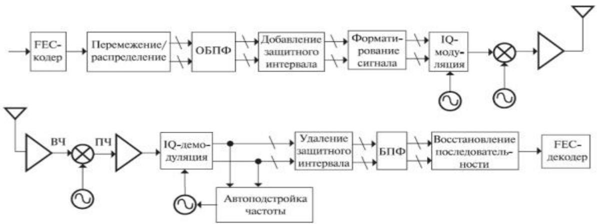
Рис. 7.55. Функциональная схема трактов приема/передачи стандарта IEEE 802.11a
