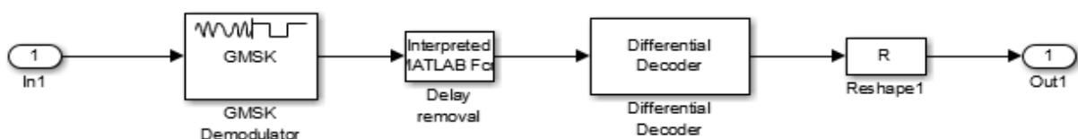
Рис. 7.7. Схема демодулятора
