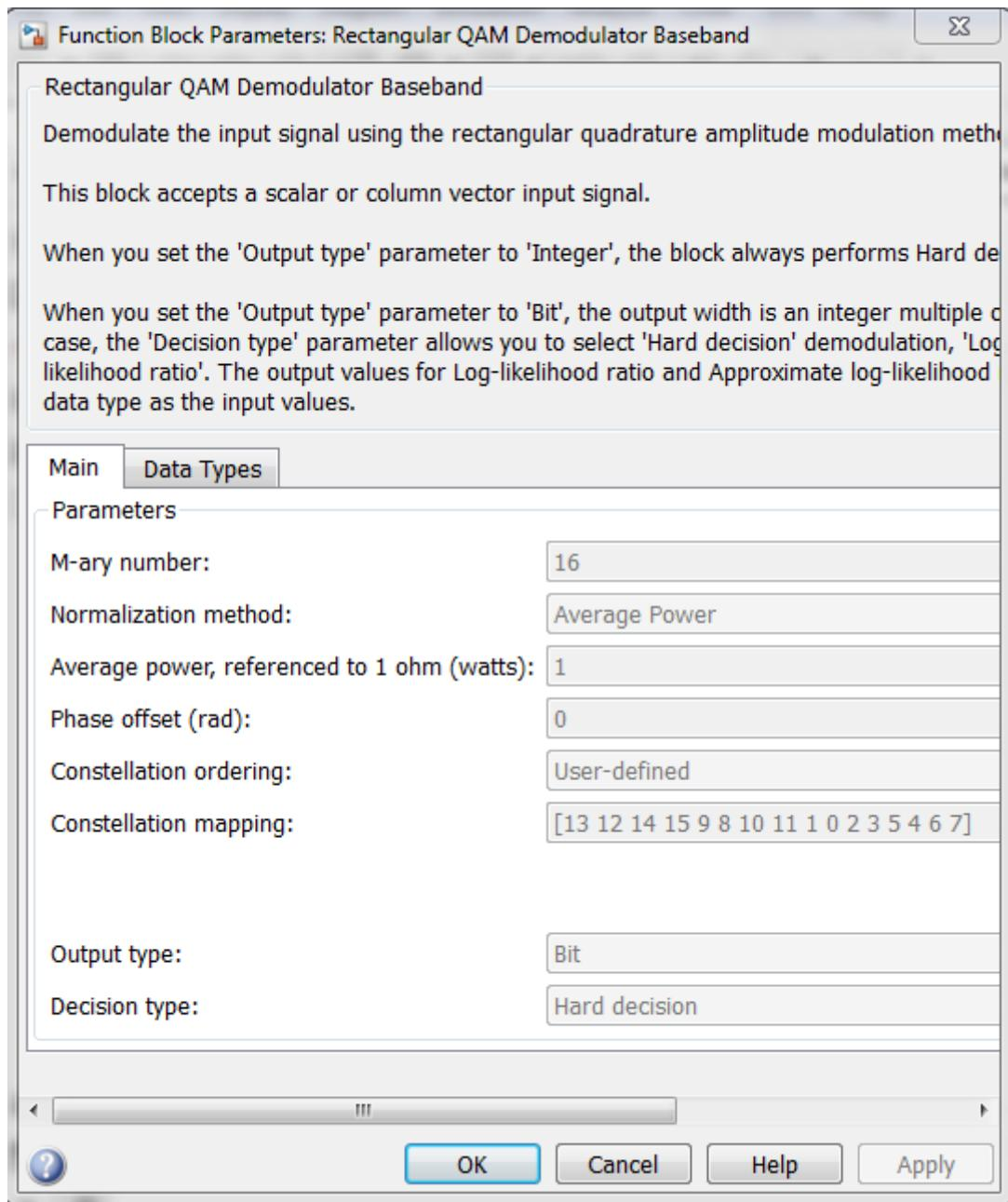
Рисунок 7.99 – Состав блока демодулятора «16-QAM Modulator 16QAM 1/2»
