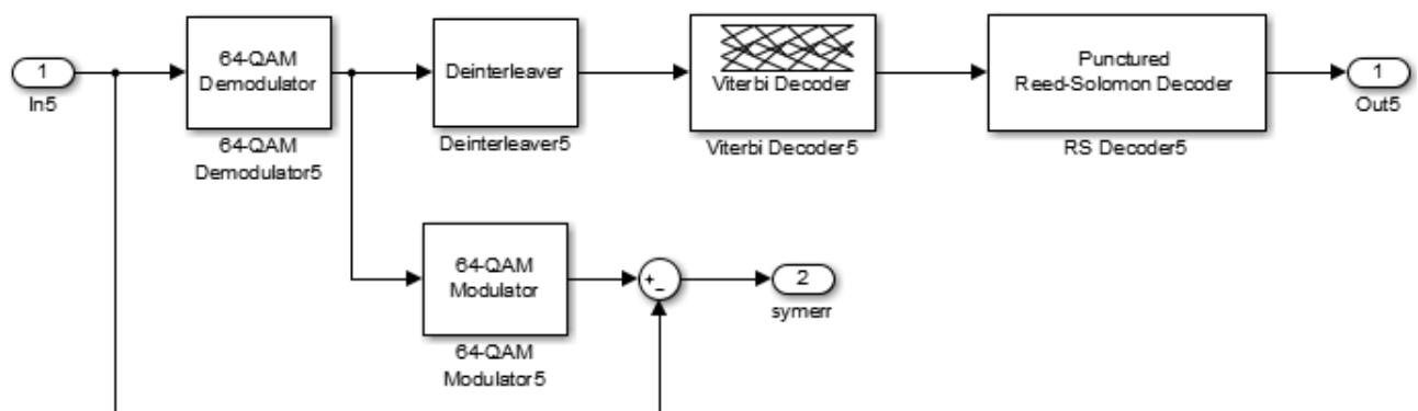
Рисунок 7.97 – Состав блока демодулятора «64QAM 2/3»
