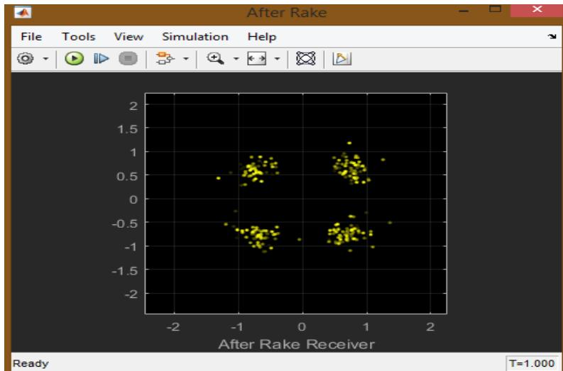
Рис. 7.43. Сигнал, декодированный мобильной станцией, на I-Q диаграмме
