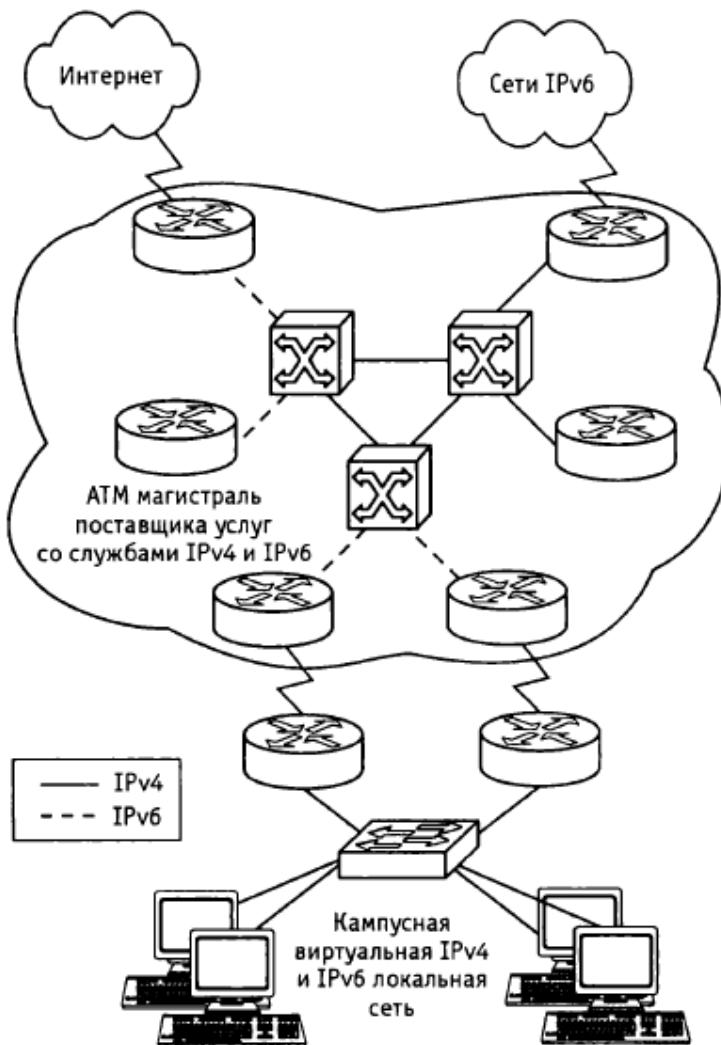
Рис. 6.5. Разворачивание IPv6 по выделенным каналам данных
