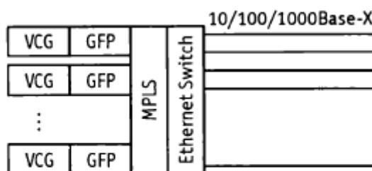
Рис. 3.27. Стек протоколов Ethernet-over-SDH
