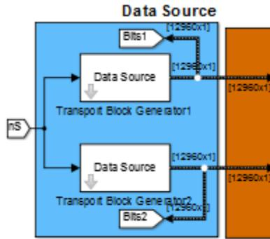
Рис. 7.130. Разделение исходного потока бит на параллельные потоки
