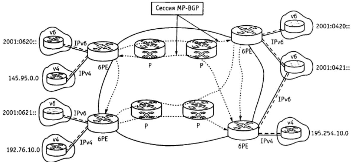
Рис. 6.8. IPv6 на маршрутизаторах на стороне провайдера (PE)
