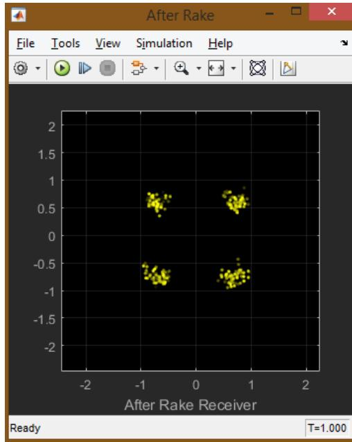
Рис. 7.33. Сигнал, декодированный мобильной станцией, на I-Q диаграмме
