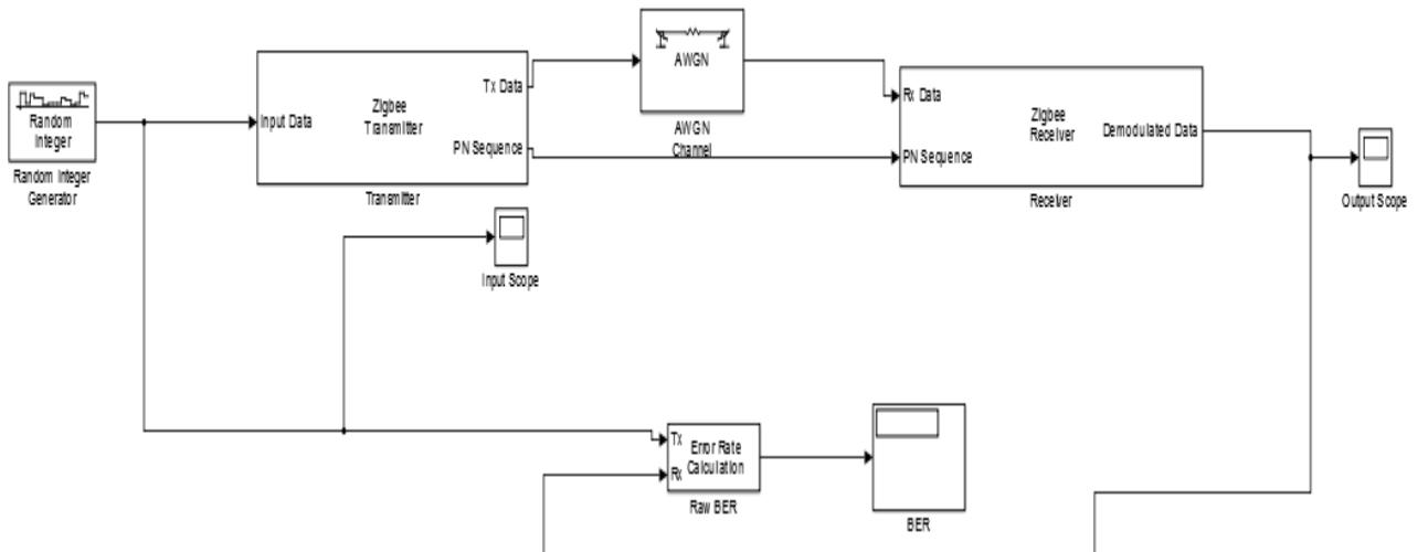
Рис. 7.69. Схема стандарта ZigBee 802.15.4 Simulink MATLAB 2015b
