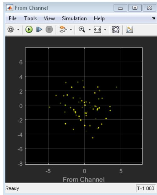
Рис. 7.27. Сигнал принимаемый мобильной станцией после прохождения через канал на I-Q диаграмме.
