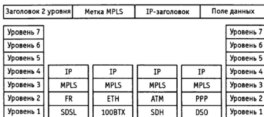
Рис. 4.1. Технология MPLS в IP-сетях и модель OSI/ISO
