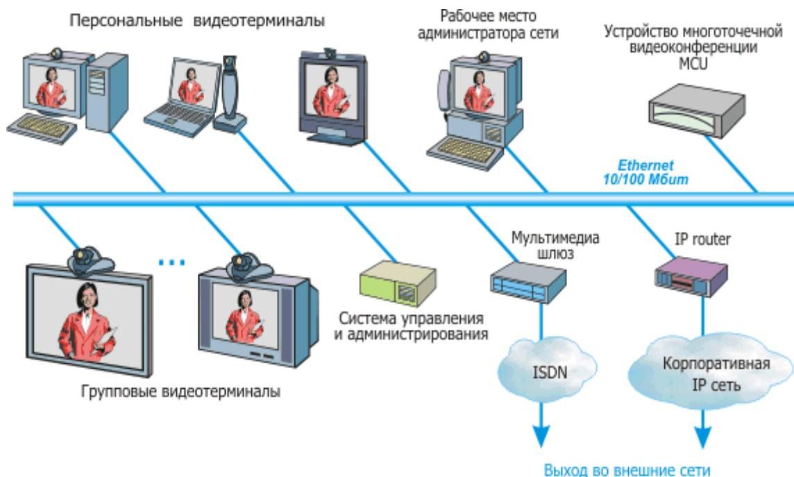
Рис. 6.109. Структурная схема многоточечной видеоконференции в локальной сети.
