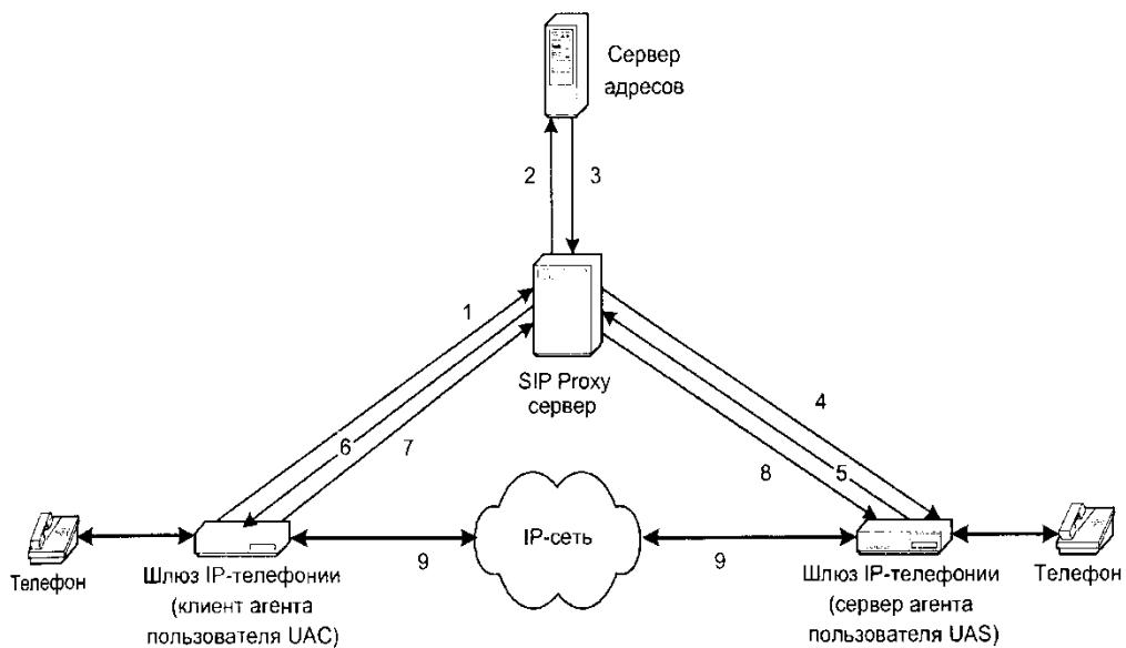
Рис. 6.8. Схема сигнализации по протоколу SIP
