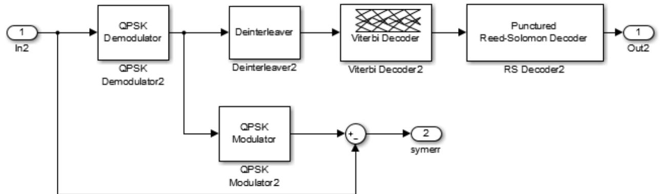
Рисунок 7.94 – Состав блока демодулятора «QPSK 3/4»
