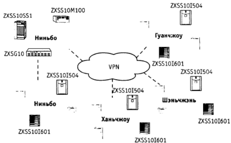
Рис. 5.18. Взаимодействие широкополосных речевых услуг, предоставленных системой Softswitch от ZTE, в нескольких городских сетях
