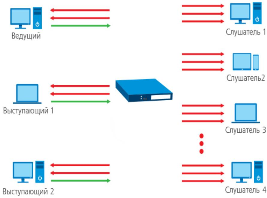
Рис. 6.106. Структура «селекторной» видеоконференции
