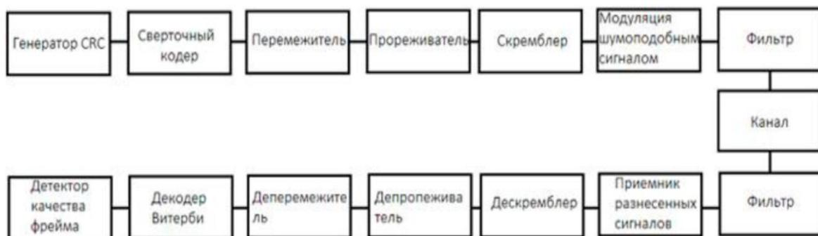
Рис. 7.18. Структурная схема CDMA
