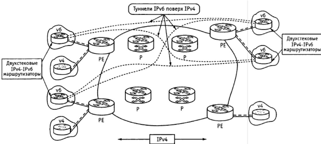
Рис. 6.6. Разворачивание IPv6 с использованием туннелей на СЕ маршрутизаторах
