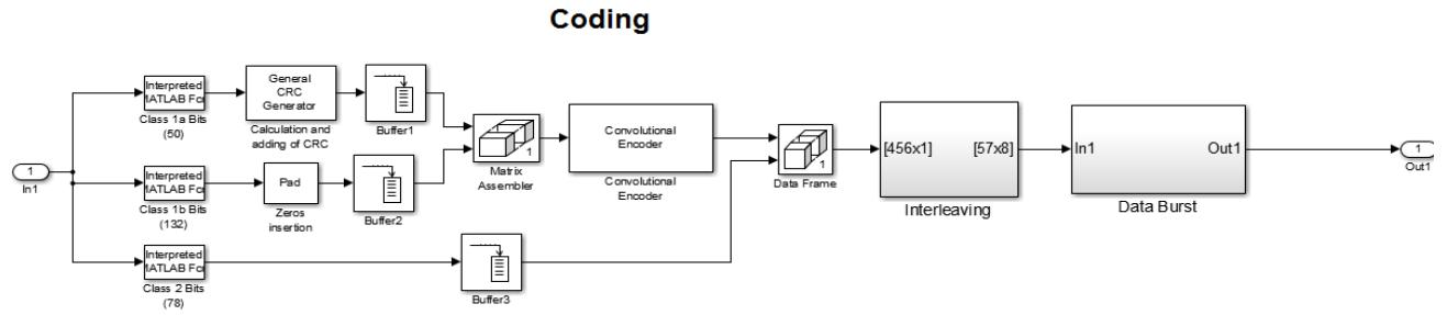
Рис. 7.4. Схема кодера
