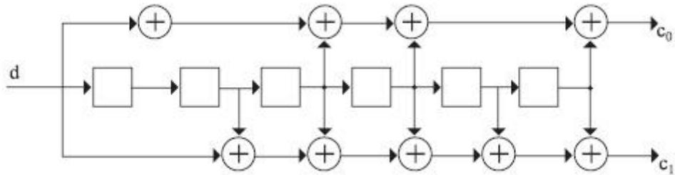
Рис. 7.52. Сверточное кодирование с двумя битами кодовой последовательности
