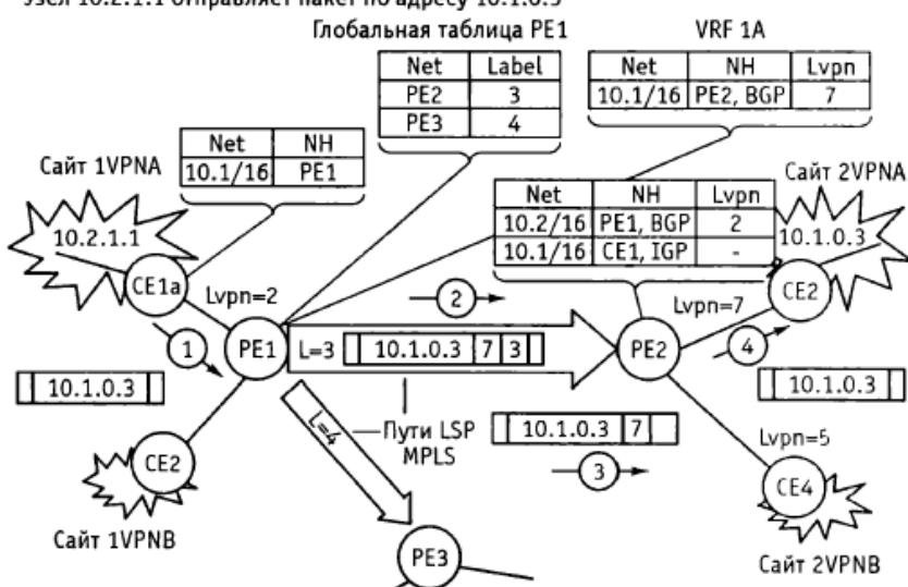
равное 3. Способ его прокладки между маршрутизаторами PE1 и PE2 не имеет в данном случае принципиального значения - главное, чтобы такой путь существовал.
