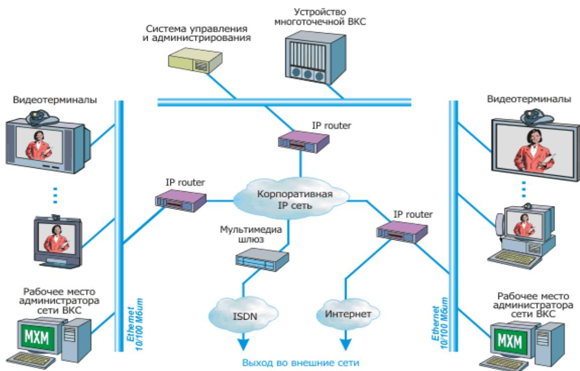
Рис. 6.110. Структурная схема многоточечной видеоконференции в терриориально распределенной IP-сети.
