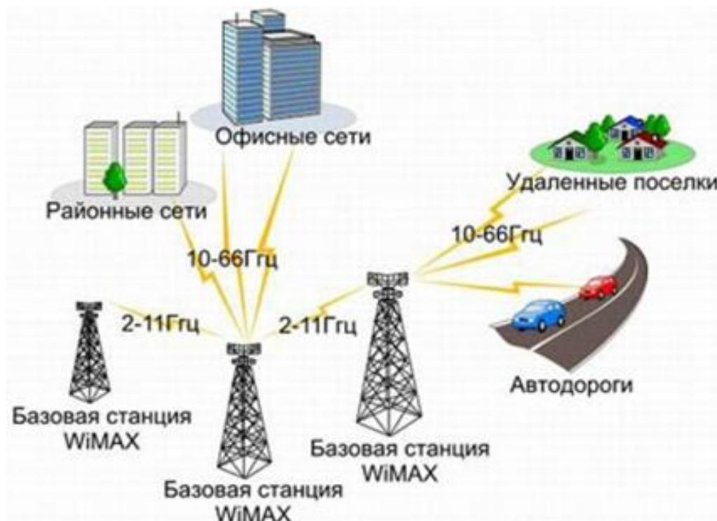
Рисунок 7.69 – Схематичное изображение сети WiMAX
