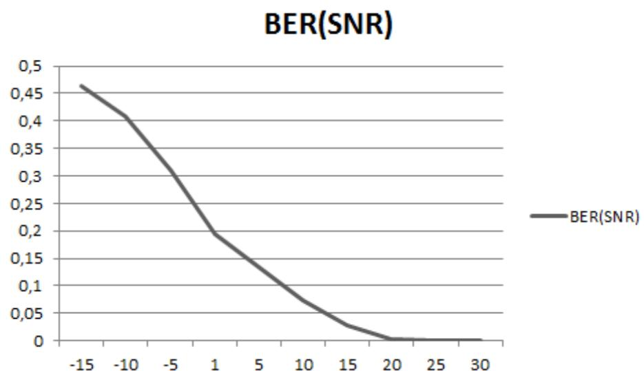
Рис. 7.149. Зависимость битовой вероятности ошибки от отношения сигнал/шум для второго потока
