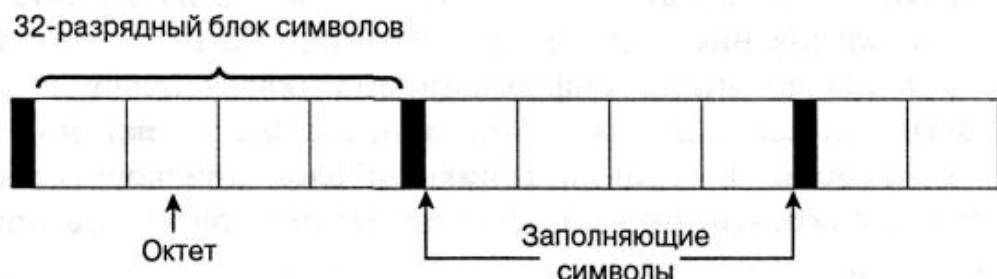
Рис. 7.47. Скремблированный PSDU в технологии FHSS
