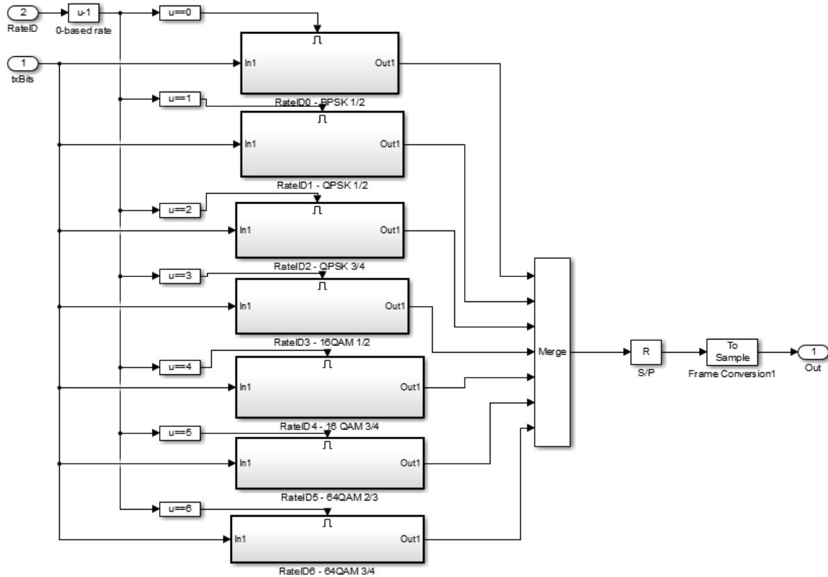
Рисунок 7.78 – Состав блока «FEC & Modulator Bank»
