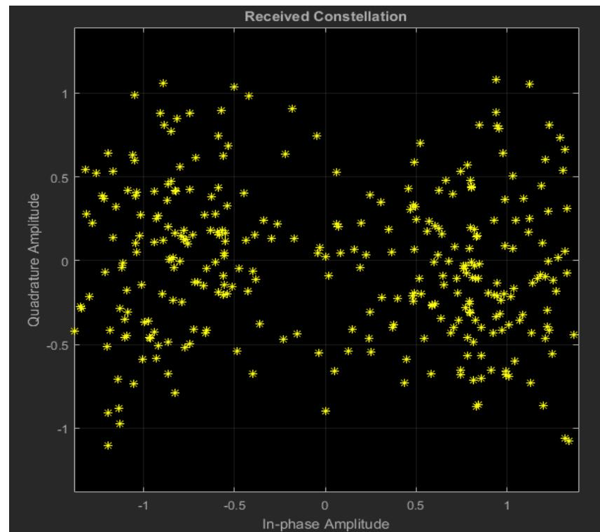
Рисунок 7.110 – Созвездие принимаемого сигнала (SNR = 2)
