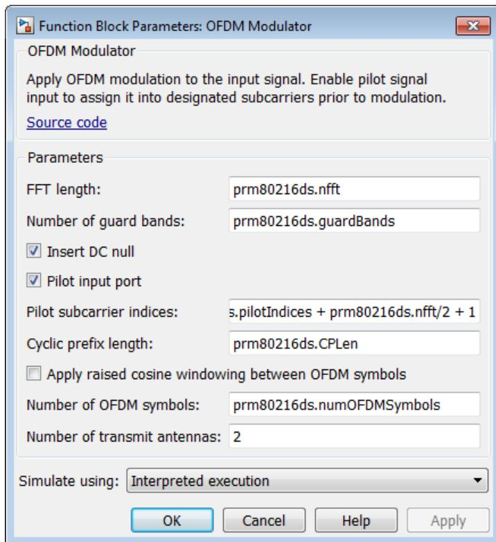
Рисунок 7.104 – Параметры системы, изменяемые в блоке «OFDM Modulator»
