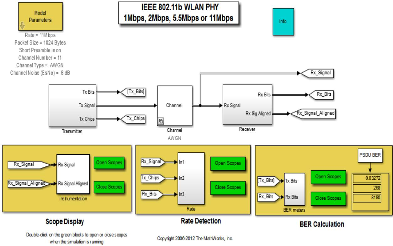
Рис. 7.58. Модель радиоинтерфейса 802.11b Simulink MATLAB 2015b
