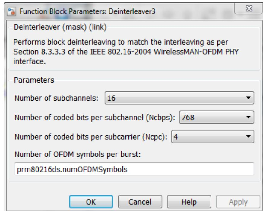
Рисунок 7.100 – Состав блока деперемежителя « Deinterleaver 16QAM 1/2»
