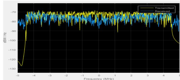
Рис. 7.151. Спектр входного (желтым) и выходного (синим) сигналов
