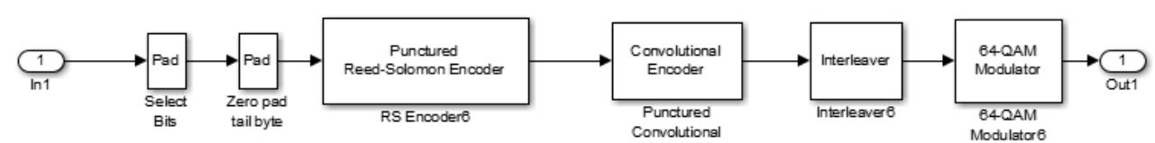
Рисунок 7.85 – Состав блока модулятора «64QAM 3/4»
