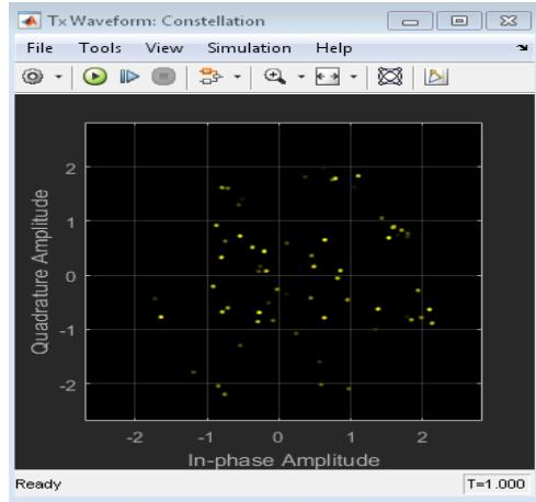
Рис. 7.25. Сгенерированный базовой станцией сигнал на I-Q диаграмме
