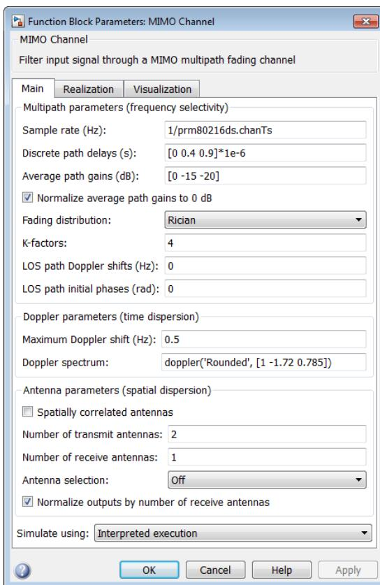
Рисунок 7.106 – Параметры системы, изменяемые в блоке «MIMO Channel»
