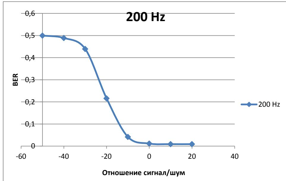
Рис. 7.14. Зависимость BER от отношения сигнал/шум при доплеровском сдвиге
