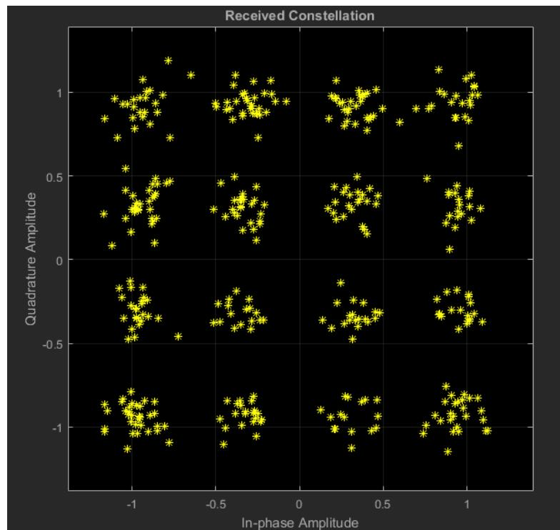
Рисунок 7.112 – Созвездие принимаемого сигнала (SNR = 18)
