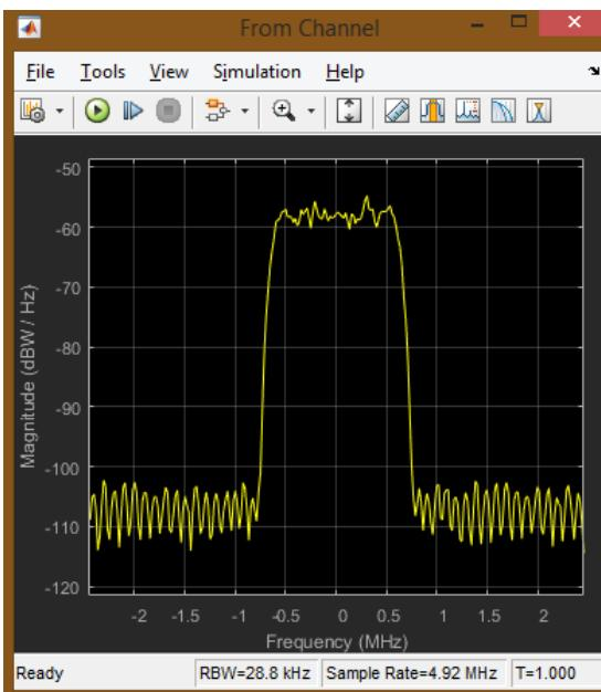
Рис. 7.32. Спектр сигнала после канала
