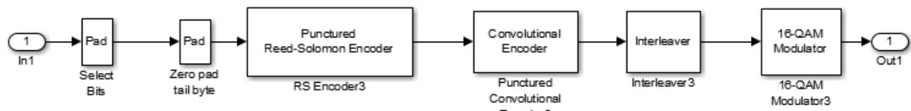
Рисунок 7.82 – Состав блока модулятора «16QAM 1/2»
