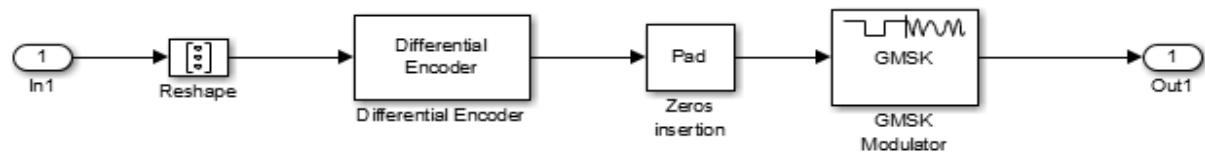
Рис. 7.5. Схема модулятора
