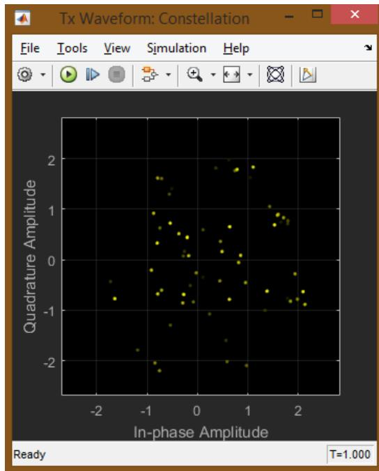
Рис. 7.31. Сгенерированный базовой станцией сигнал на I-Q диаграмме.
