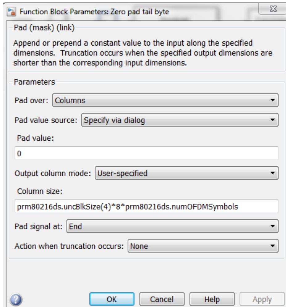
Рисунок 7.86 – Состав блока «Zero pad tail byte 16QAM 1/2»
