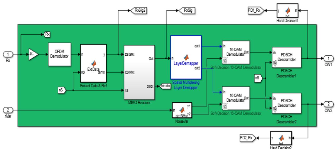
Рис. 7.138. Параллельные потоки-ОДПФ-демодуляция
