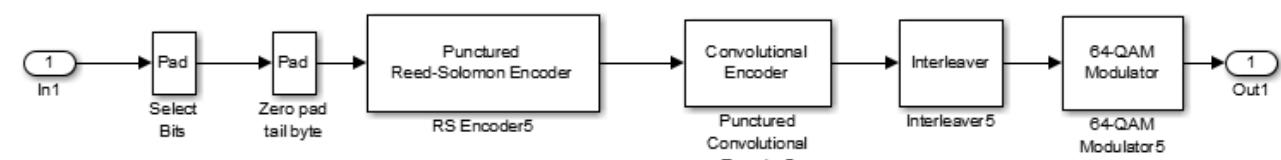
Рисунок 7.84 – Состав блока модулятора «64QAM 2/3»
