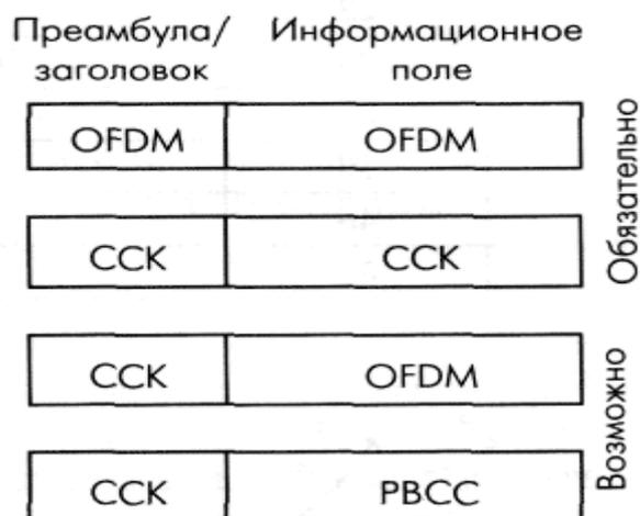
Рис. 7.56. Кадры IEEE 802.11g в различных режимах модуляции
