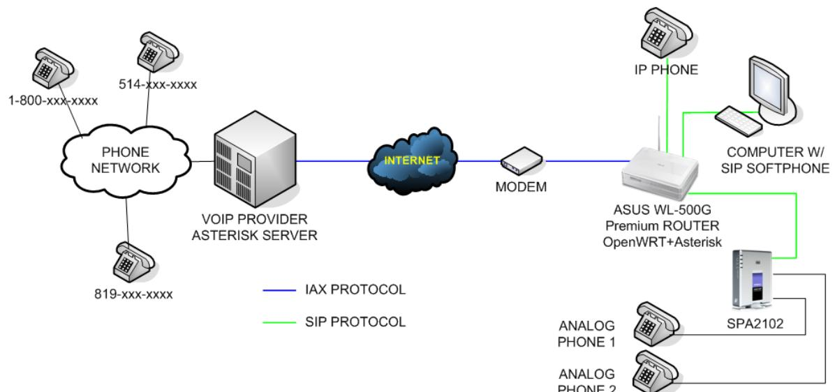
Рис. 6.10. структурная схема сетевого решения на базе Asterisk
