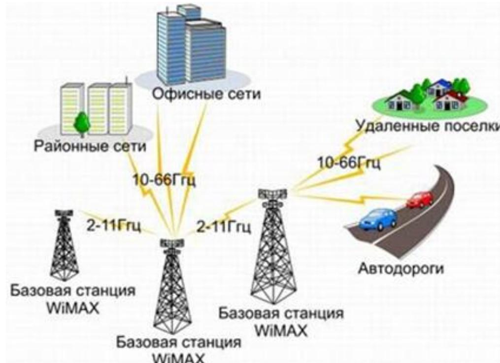
Рисунок 7.69 – Схематичное изображение сети WiMAX
