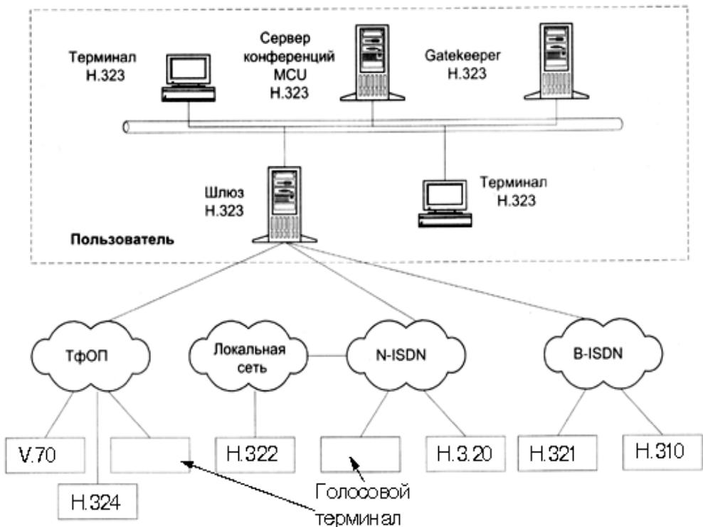
Рис. 6.5. Конфигурация сети на базе стандарта H.323
