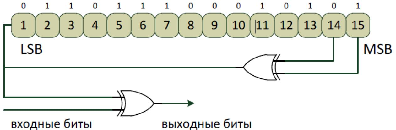
Рисунок 7.71 – Схема скремблера
