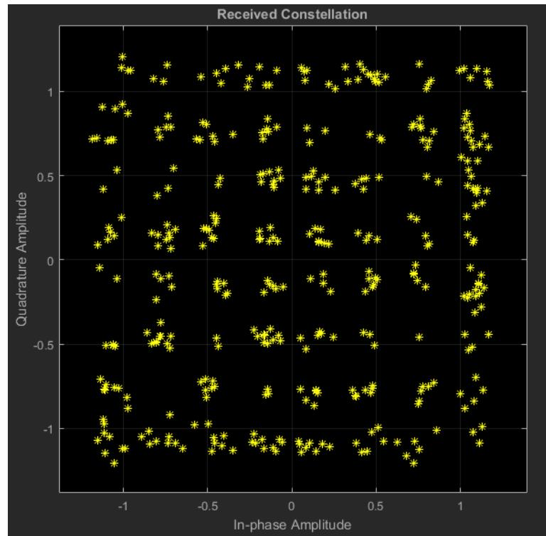
Рисунок 3.113 – Созвездие принимаемого сигнала (SNR = 22)
