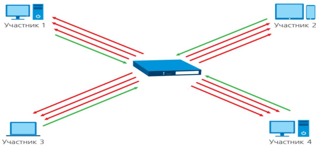
Рис. 6.104. Структура «симметричной» видеоконференции
