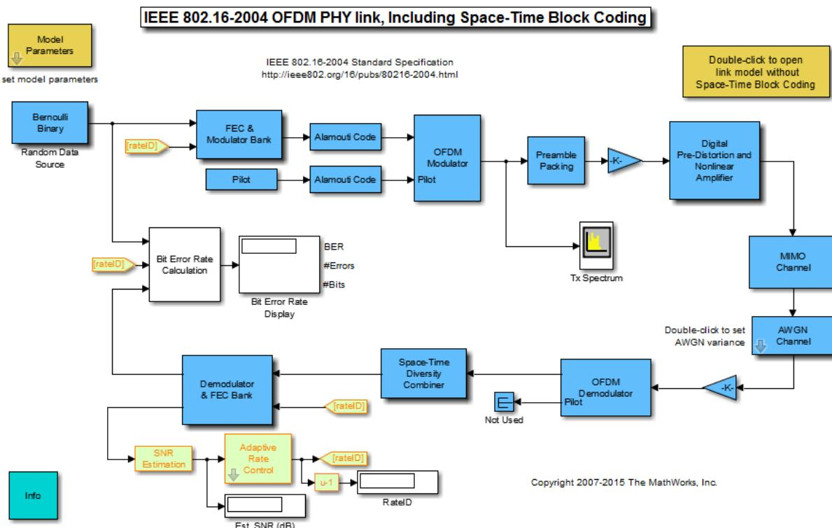
Рисунок 7.75 – Модель IEEE 802.16-2004 OFDM в MATLAB 2015b
