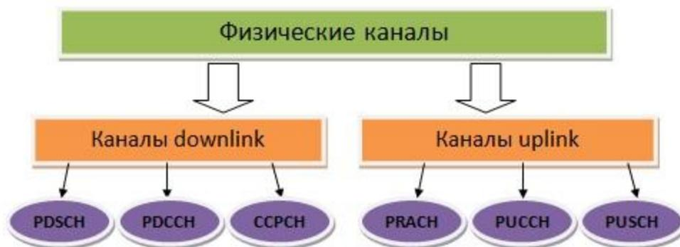
Рис. 7.127. Физические каналы LTE
