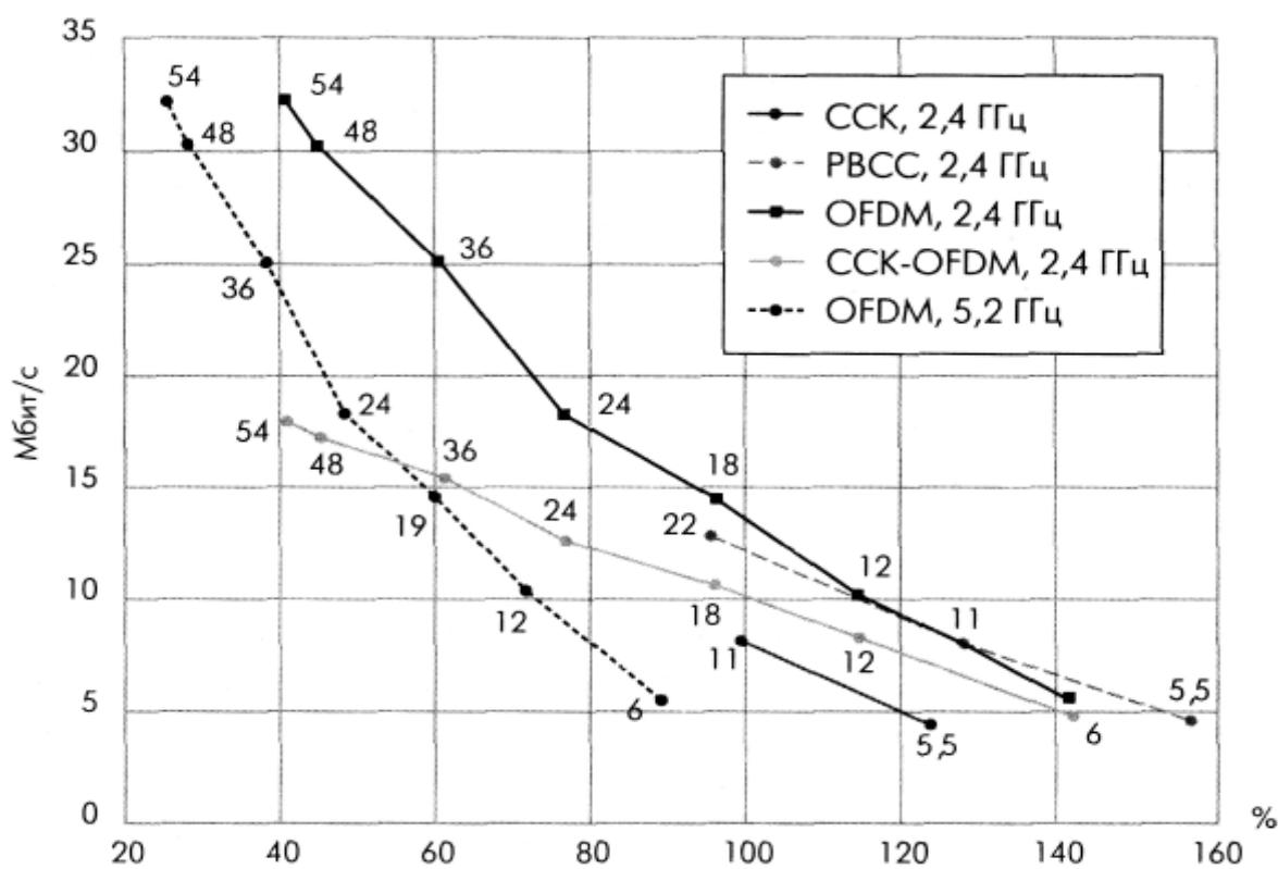
Рис. 7.57. Зависимость скорости передачи от расстояния для различных технологий передачи. Расстояние приведено в процентах, 100% - дальность передачи с модуляцией CCK на скорости 11 Мбит/с
