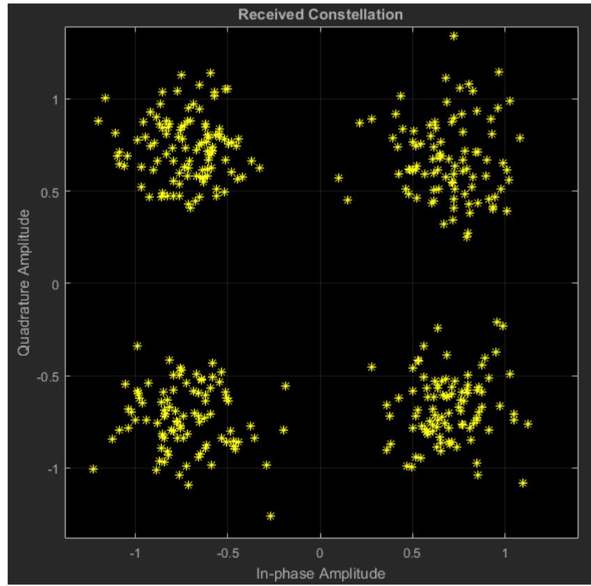
Рисунок 7.111 – Созвездие принимаемого сигнала (SNR = 11)
