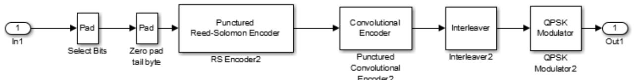
Рисунок 7.81 – Состав блока модулятора «QPSK 3/4»
