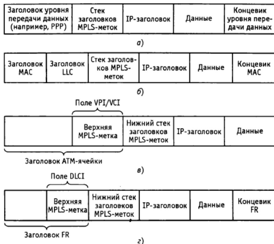
Рис. 4.5. а) Стеки заголовков меток MPLS в протоколе PPP;
