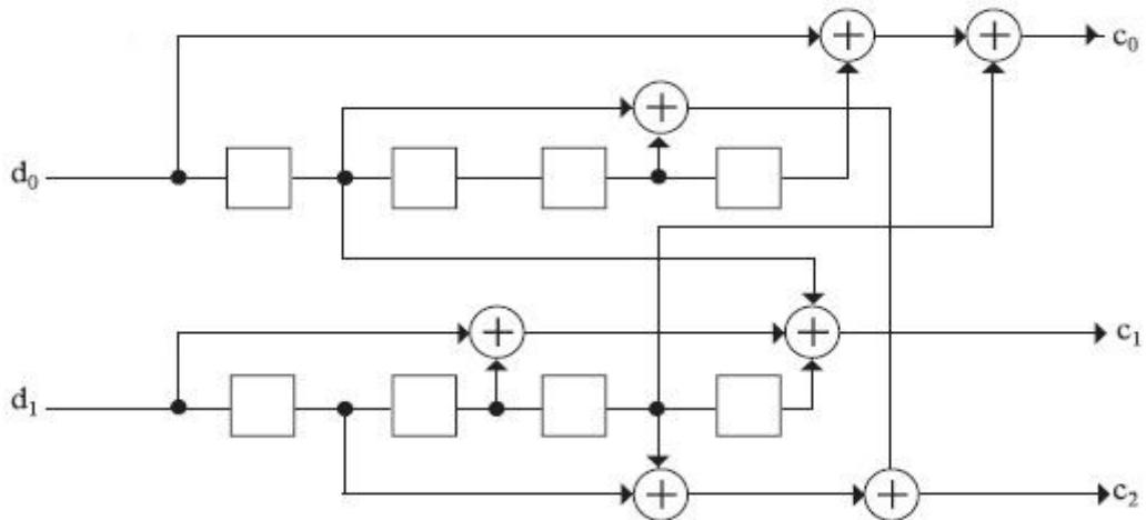
Рис. 7.53. Сверточное кодирование с тремя битами кодовой последовательности
