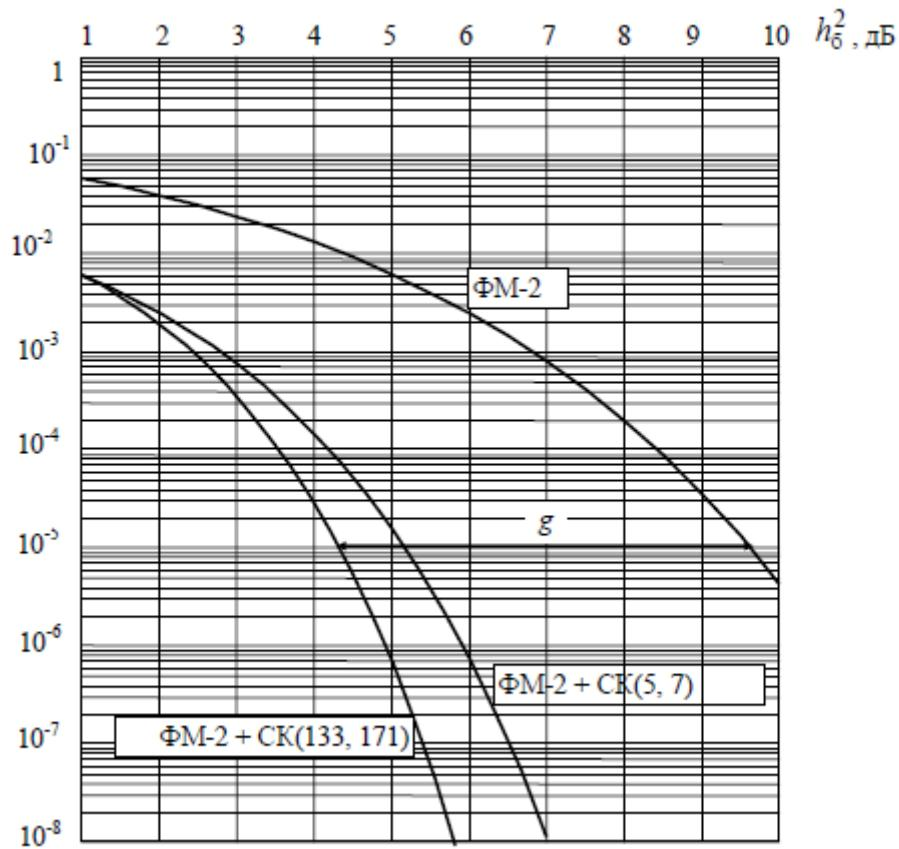
Рис. 8.2. Помехоустойчивость декодирования сверточных кодов
