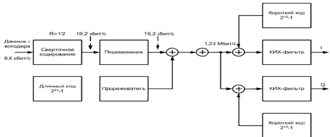
Рис. 7.16. Схема кодирования в прямом канале
