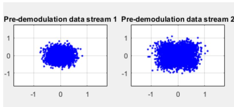
Рис. 7.152. Диаграмма созвездий переданного сигнала для каждой из антенн ММО
