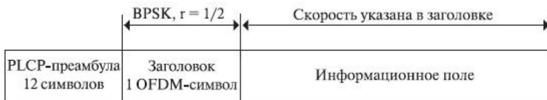
Рис. 7.54. Структура заголовка физического уровня стандарта IEEE 802.11a
