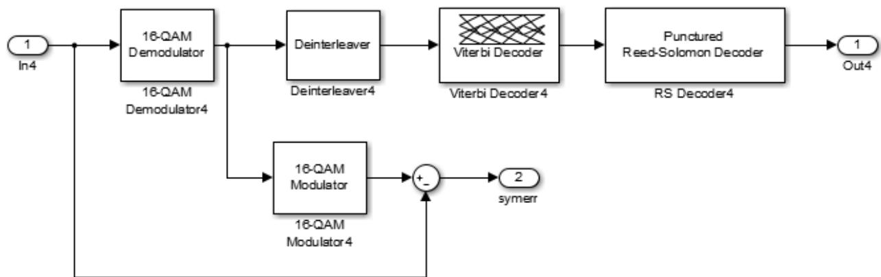
Рисунок 7.96 – Состав блока демодулятора «16QAM 3/4»
