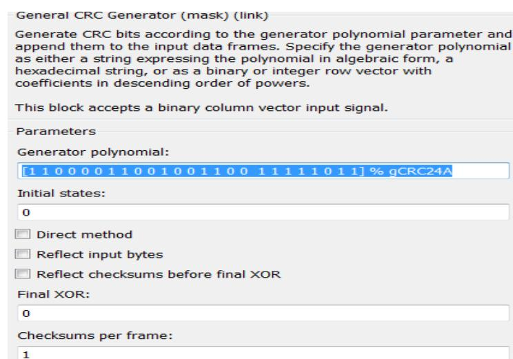
Рис. 7.132. Параметры CRC кодера
