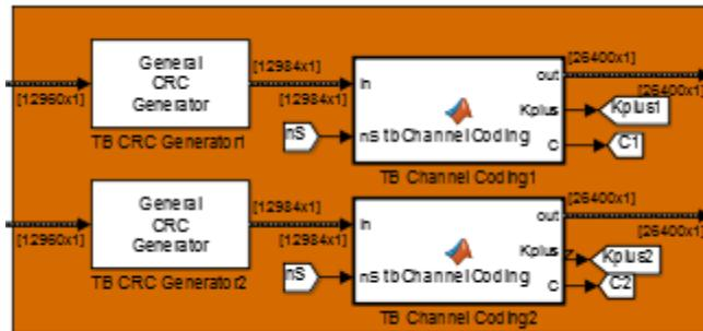
Рис. 7.131. Кодирование помехоустойчивым кодом
