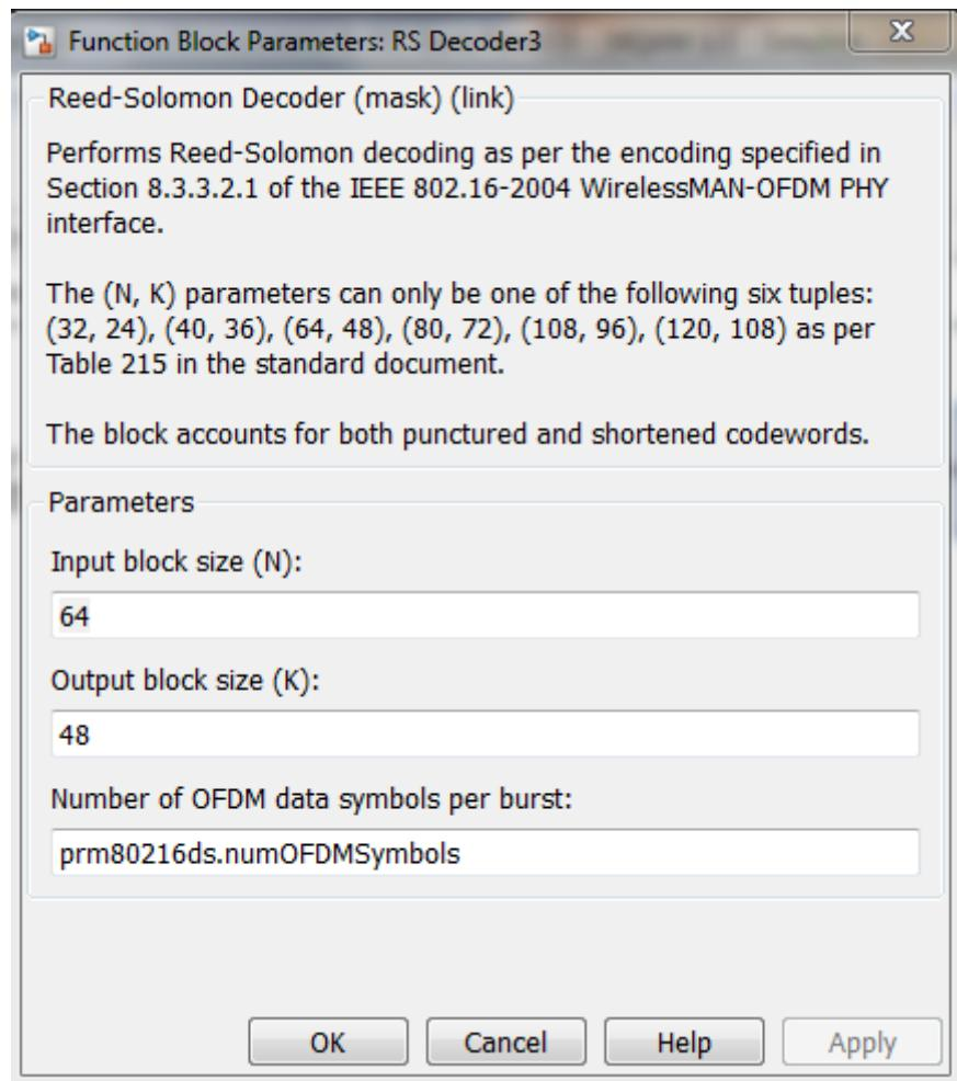
Рисунок 7.102 – Состав блока декодера Рида-Соломона «RS Decoder 16QAM 1/2»
