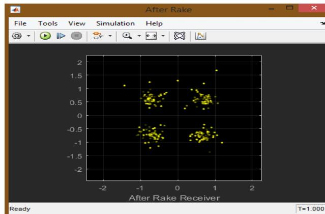
Рис. 7.39. Сигнал, декодированный мобильной станцией, на I-Q диаграмме.
