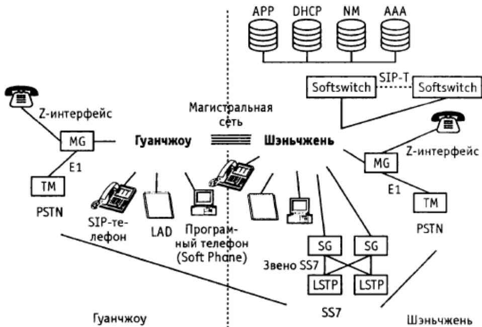
Рис. 5.20. Архитектура экспериментальной сети NGN
