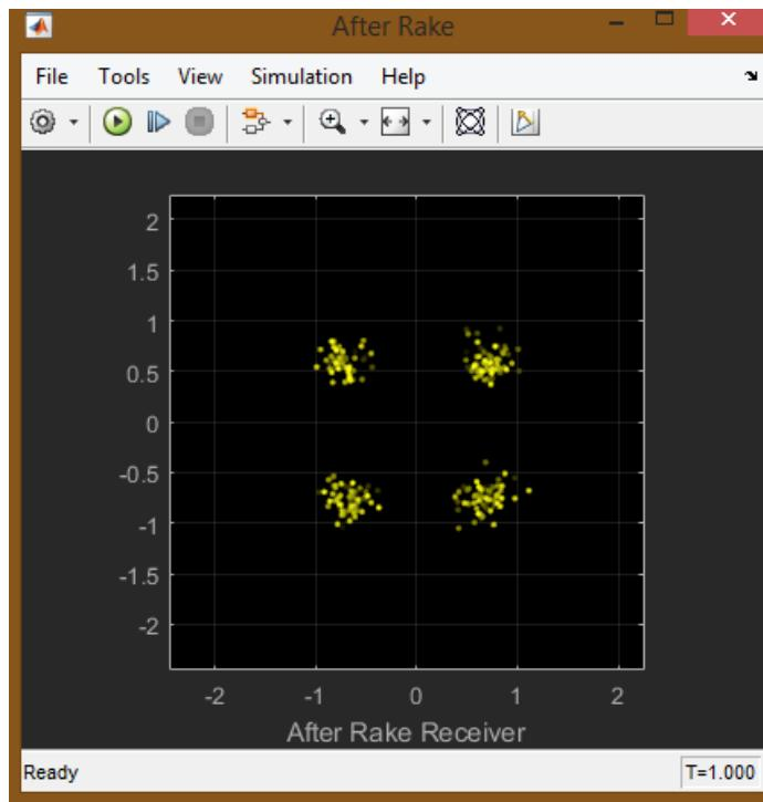
Рис. 7.35. Сигнал, декодированный мобильной станцией, на I-Q диаграмме.
