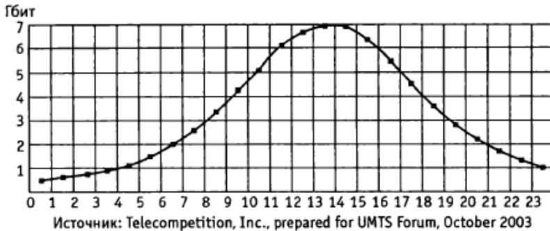
Рис. 1.5. Суточное распределение трафика мобильного доступа к Intranet/Extranet
