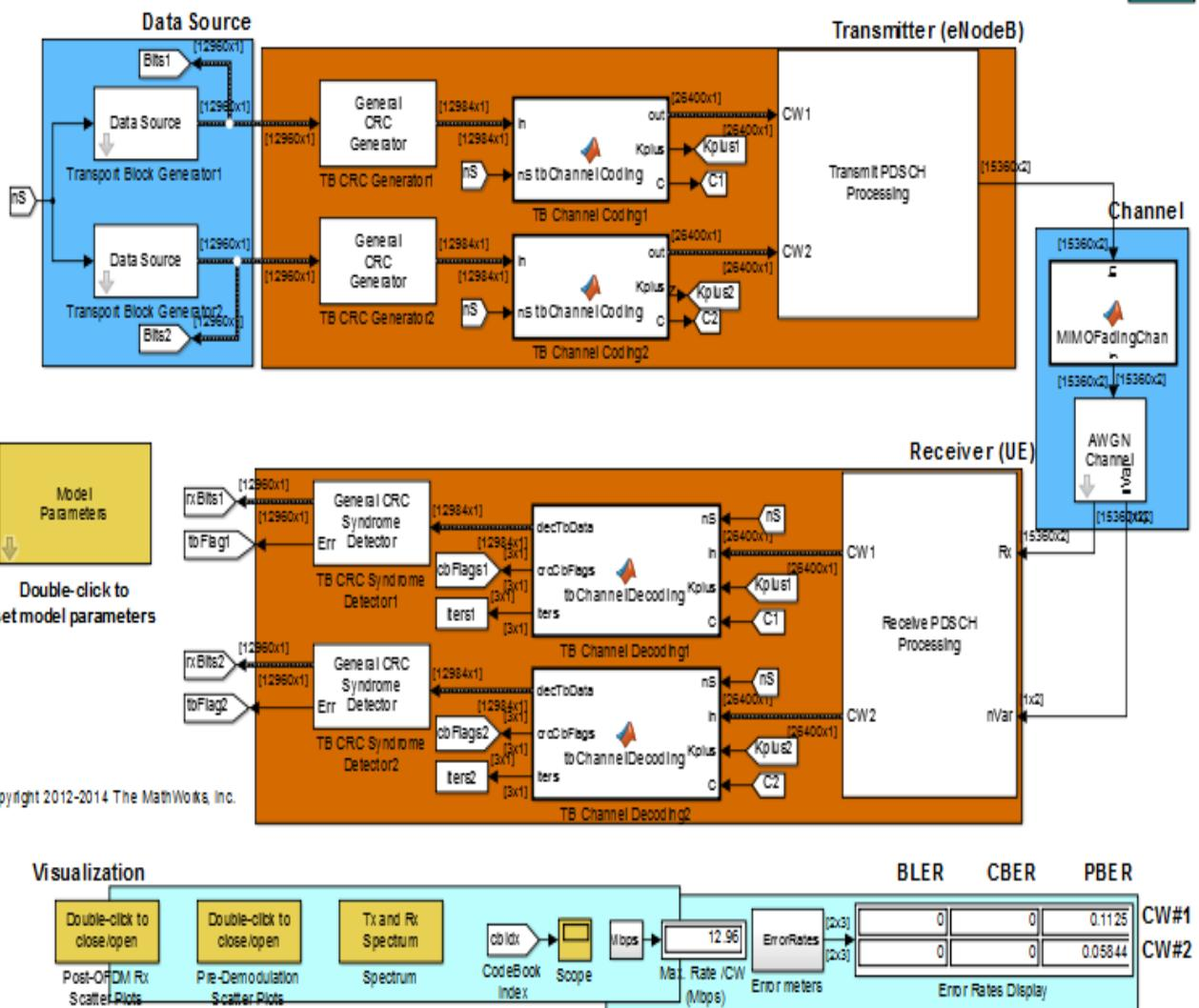
Рис. 7.157. Схема канала Downlink
