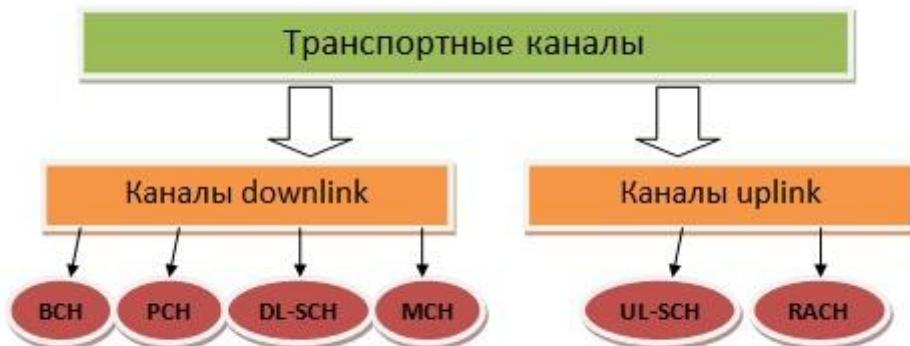
Рис. 7.125. Транспортные каналы LTE
