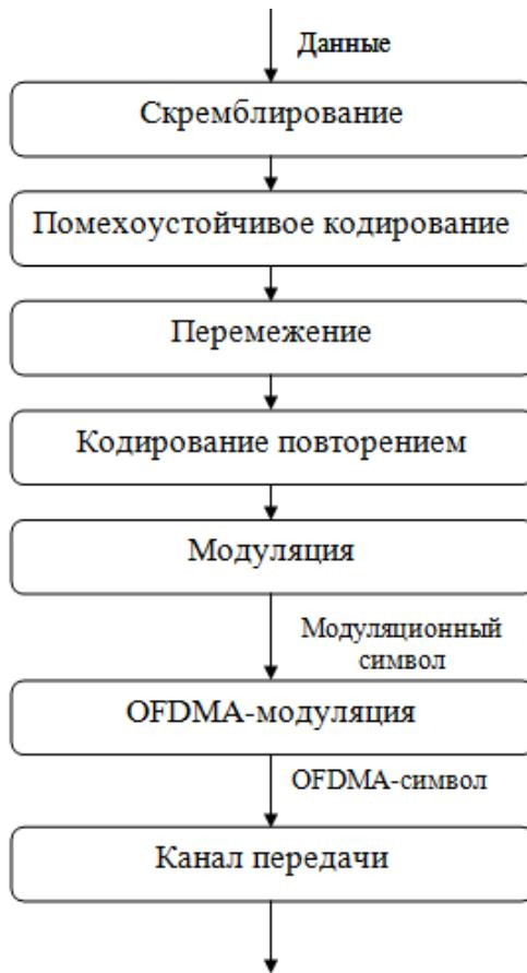
Рисунок 7.70 – Преобразования данных на физическом уровне WiMAX
