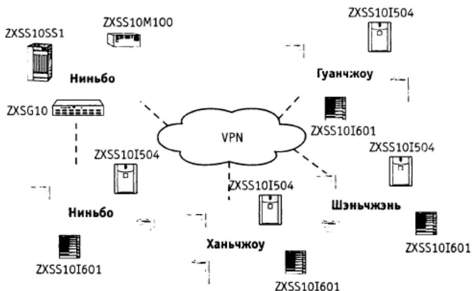
Рис. 5.18. Взаимодействие широкополосных речевых услуг, предоставляемых системой Softswitch от ZTE, в нескольких городских сетях
