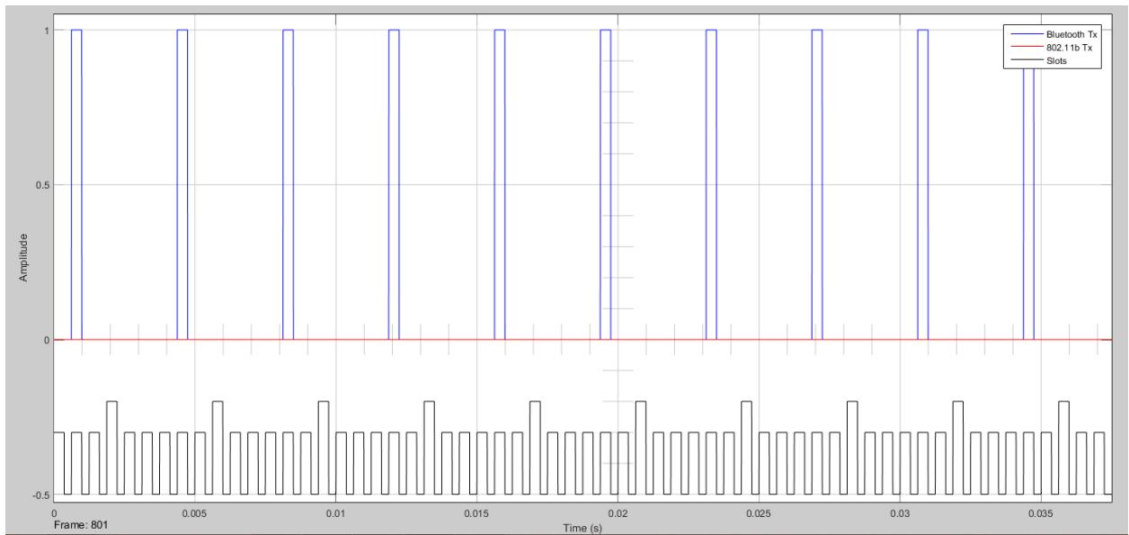
Рис. 7.62. Временная диаграмма Bluetooth без мешающего сигнала 802.11
