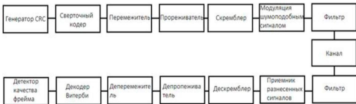
Рис. 7.18. Структурная схема CDMA
