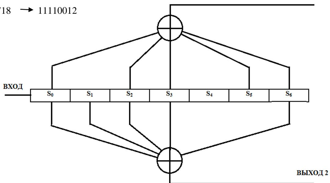
Рис. 8.4. Функциональная схема сверточного кодера 133,171
