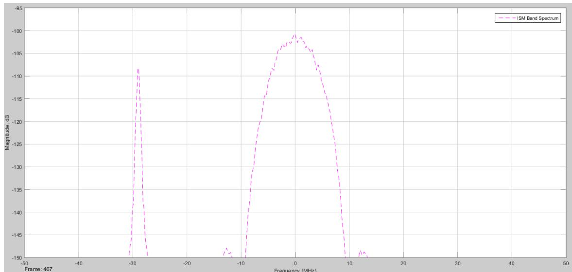
Рис. 7.64. Спектр Bluetooth с мешающим сигналом 802.11
