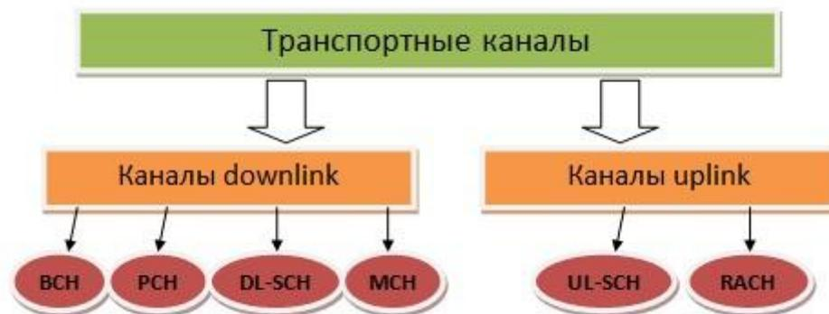
Рис. 7.125. Транспортные каналы LTE
