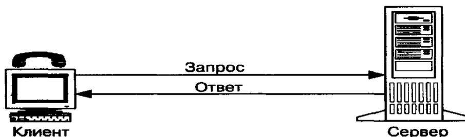
Рис. 6.6. Архитектура "клиент-сервер"
