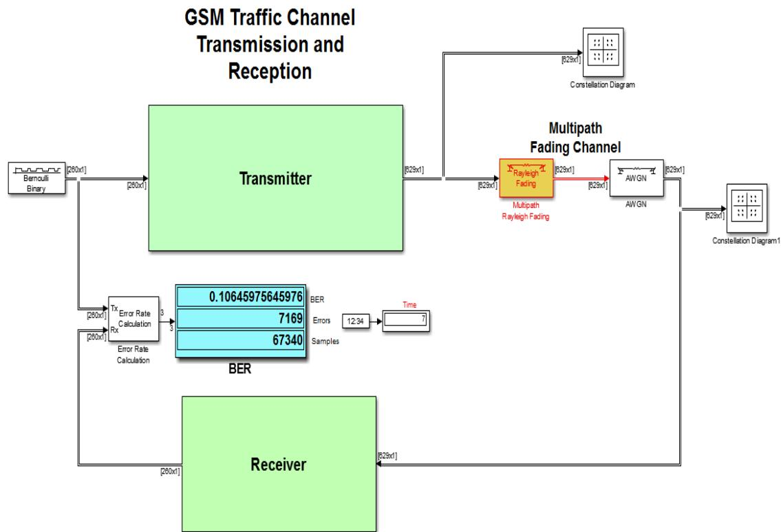
Рис. 7.2. Модель GSM в Simulink MATLAB 2015
