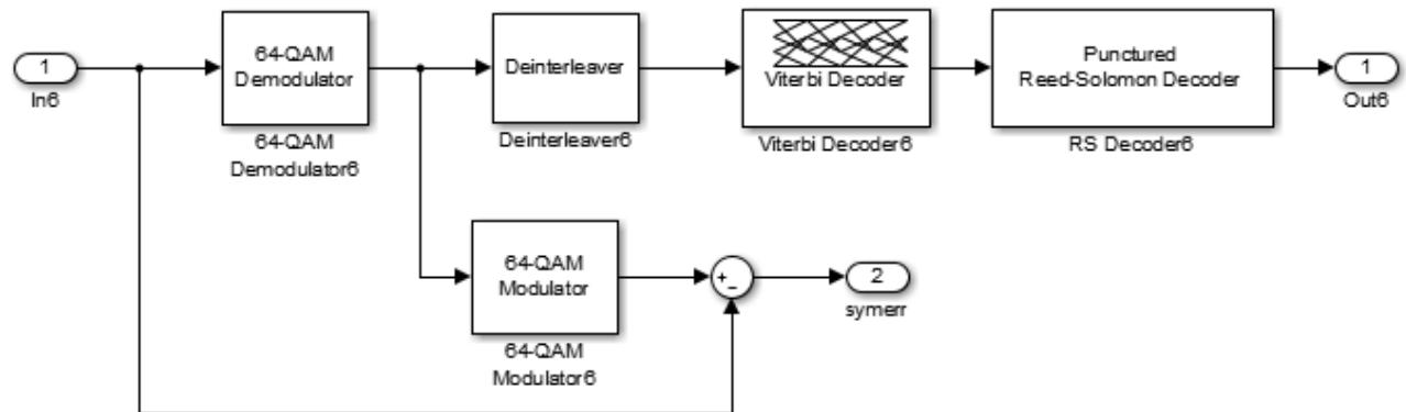
Рисунок 7.98 – Состав блока демодулятора «64QAM 3/4»
