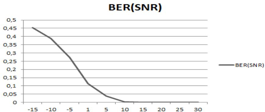
Рис. 7.155. Зависимость битовой вероятности ошибки от отношения сигнал/шум для второго потока
