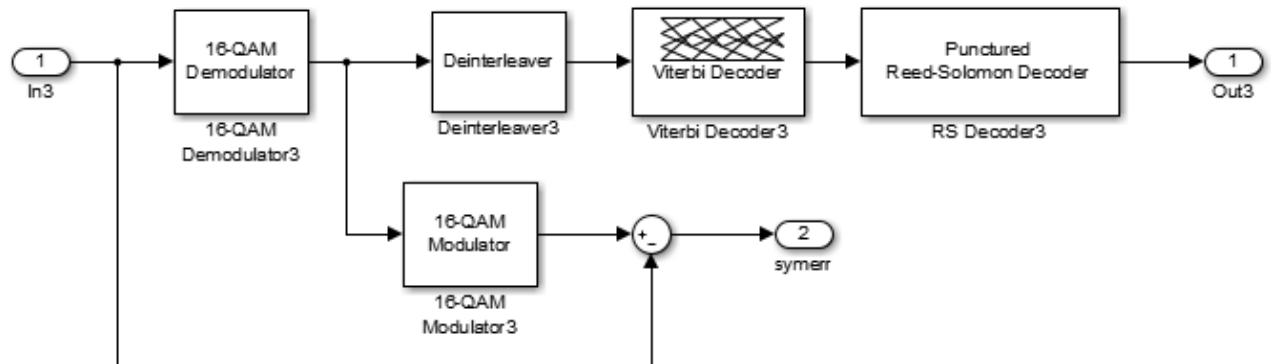
Рисунок 7.95 – Состав блока демодулятора «16QAM 1/2»
