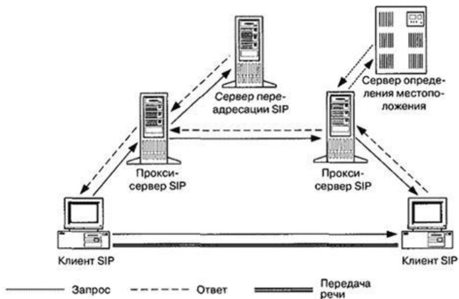
Рис. 6.7. Архитектура сети на базе протокола SIP
