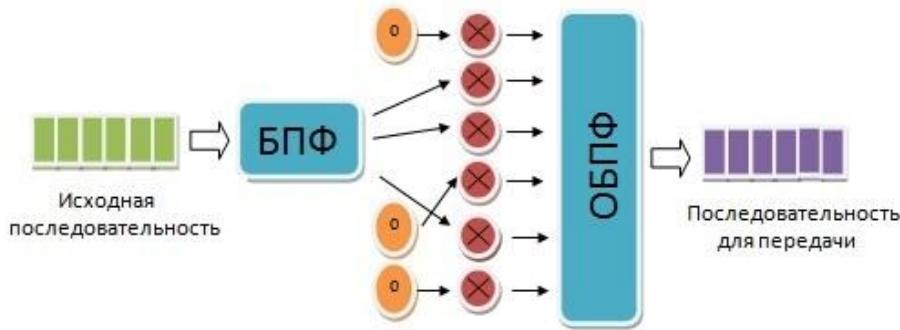
Рис. 7.123 - SC-FDMA – модулятор
