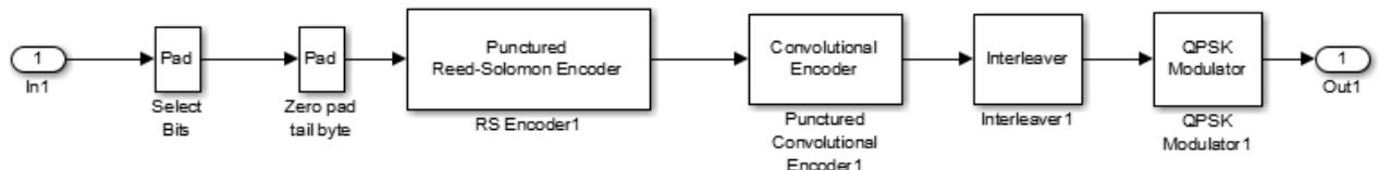
Рисунок 7.80 – Состав блока модулятора «QPSK 1/2»
