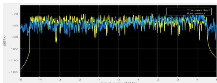
Рис. 7.145. Спектр входного (желтым) и выходного (синим) сигналов
