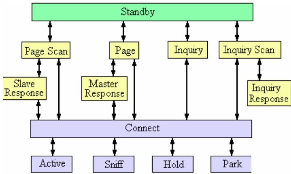
Рис. 7.60. Состояние соединений
