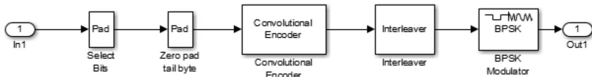
Рисунок 7.79 – Состав блока модулятора «BPSK 1/2»
