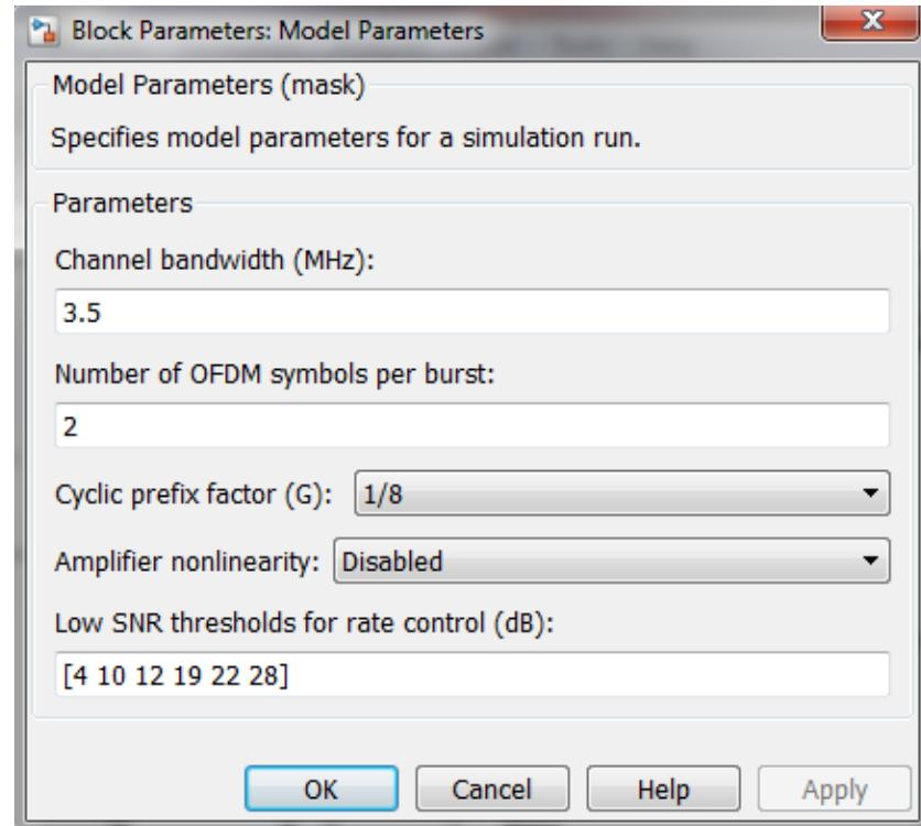
Рисунок 7.77 – Параметры системы, изменяемые в блоке «Model Parameters»
