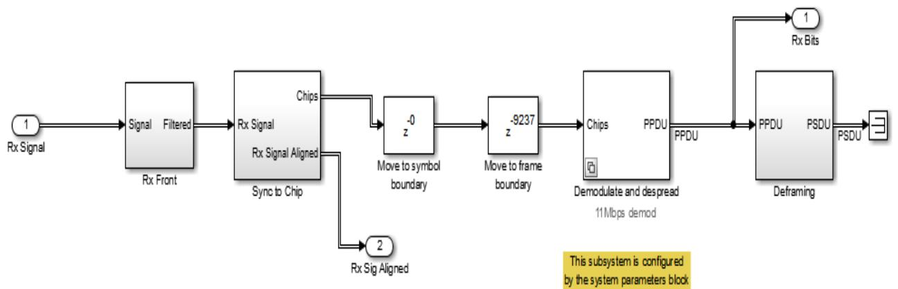
Рис. 7.60. Структурная схема приемника IEEE 802.11b
