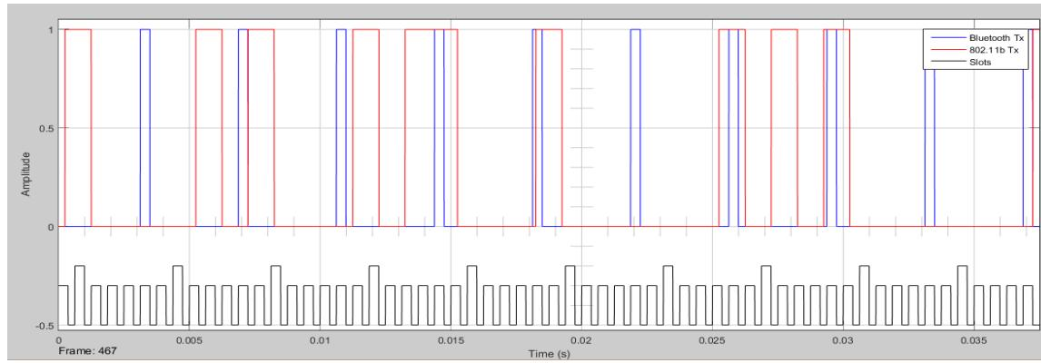
Рис. 7.65. Временная диаграмма Bluetooth с мешающим сигналом 802.11
