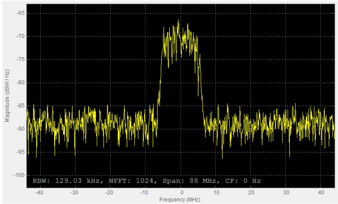
Рис. 7.62. Частотная характеристика для скорости передачи 11 Мбит/с
