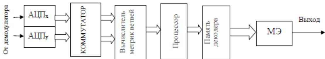
Рис. 8.10. Структурная схема декодера Витерби
