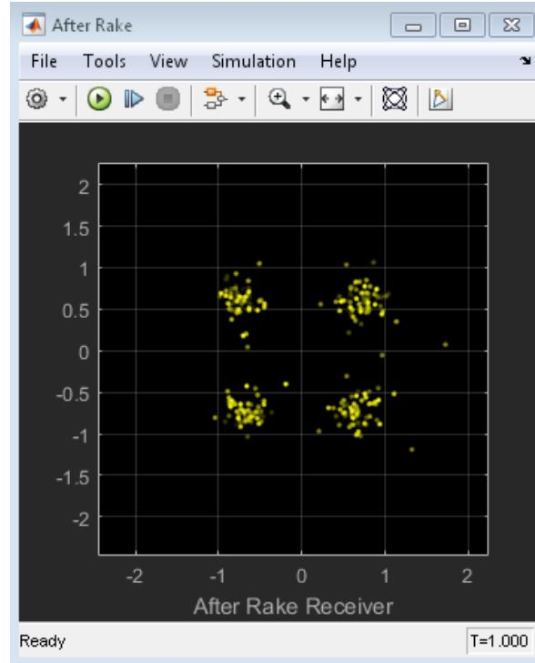
Рис. 7.29. Сигнал, декодированный мобильной станцией, на I-Q диаграмме.
