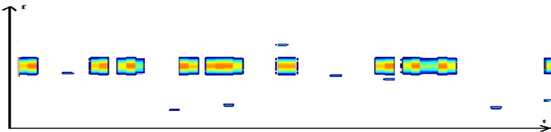
Рис. 7.66. Пример скачков частоты Bluetooth во времени с мешающим сигналом 802.11
