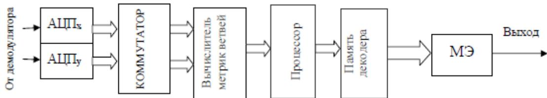
Рис. 8.5. Структурная схема декодера Витерби
