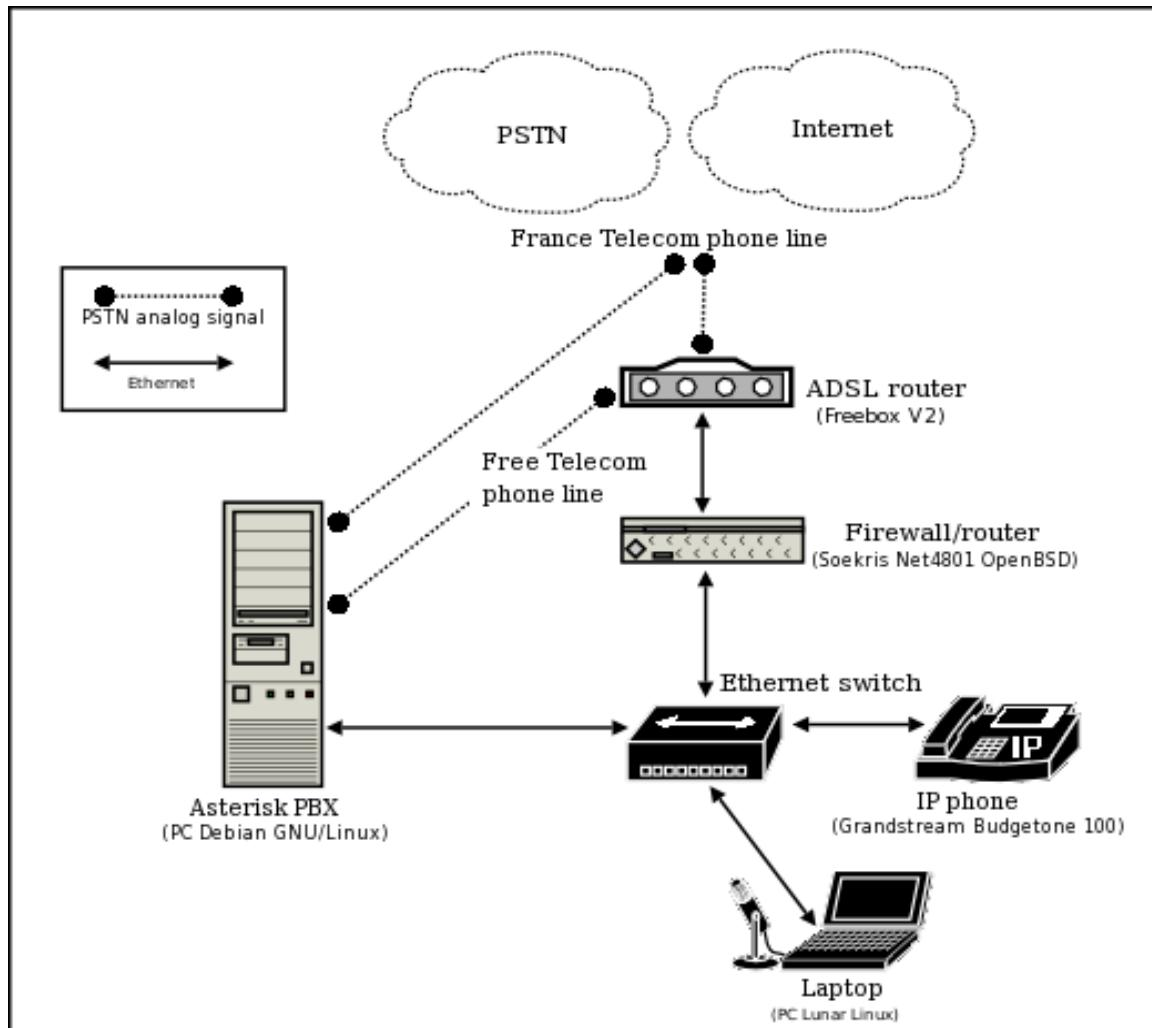
Рис. 6.11. Структурная схема сетевого решения на базе Asterisk
