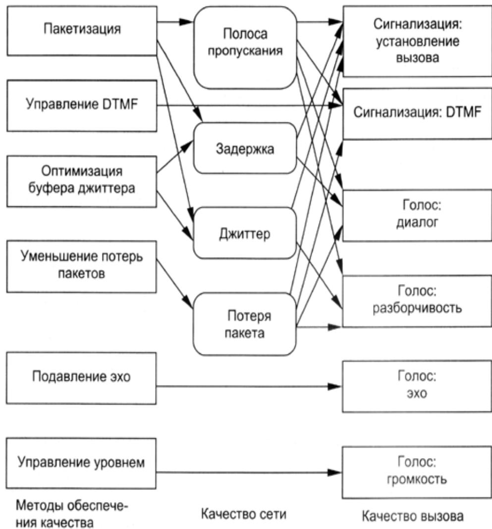
Рис. 6.9. Схема обеспечения качества IP-телефонии
