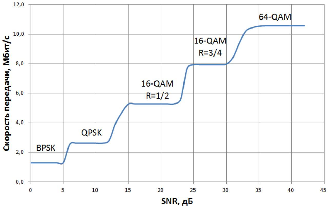
Рисунок 7.116 – График зависимости скорости передачи от SNR
