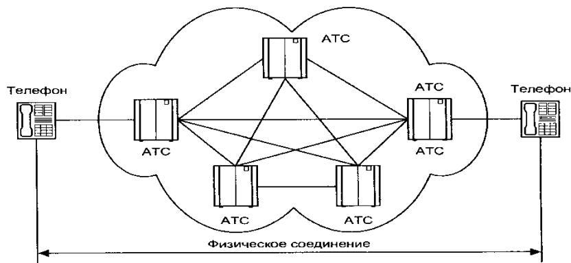
Рис. 6.1. Соединение в «классической» телефонной сети
