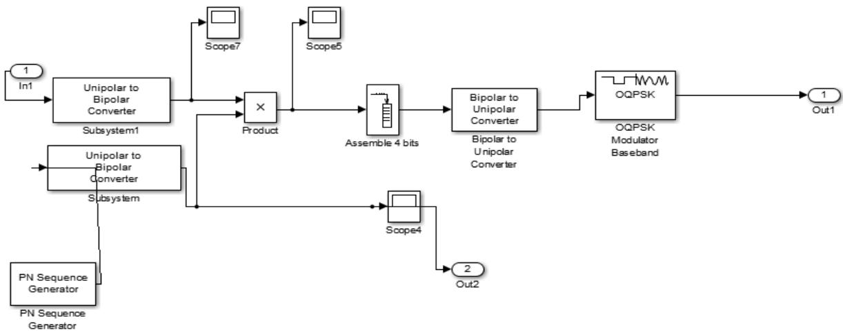
Рис. 7.71. Схема ZigBeeTransmitter
