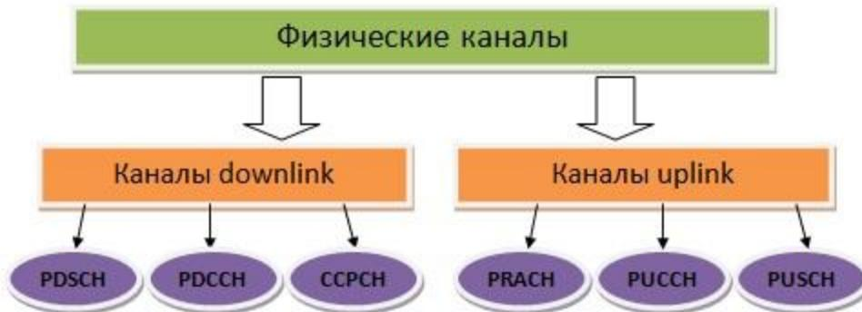
Рис. 7.127. Физические каналы LTE
