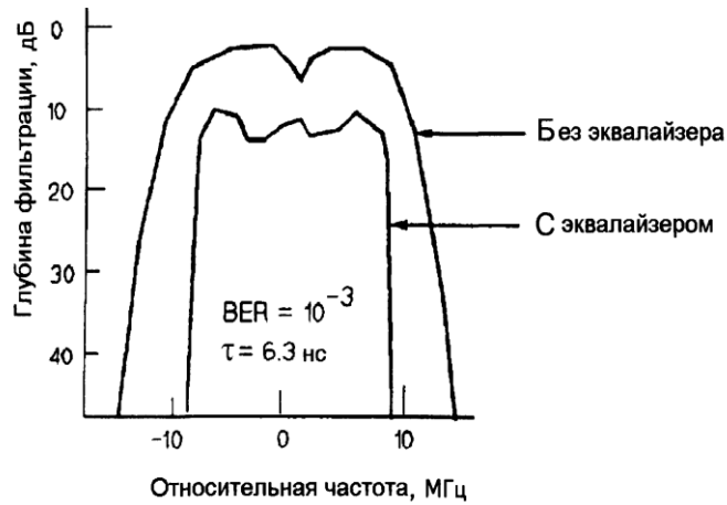
Рис. 2.27. Кривая М канала с эквалайзером и без эквалайзера
