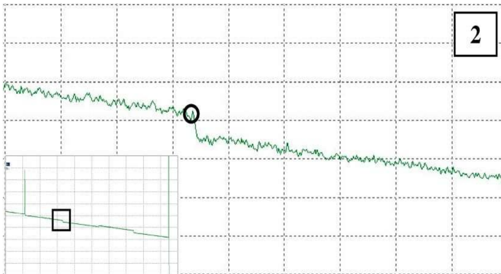
Рис. 4.21. Неоднородность с отражением (механический соединитель)
