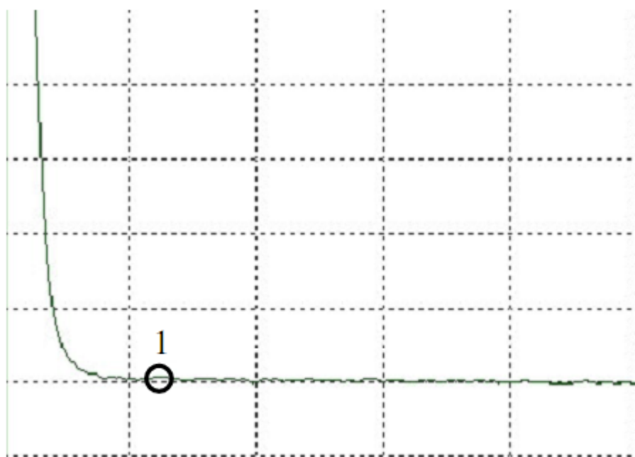
Рис. 4.48. Мертвая зона на ближнем конце
