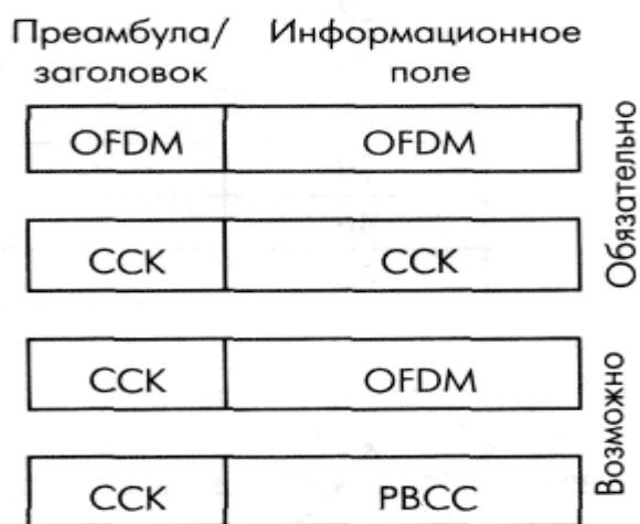
Рис. 7.56. Кадры IEEE 802.11g в различных режимах модуляции
