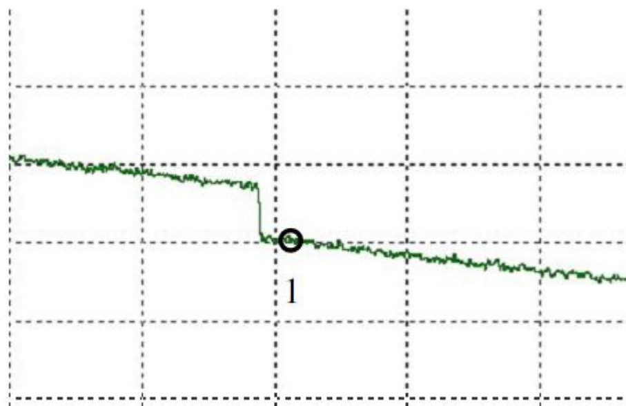
Рис. 4.50. Мертвая зона относительно неоднородности без отражения
