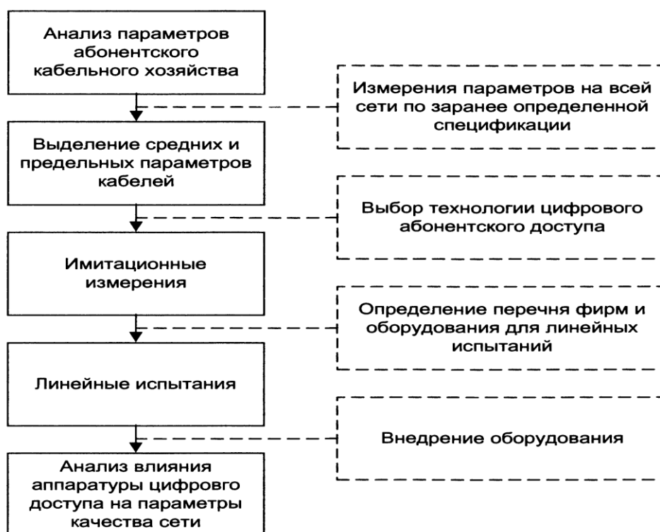
Рис. 3.15. Схема последовательности измерений при выборе и внедрении оборудования "последней мили"
