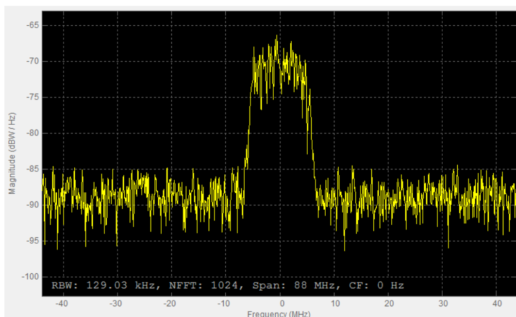
Рис. 7.62. Частотная характеристика для скорости передачи 11 Мбит/с
