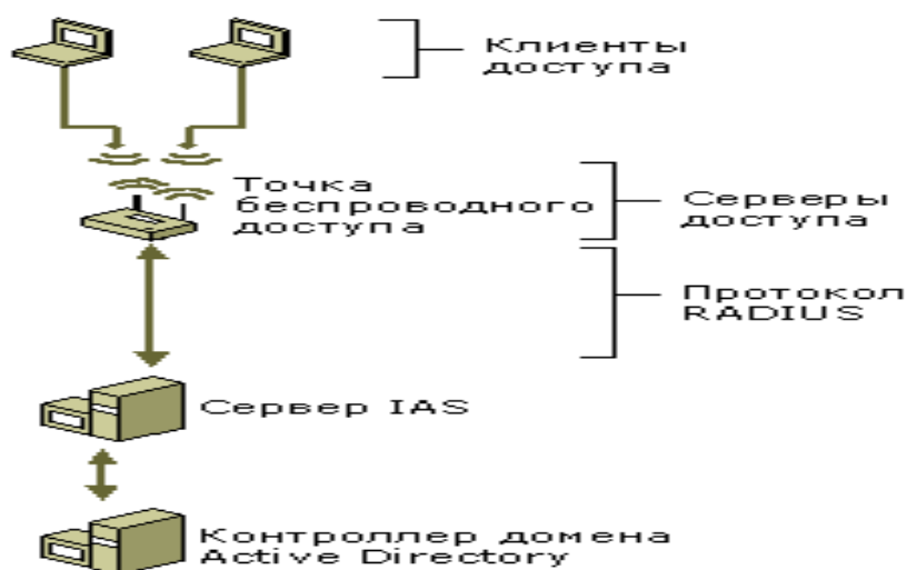
Рис. 39. Использование IAS в качестве RADIUS-сервера
