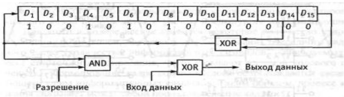
Рис. 10.4. Структурная схема устройства рандомизации данных
