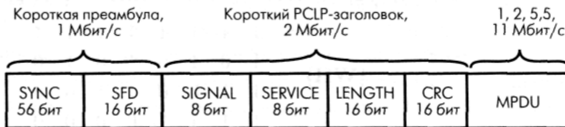
Рис. 5.5. Короткий заголовок кадров сети 802.11b
