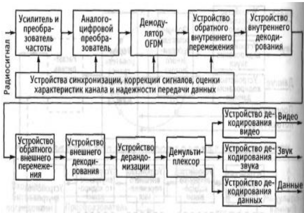
Рис. 10.2. Структурная схема приемника системы DVB-T
