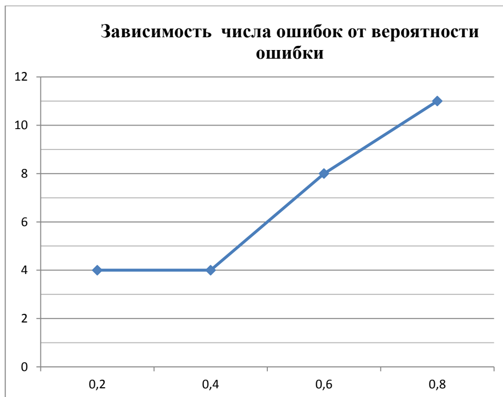
Рис. 3.23. График зависимости числа ошибок (ОУ) от вероятности ошибки (ОХ) для кода Хэмминга (15,11)
