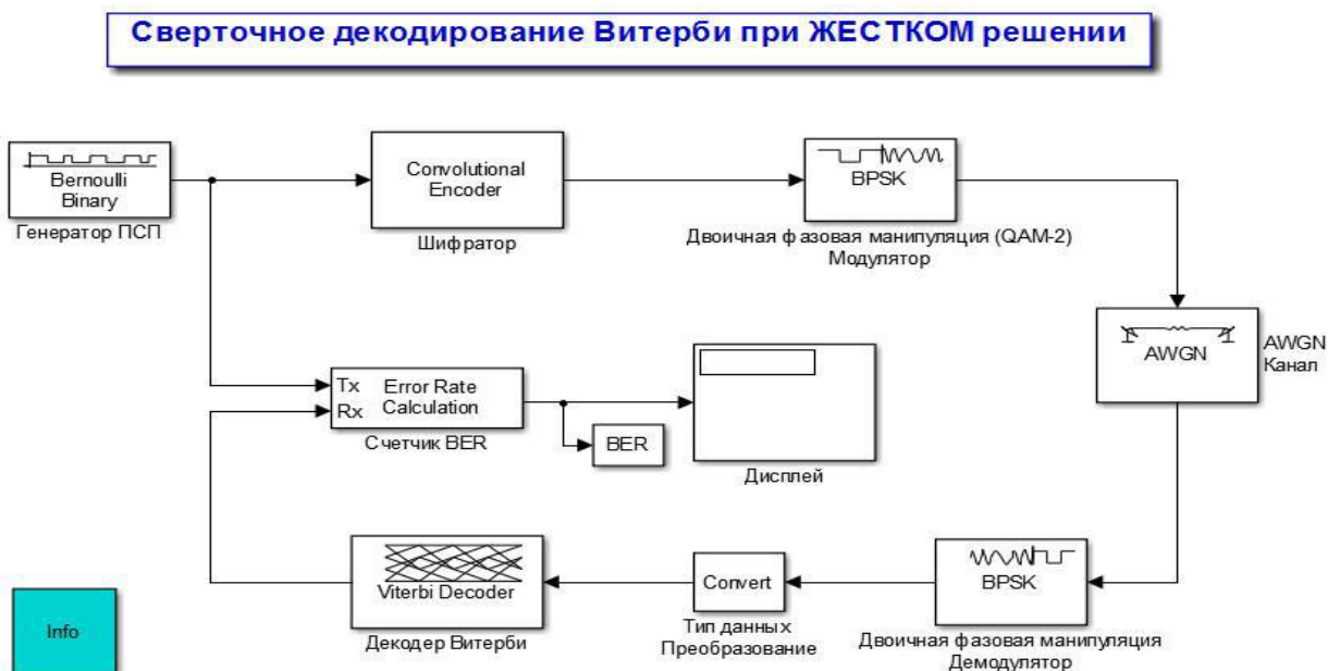
Рисунок 3.100 - Модель сверточного декодера Витерби при жестком решении
