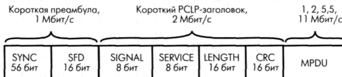
Рис. 3.50. Короткий заголовок кадров сети 802.11b
