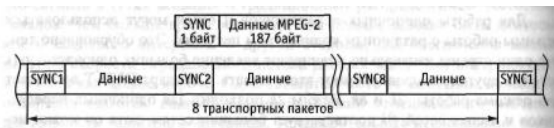
Рис. 4.3. Адаптация транспортных пакетов в системе MPEG-2
