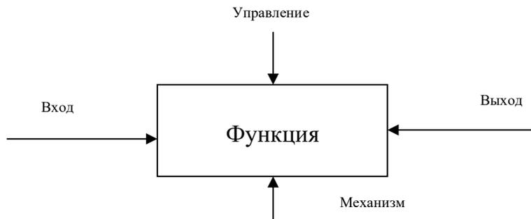
Рис 3.4 – Функциональный блок и интерфейсные дуги
