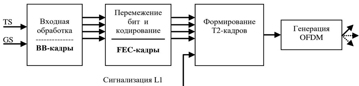
Рис. 6. Структура передающей части DVB-T2
