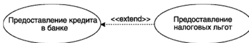
**Рис. 3.8.** Пример графического изображения отношения расширения между вариантами использования
