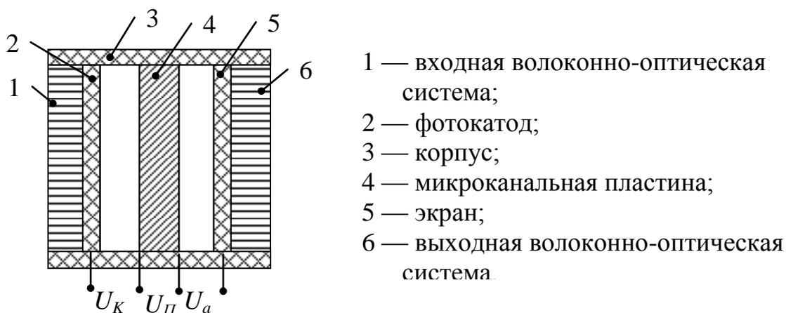
Рисунок 9.3 Устройство электронно-оптического преобразователя с микроканальной пластиной.
