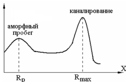
Рисунок 8.2.1 – Распределение ионов по глубине при наличии каналирования
