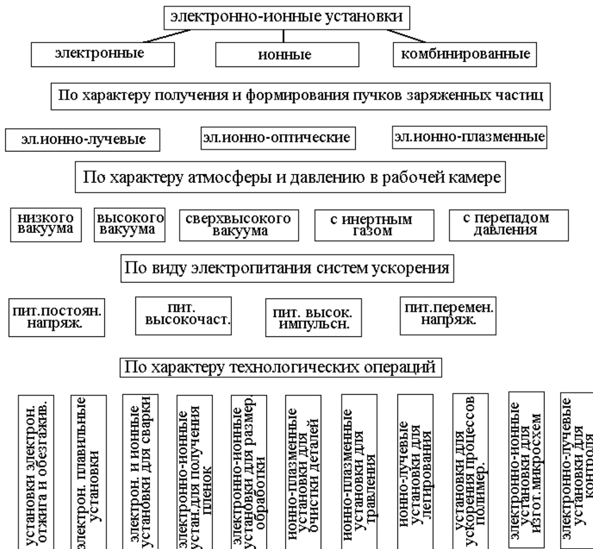
Рисунок 12.1.1 – Связь между назначением и параметрами электронно-лучевых установок
