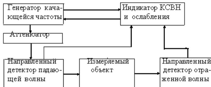
Рисунок 1.2 – Схема измерения ослабления панорамным измерителем КСВ и ослабления
