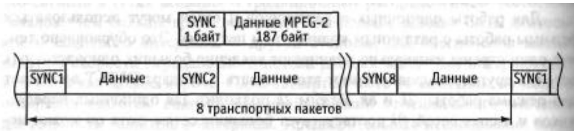
Рис. 5.136. Адаптация транспортных пакетов в системе MPEG-2
