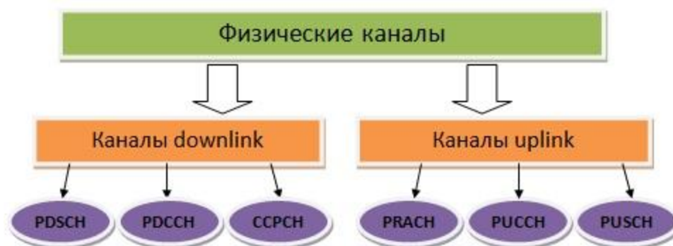
Рис. 5.104. Физические каналы LTE
