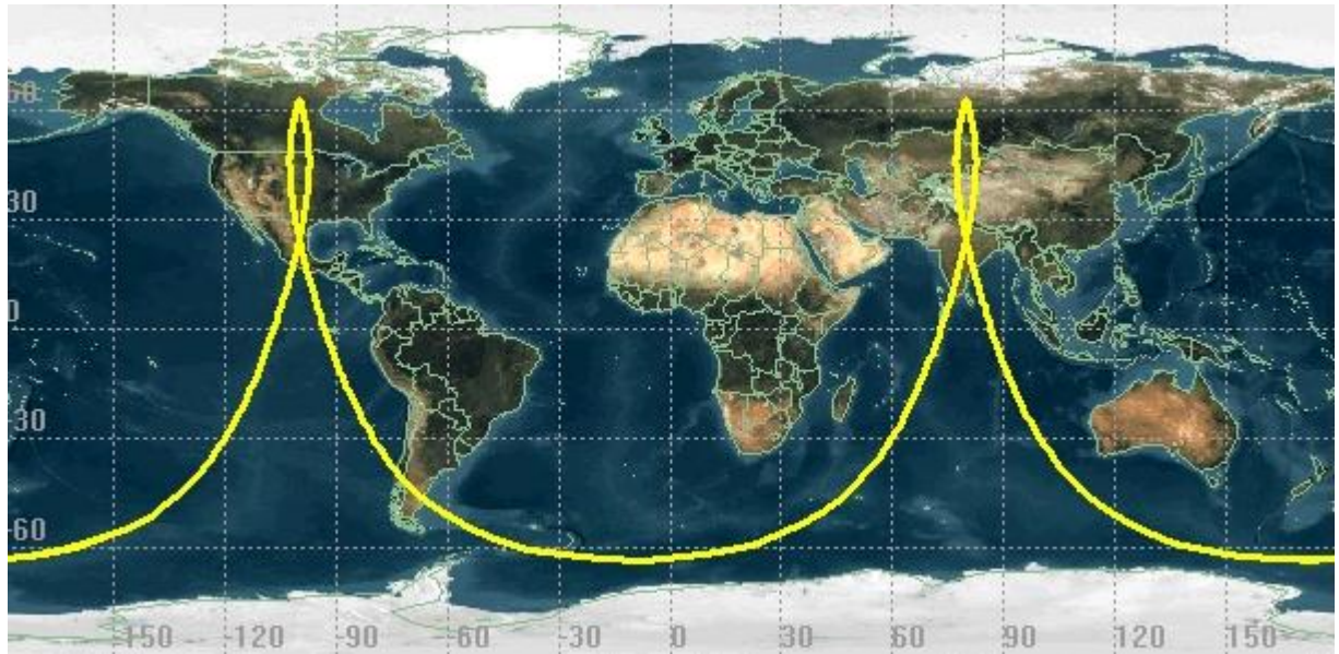
Рис. 4.26. Трасса орбиты типа «Молния»
