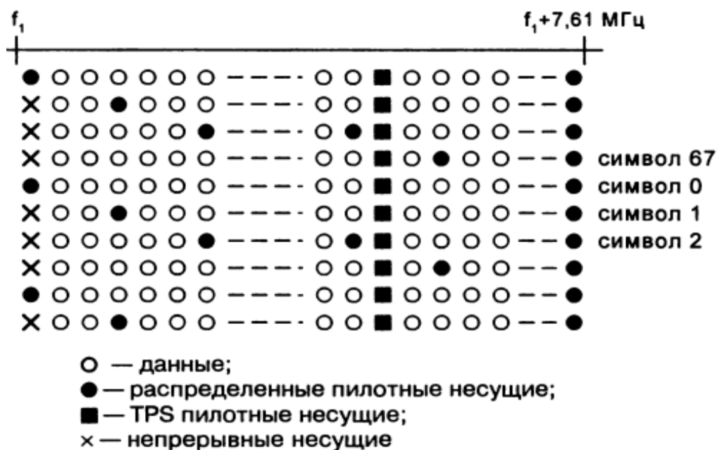
Рис. 5.146. Структурная схема формирователя OFDM-символа в системе DVB-T
