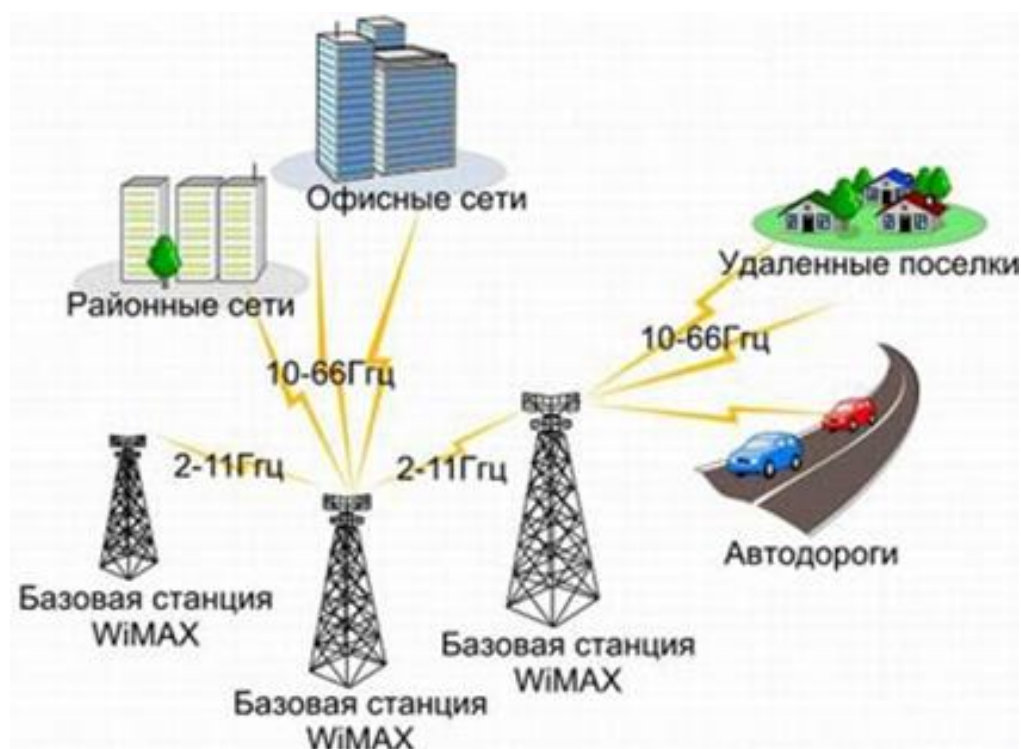
Рис. 5.4 – Схематичное изображение сети WiMAX
