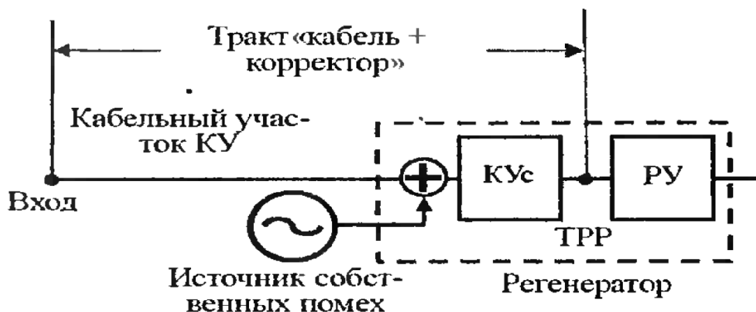
Рис. 3.1. Структурная схема участка регенерации
