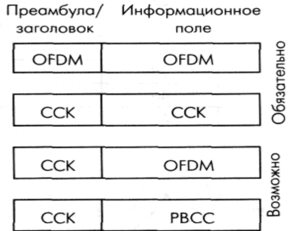
Рис. 5.56. Кадры IEEE 802.11g в различных режимах модуляции
