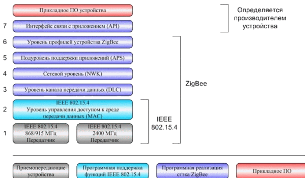
Рис. 5.68. Многоуровневая модель стандарта связи ZigBee
