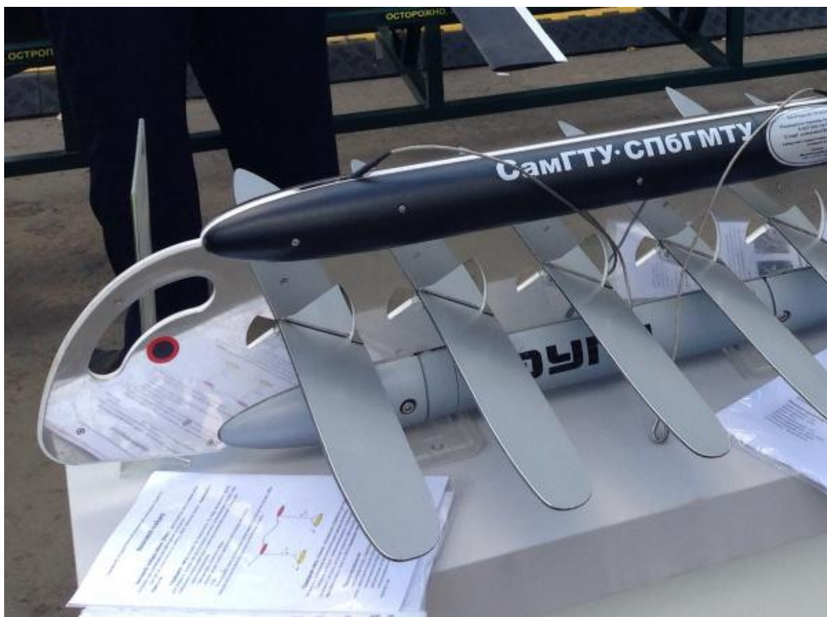
Подводный модуль опытного образца отечественного волнового глайдера СамГТУ-СПбГМТУ / "Океанос НПО", ЗАО
