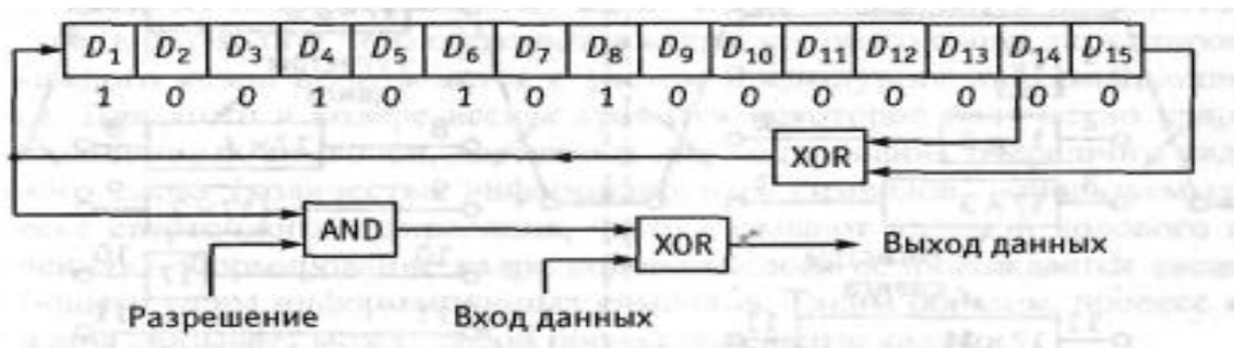
Рис. 5.137. Структурная схема устройства рандомизации данных
