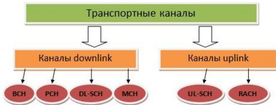
Рис. 5.102. Транспортные каналы LTE
