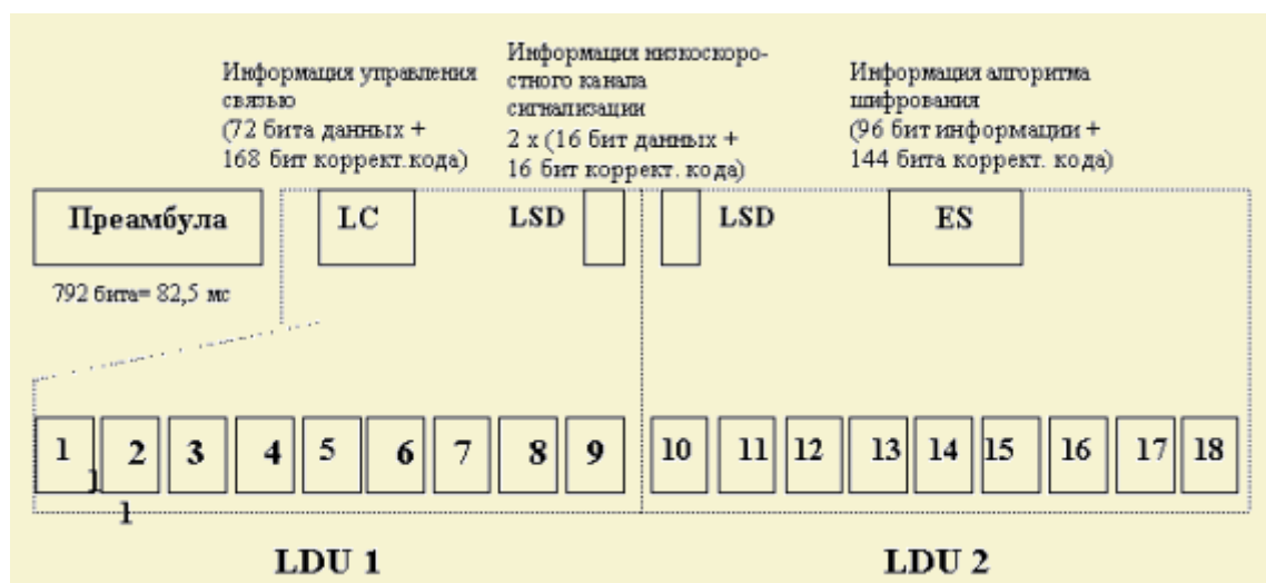
Рис. 3.34. Структура речевого суперкадра в стандарте APCO 25
