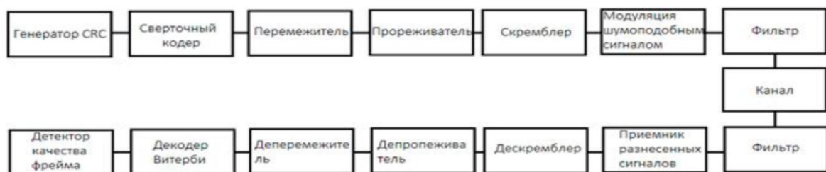
Рис. 5.18. Структурная схема CDMA
