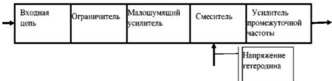
Рис. 5.7. Структурная схема СВЧ модуля многоцелевого назначения.
