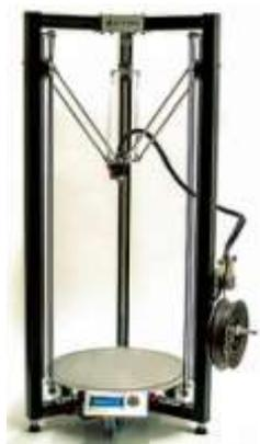
Рисунок 1.9 – 3D принтер для послойного наращивания
