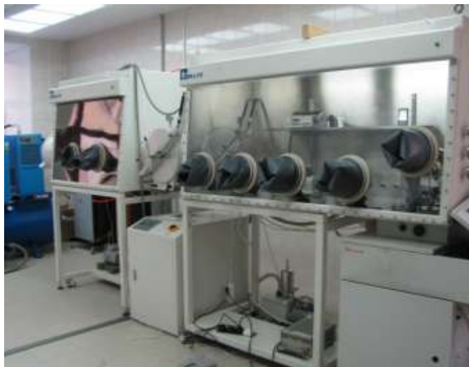
Рис. 3.2 – Технологическая линия для создания ОСИД в атмосфере сухого азота
