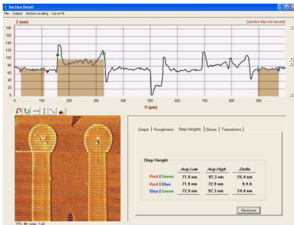
Рис. 3.10 – Профилограмма пленок одиночных линий PF8 (модифицированный раствор)
