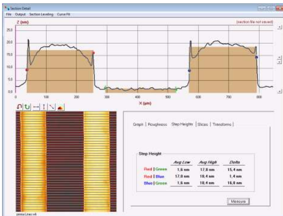
Рис. 3.11 – Профилограмма пленок (линии), полученных печатью раствором РММА
