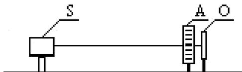
**Рис. 1.** Формирование периодических фазовых структур. S-светодиод, А-амплитудная маска, О-исследуемый образец.
