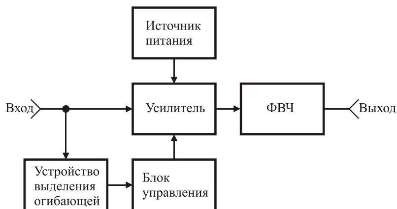
Рис. 1.5. Схема усилителя с АРТ, в котором управление положением рабочей точки осуществляется с помощью огибающей входного сигнала
