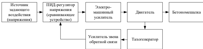
Рисунок 3.1 – Структурно-функциональная схема устройства «Бетономешалка на электроприводе»
