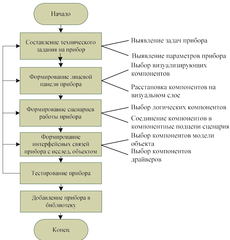
Рисунок 8.2 – Последовательность действий пользователя по формированию виртуального прибора
