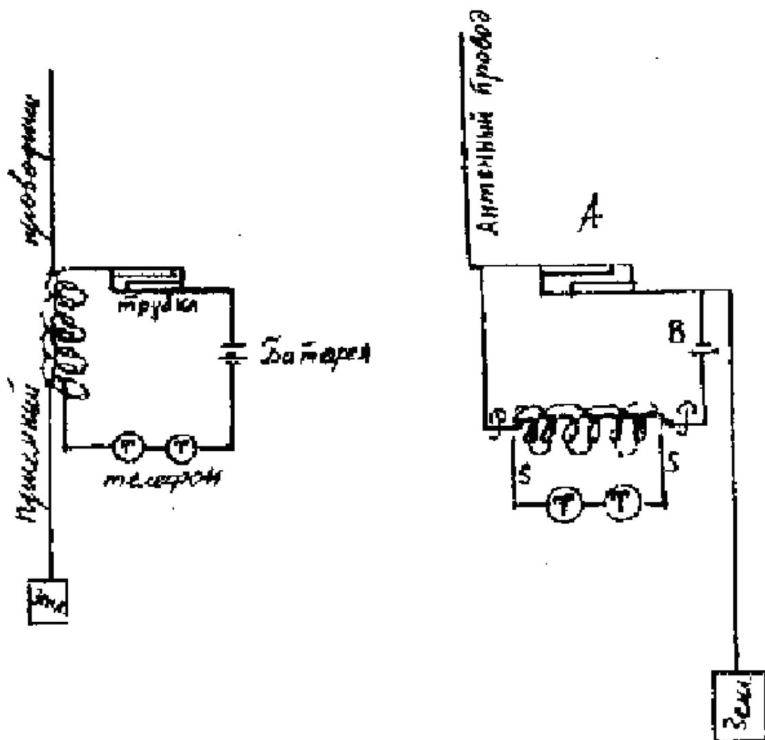
Принципиальные схемы детекторных приемников, разработанных А.С. Поповым.
