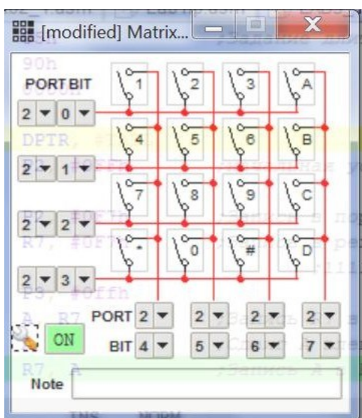
Рис. 4 Подключение матричной клавиатуры к МК
