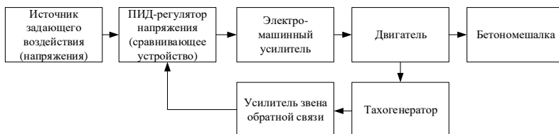
Рисунок 3.1 – Структурно-функциональная схема устройства «Бетономешалка на электроприводе»
