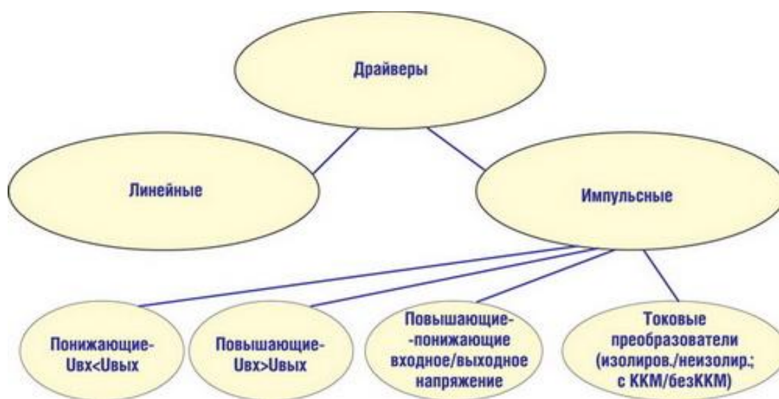
Рисунок 9.1 – Классификация драйверов в интегральном исполнении Линейные стабилизаторы используются при значениях тока нагрузки до 5 А
